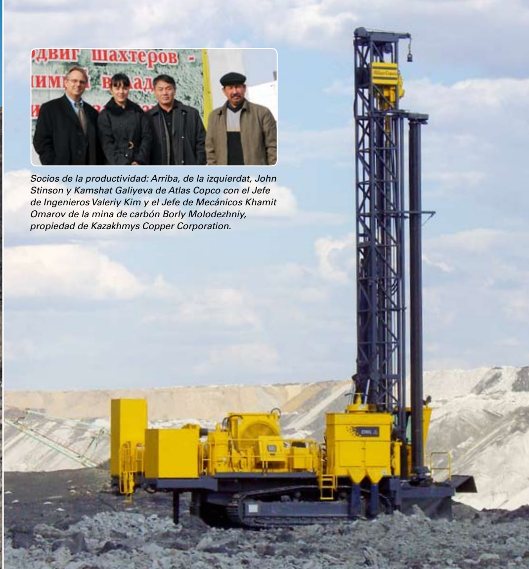
En la Mina de Carbón Borly, los equipos Atlas Copco modelo DML y DM45 trabajan en bancos de 45 m. Arriba, el nuevo equipo eléctrico DML con propulsión hidráulica en cabeza.
