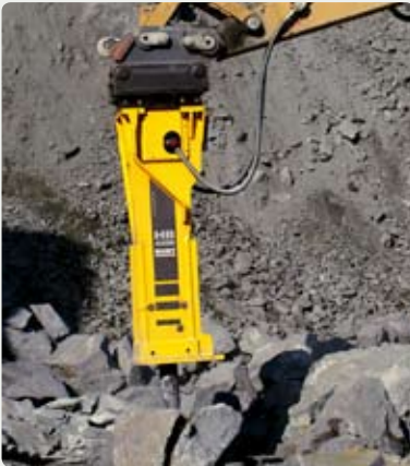
Rompiendo bien: La rompedora hidráulica HB 4200 en acción. Montada en una excavadora hidráulica Cat 345, la rompedora se usa tanto para partir rocas demasiado grandes como para eliminar atascos de roca en la trituradora.
