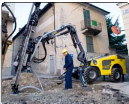
Debut en Bauma: El nuevo ROC T20, para aplicaciones en la construcción, perforando barrenos para diámetros de 38–64 mm.
