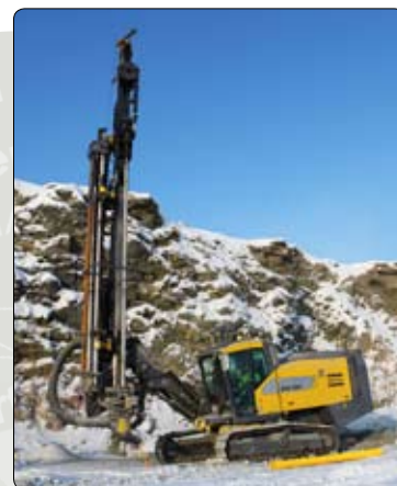
Combinación potente: El SmartRig ROC D65 ofrece perforación DTH con funciones de SmartRig.
