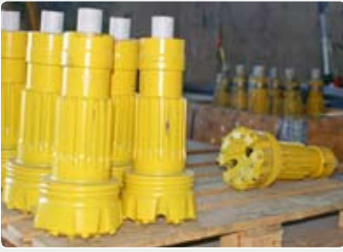
En el taller de afilado de roca: Brocas nuevas de botones Secoroc y, al fondo, brocas gastadas esperando para ser reafiladas con la afiladora Secoroc GrindMatic.
