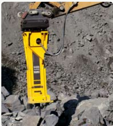
良好的破碎：HB 4200 液压破碎锤在工作。安装在卡特 345 液压挖掘机上的这款破碎锤用于破碎爆破后的大块岩石或清理碎石机内卡住的岩石。
