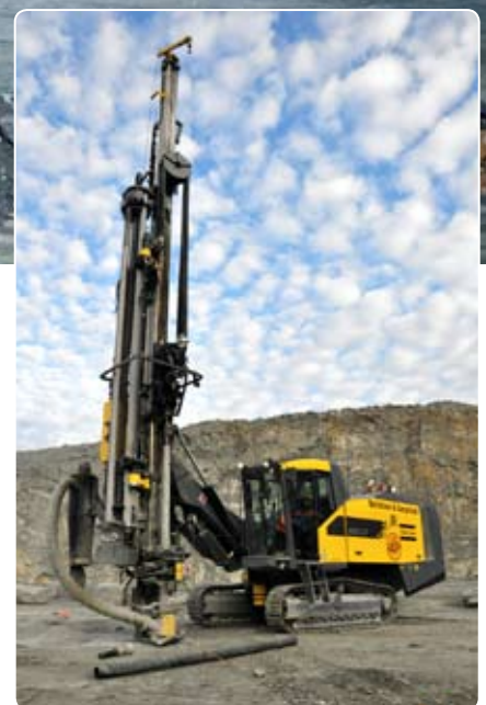
令人印象深刻的性能：配备 COPROD 钻孔系统的 ROC L7 40 CR 以其在采石场穿过高强度的覆盖层钻出直的清洁孔的能力给操作员留下深刻印象。
