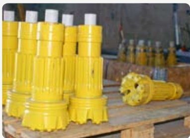
在修磨车间：新的赛柯洛克球齿钻头和后面等待用赛柯洛克 GrindMatic 修磨机修磨的钻头。
