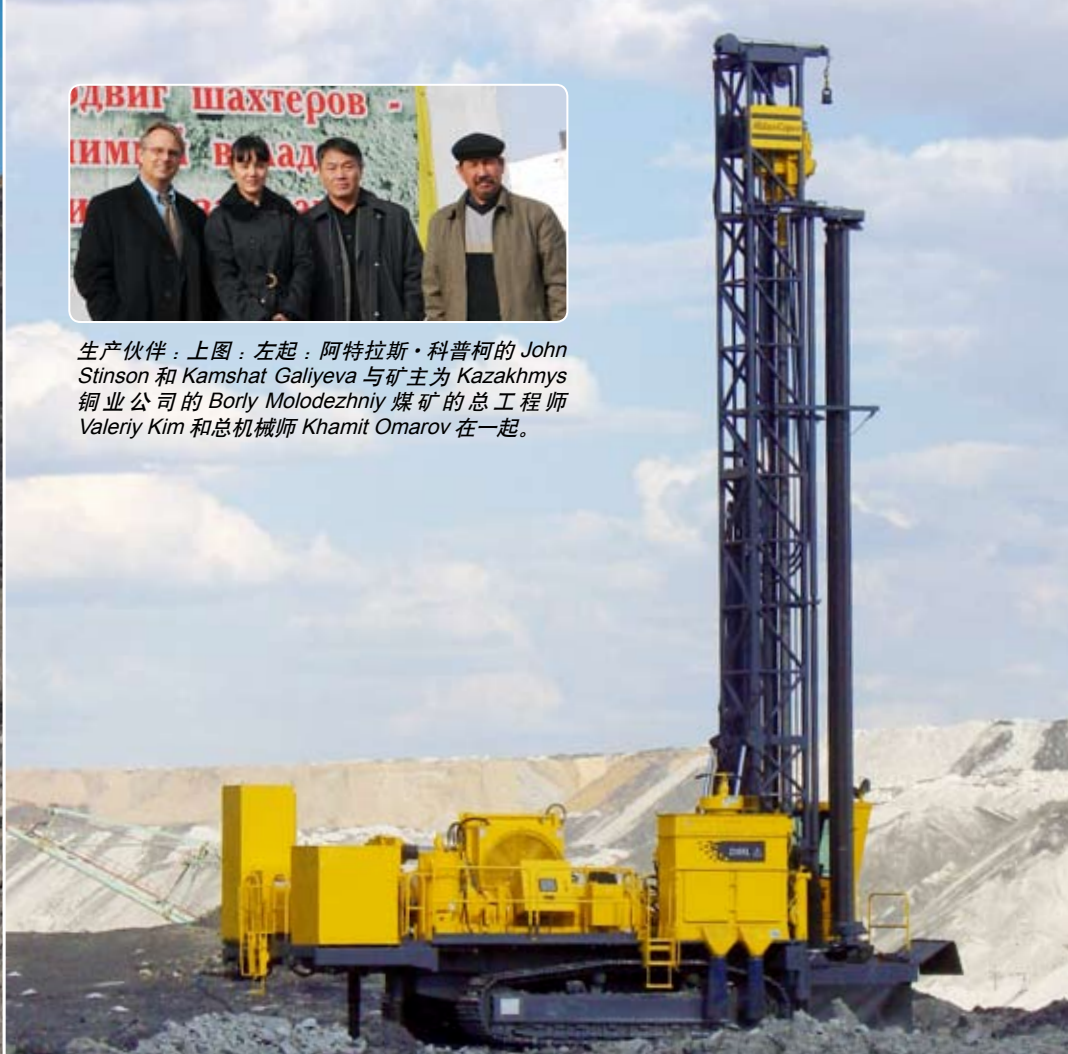
在 Borly 煤矿，阿特拉斯·科普柯 DML 和 DM45 钻机在 45 m 高的台阶上工作。上图：新的带液压驱动回转头电动 DML 钻机。
