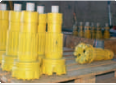
В цеху перезаточки коронок: новые штыревые коронки Secoroc, изношенные (сзади) ожидают обработки на станке Secoroc GrindMatic BQ2.
