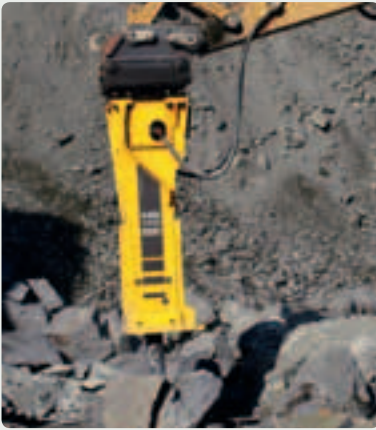
Разделка: гидромолот HB 4200 смонтирован на гидравлический экскаватор Cat 345 и используется для разделки взорванного негабарита и расчистки на входе дробилки.
