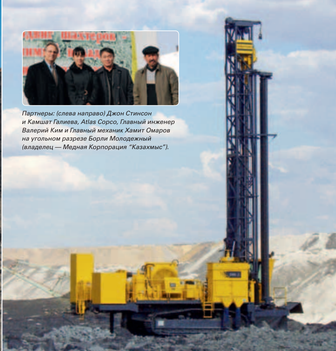
Станки Atlas Copco DML и DM 45 работают на 45-метровых уступах. Новый электроприводной DML с верхним гидроприводом.
