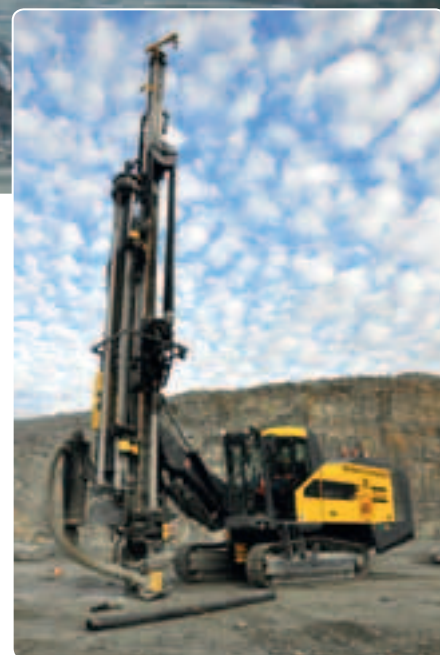
Впечатляющая работа: ROC L7 40 CR с системой COPROD поразил операторов карьера бурением прямых чистых скважин по сложной вскрыше.
