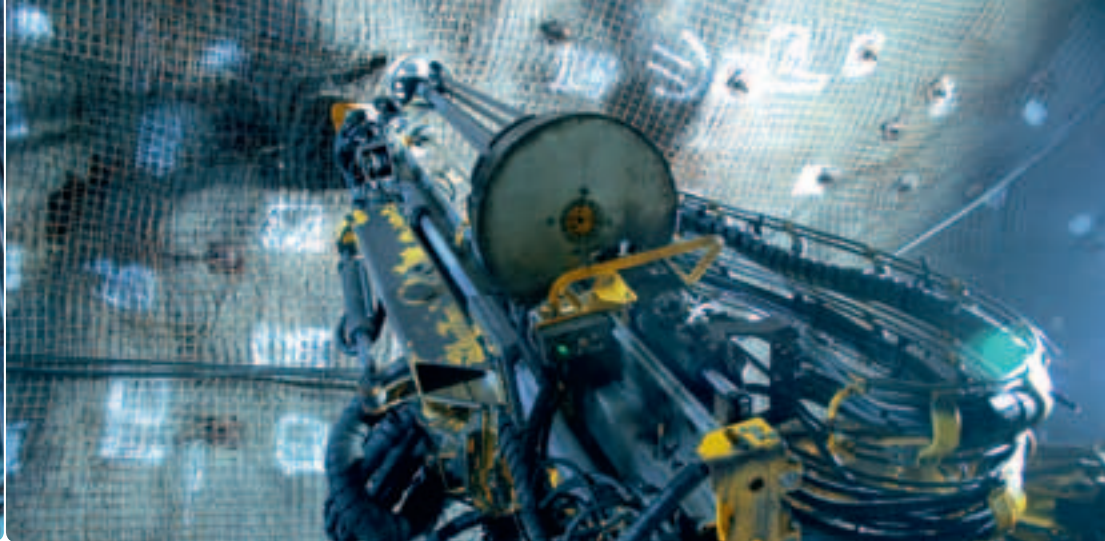
Сверху слева: 3-метровые анкеры Swellex готовы к установке. Далее: буровая стрела станка Voltec LC с каруселью на 10 болтов
