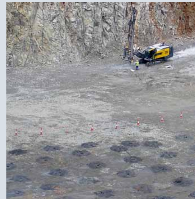
キスラダグのベンチ：アトラスコプコの掘削機とセコロックハンマーでプレスブリッティング、バッファ、生産用孔掘削を行った(写真の掘削機はROC L6)
