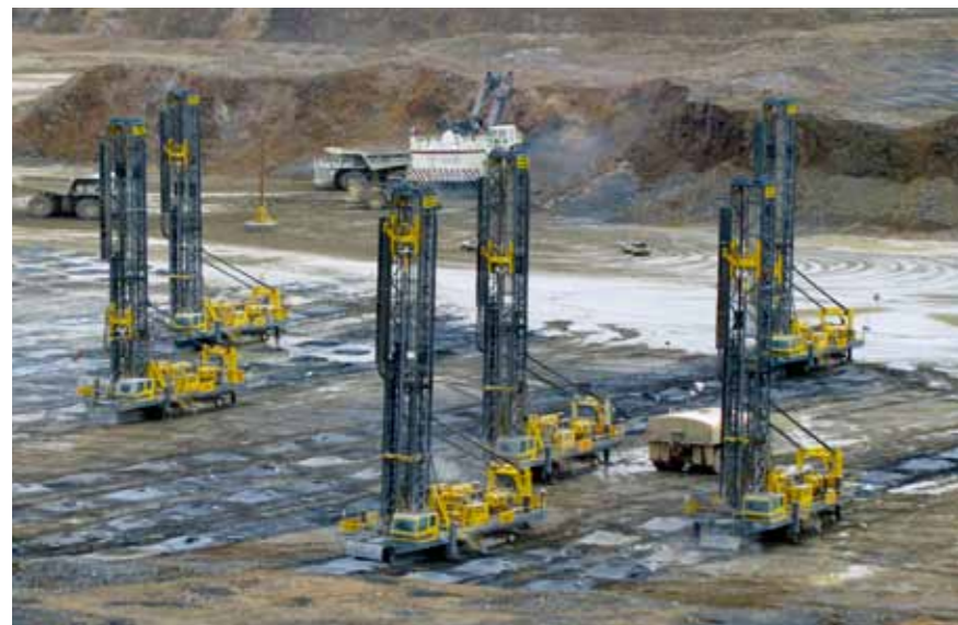
毎日 50 万トンの岩石を掘削・爆破。ペニャスキートで稼働する アトラスコプコの穿孔機 Pit Viper 351
