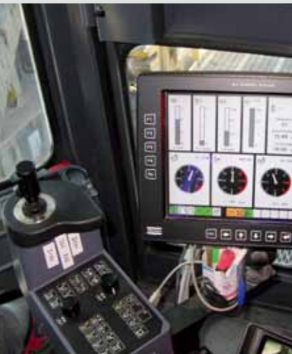
指先での操作: オペレータのパネルにある RCS 自動化機能ボタン
