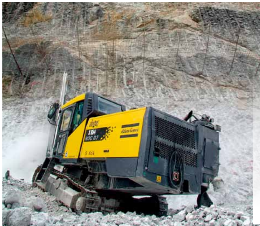
ベンチテスト: 装備を変更したROC D7は、掘削計画で指定されたベンチ幅40cm以下の要件を見事に上回りました
