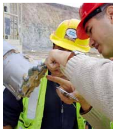
いい役者：セコロック QL60 ビットの磨耗をチェックしている
