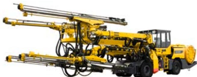
棒小伙子干重活：Veidekke的新Boomer XE4用于哥特堡的附近的高速铁路双线隧道工程。
