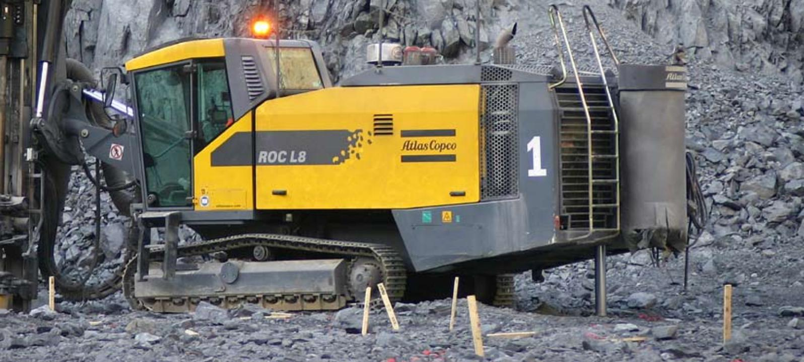
向选矿厂供应矿石：2台装有30 bar空气压缩机的ROC L8露天履带式钻机之一正在台阶上工作。钻机在矿体上钻7.5 m的孔，在废石上钻15 m的孔，每天生产3,000吨矿石。
