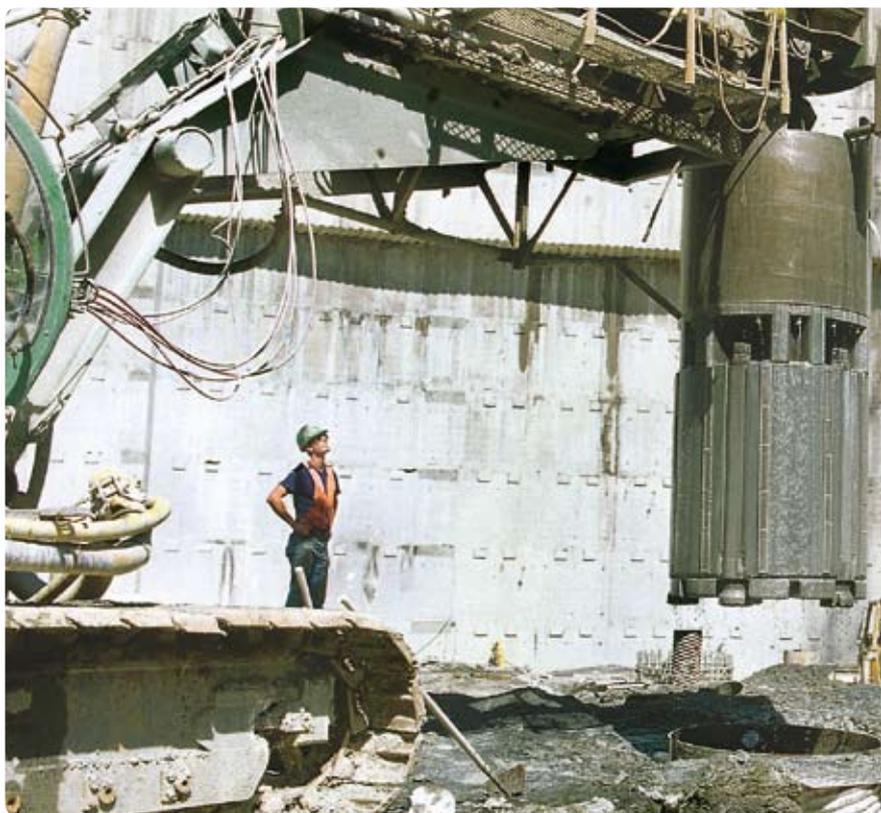
用潜孔锤组装的集束式钻机在美国被广泛用于快速容易地钻大直径孔。右上图：下降集束式潜孔锤就位。左图：倒空Calyx钻屑收集筒。
