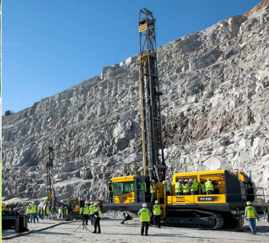
亮点：钻孔直径到60”的最新Pit Viper 235装有钻机控制系统RCS并提供几种发动机和空气压缩机供选择，用于回转式钻进或潜孔锤钻进。
