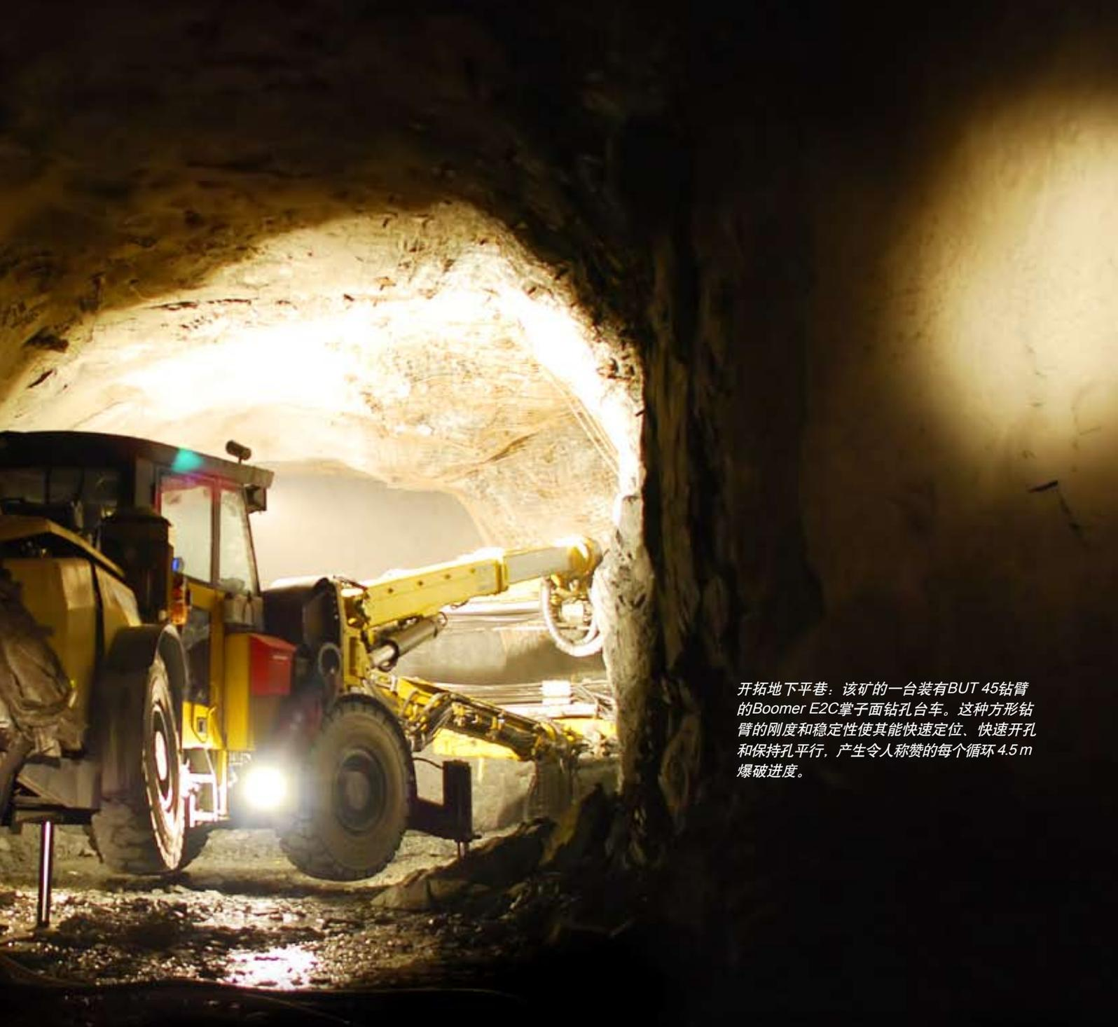
开拓地下平巷：该矿的一台装有BUT 45钻臂的Boomer E2C掌子面钻孔台车。这种方形钻臂的刚度和稳定性使其能快速定位、快速开孔和保持孔平行，产生令人称赞的每个循环4.5 m爆破进度。
