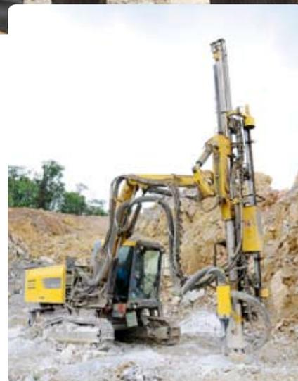
破碎大块岩石：ROC D7的折叠式钻臂系统使其成为二次破碎及生产钻孔的理想设备。
