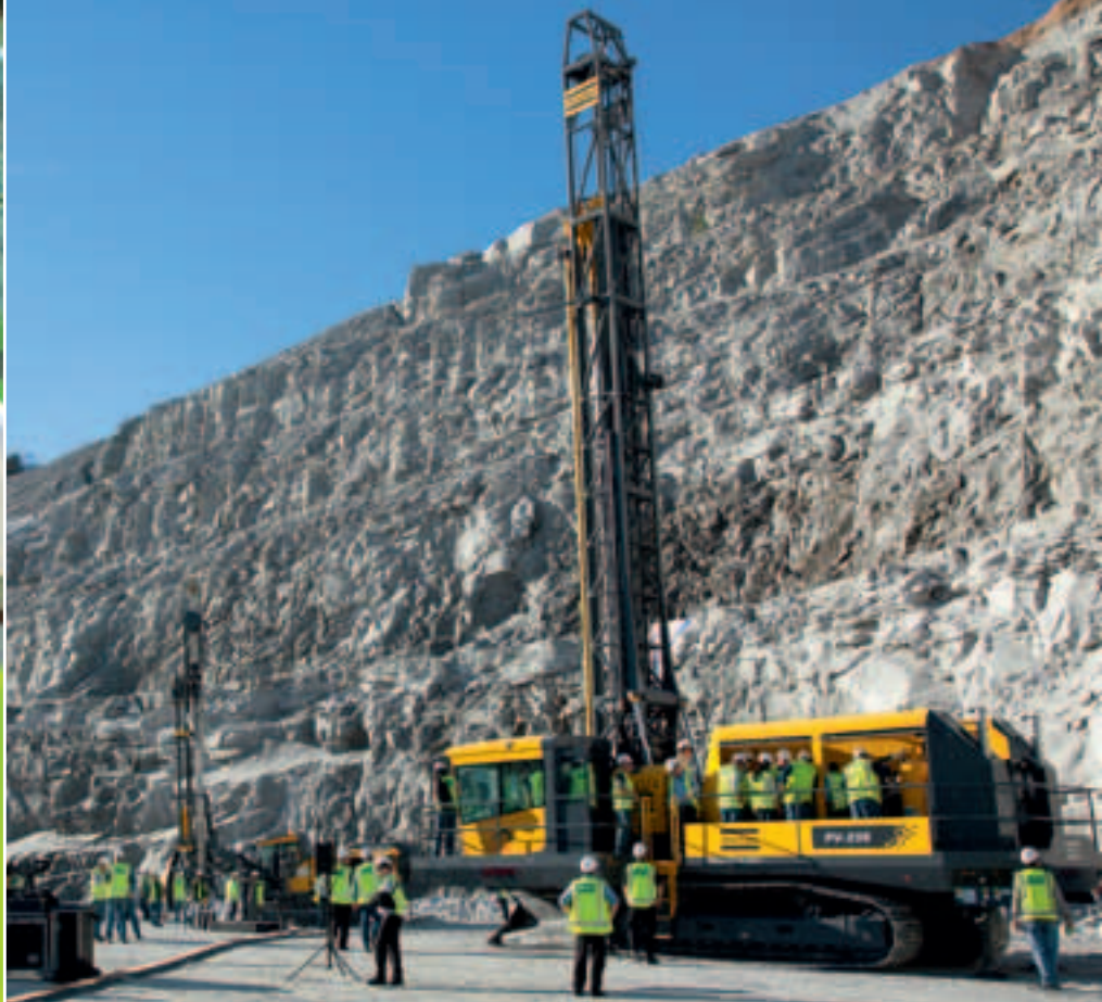
Главный интерес: основные особенности последней модификации Pit Viper 235 для скважин диаметром до 400 мм — система управления RCS, а также выбор альтернативных двигателей и компрессоров как для вращательного бурения, так и для бурения с ППУ высокого давления.
