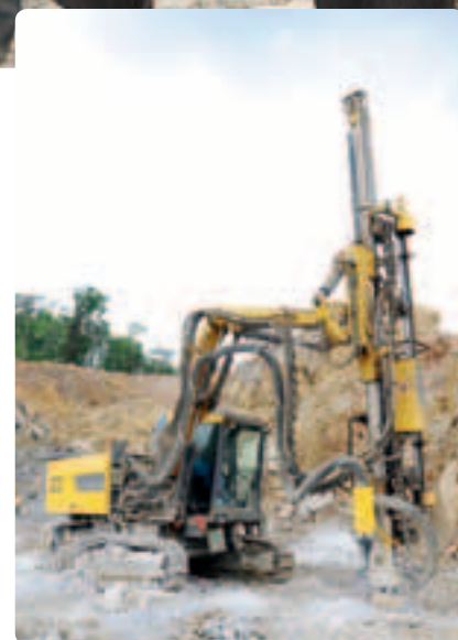
В работе: складывающаяся стрела ROC D7 делает его идеальным как для вторичного взрывания, так и для добычного бурения.
