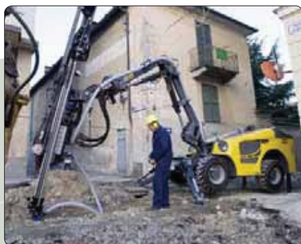
バウマでデビュー：せん孔径 38-64 mm用ドリル。最新の ROC T20 は幅広い建設作業に対応します。
