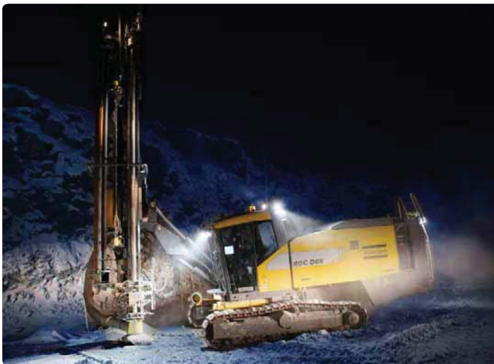
SmartRig ROC D65 は DHL 掘削の完全なコンピュータ化を可能にしました。掘削サイクルを自動化したリグ・コントロール・システムの賜物です。
