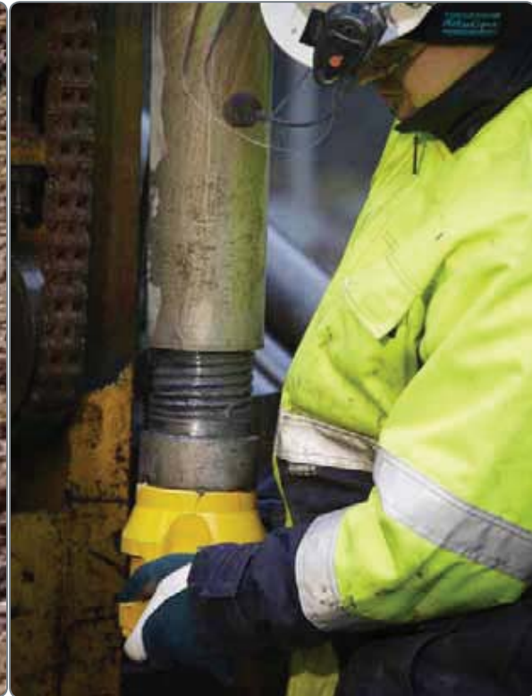
オペレーターがエレメックスパイロットビットをロッドに取り付けています。
