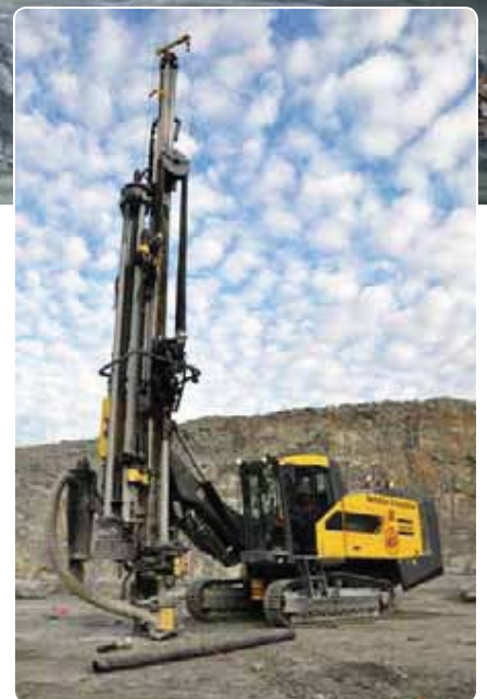
優れた性能：COPROD ドリルシステムを採用した ROC L7 40 CR。採石場のオペレーターは、難しかぶりに真っ直ぐで質のよい孔が掘れることに感動した。
