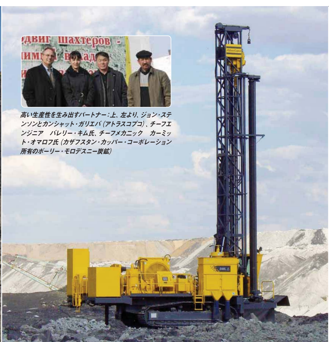
ベンチ高 45m のアトラスコプコ DML と DM45。油圧式トップヘッドドライブを装着した、新製品の電動駆動の DML
