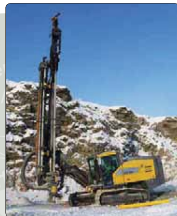
パワフルなコンビ：SmartRig ROC D65 と SmartRig の機能がダウン・ザ・ホールドリル工法を確かなものにします。
