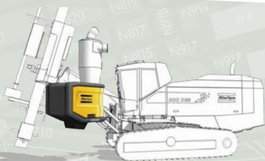
鉦山従事者にとって画期的な新発明： この穿孔機はスキャンング設備を搭載しており、 ドリル時に同時に測定用の岩石も探出します。
