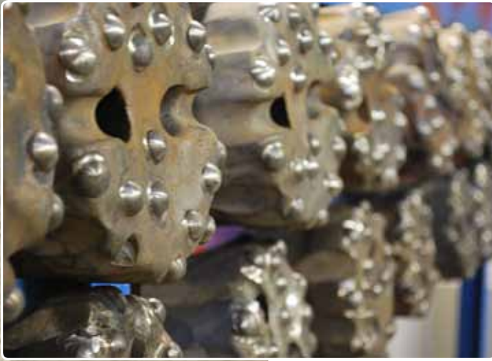
Brocas Secoroc reafiladas: Estas máquinas de afilar Secoroc GrindMatic facilitan el afilado eficiente de las brocas en el taller de Aitik.
