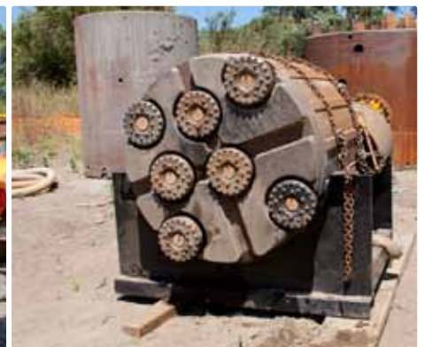
La configuración de Thor: Un cluster de siete martillos Atlas Copco Secoroc CDS de 8" equipados con brocas de 10".
