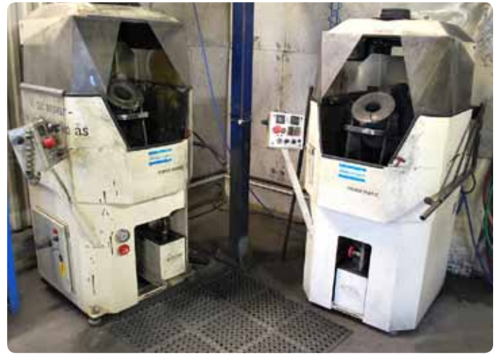
Brocas Secoroc reafiladas: Estas máquinas de afilar Secoroc GrindMatic facilitan el afilado eficiente de las brocas en el taller de Aitik.
