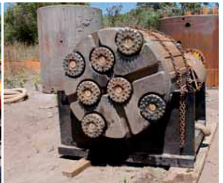
雷神的结构：7 套阿特拉斯·科普柯赛柯洛克 CDS 8 英寸潜孔锤，每套潜孔锤装有 10 英尺钻头。
