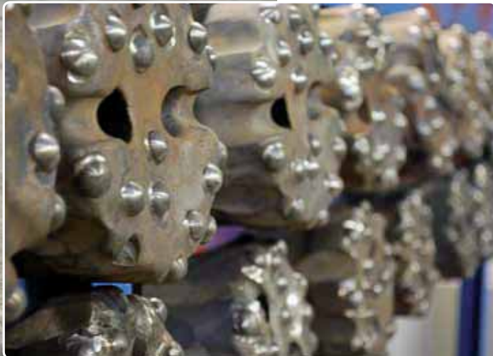
修磨以后的赛柯洛克钻头：Aitik 车间的赛柯洛克 GrindMatic 修磨机能够提供简单而高效的磨钻。
