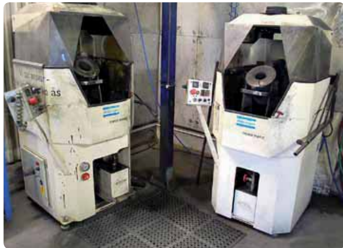
修磨以后的赛柯洛克钻头：Aitik 车间的赛柯洛克 GrindMatic 修磨机能够提供简单而高效的磨钻。
