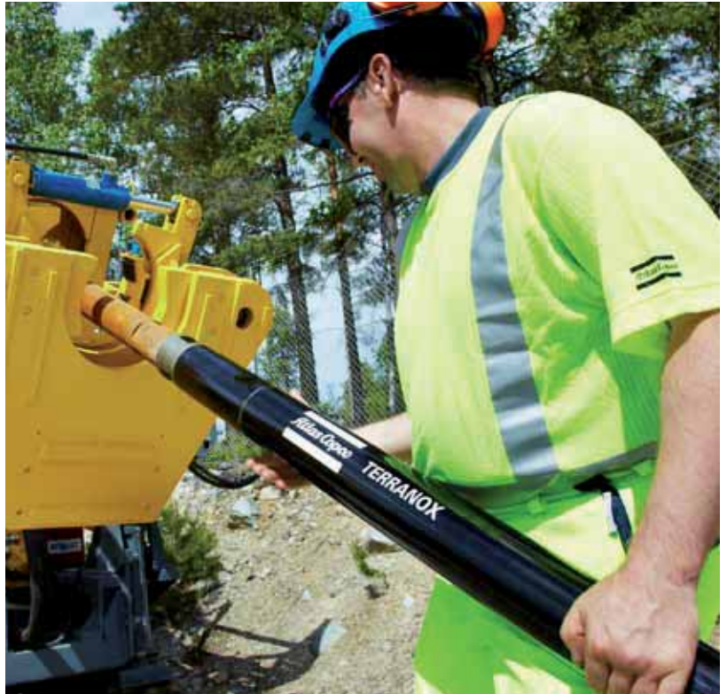
理想的解决方案：阿特拉斯·科普柯新的 Terranox 潜孔锤特别适用于城市内的敏感地基和必须保护既有建筑物的地方。
