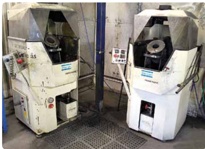
Коронки Secoroc после заточки: в цеху на Айтике на этих станках GrindMatic производится перезаточка коронки. Легко и просто.
