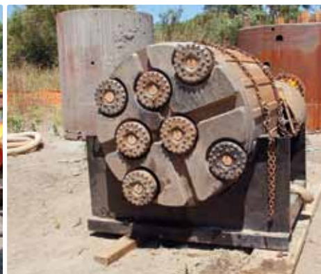
Конфигурация Тора: кластер с семью молотками CDS 8” Atlas Copco Secogoc, укомплектованными 250 мм коронками.
