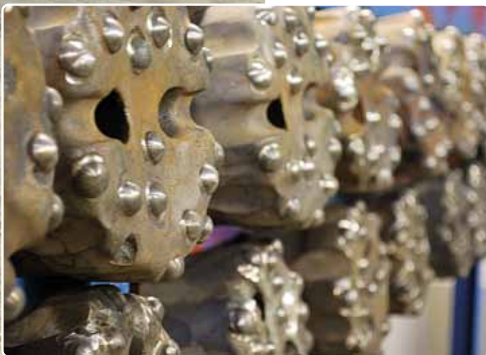
Коронки Secoroc после заточки: в цеху на Айтике на этих станках GrindMatic производится перезаточка коронки. Легко и просто.
