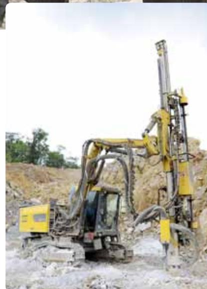
大塊に挑む：補助発破、せん孔に最適なROC D7のナックル式ブームシステム
