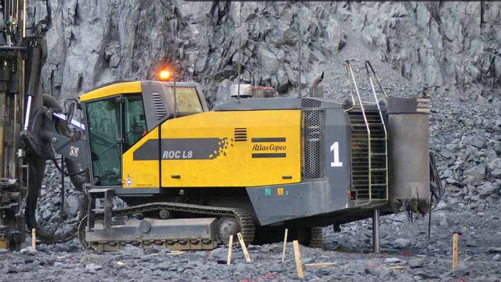
穿孔業者の要求を満たす：ベンチで活躍する ROC L8 サーフェスクローラドリル。鉱山に2台あるうちの1台（30barのコンプレッサを搭載）。ドリルは全長22mのせん孔を行い7.5mの鉱脈を取り、1日あたり3000tonの鉱石を産出します。
