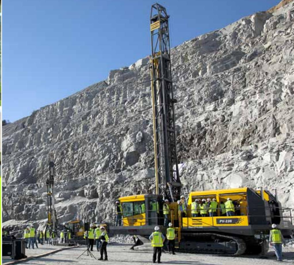
メインイベント：孔径6インチ用の最新ビットパイパー235はRCSコントロールシステムを備えています、そしてロータリーか高圧DTHドリリングのどちらかを選択すると、エンジンとコンプレッサの出力はそれに依りて切換えされます。
