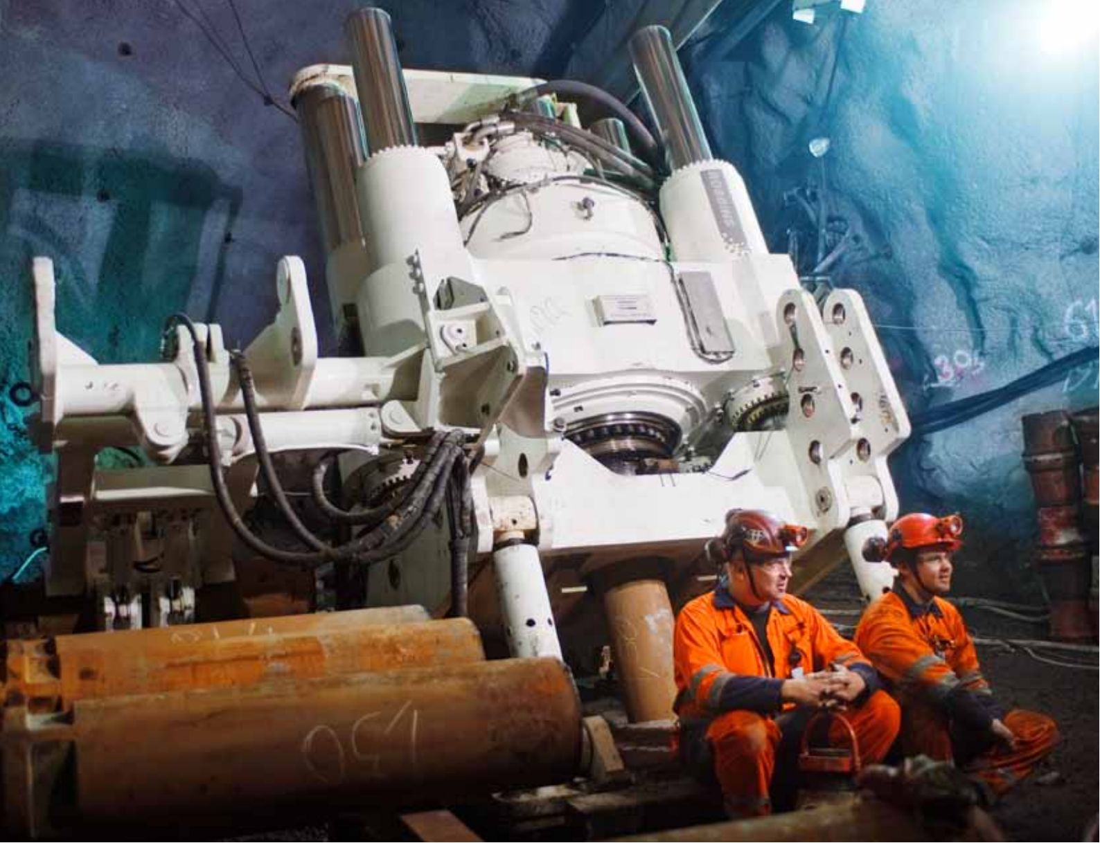
El raiseborer Atlas Copco Robbins 91RH C en la Mina Kiruna: Una máquina muy avanzada con enorme potencia y torque, en esta foto con los perforistas, Ulf Lindström y Johan Garp de Bergteam.
