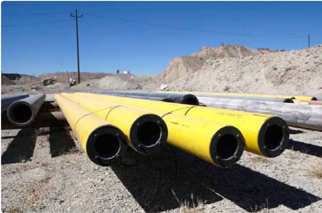
Los tubos Atlas Copco TEAMALLOY® en Mission Complex: El equipo PV-271 opera con dos secciones de 7,6 m (25 pies) y una de 2,4 m (8-ft), de 219 mm (18 5/8") de diámetro. Derecha, el personal de Mission instala la potencia para la versión eléctrica del PV-271 utilizado cuando el tiempo disponible lo permite.
