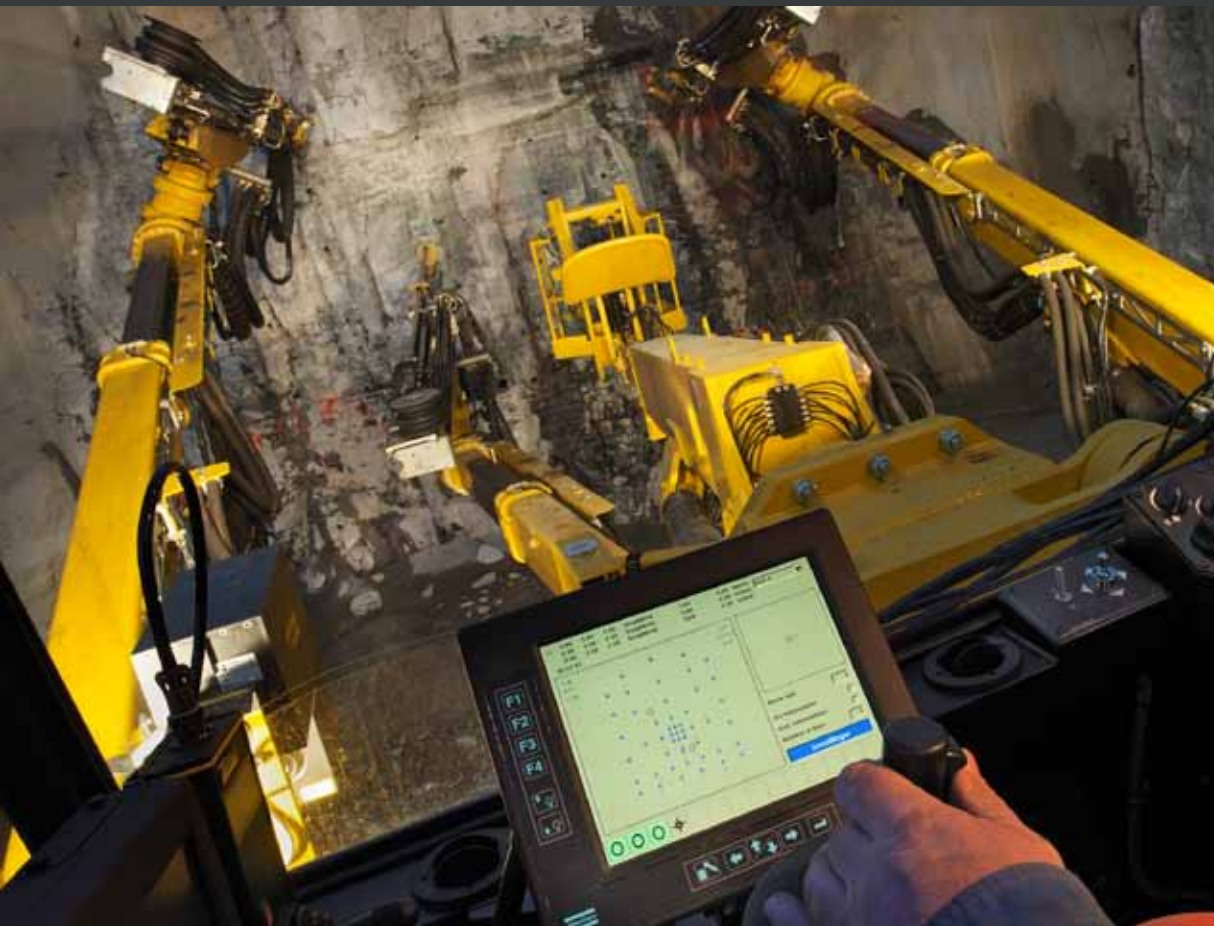
Control total: La tecnología RCS presenta todos los datos necesarios en la pantalla y permite compartirlos con otros para la optimización total de la operación.
