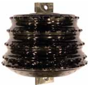
Componente clave: El cortador Secoroc Magnum V, usado en los escariadores de los Raiseborers.
