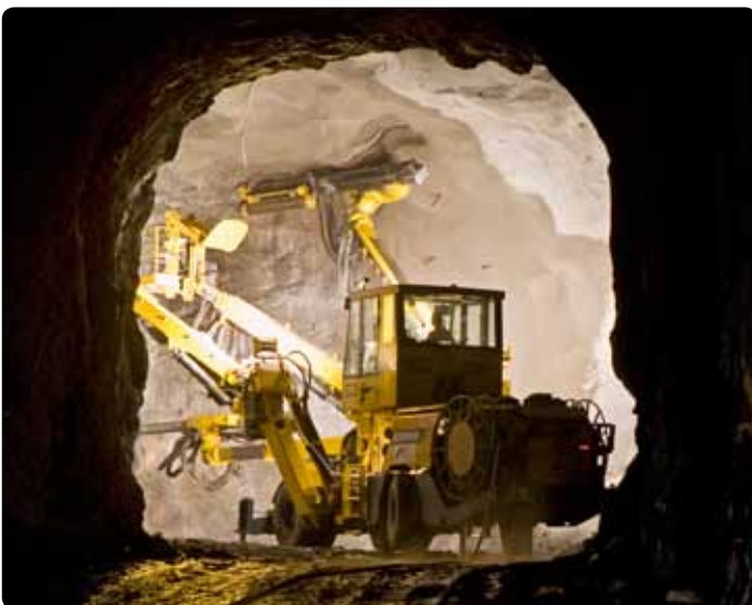
Tecnología en acción: Toda la información cargada en la computadora central a bordo de este Boomer XE3 C es accesible para todos los que participan en el proyecto.
