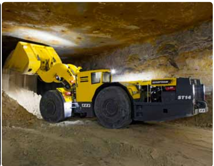
Tecnología en acción: Gracias al sistema de control RCS, este cargador Scooptram ST14 es capaz de recoger y compartir información, por ejemplo, sobre pesaje y capacidad de carga, y servicio.
