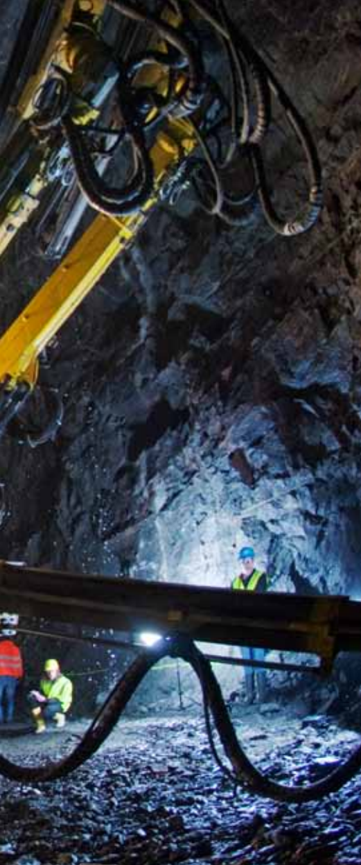
La plataforma de servicio del equipo es usada para preparar los pozos para la carga y voladura.
