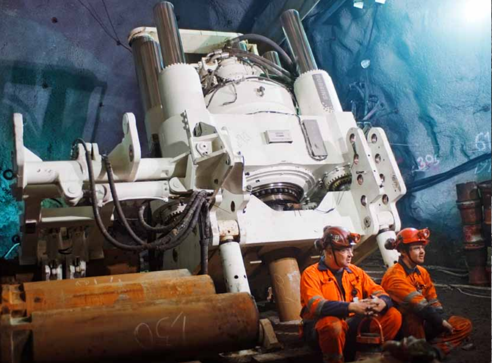
阿特拉斯·科普柯 Robbins 91RH C 天井钻机在 Kiruna 矿：极其先进的设备正在提供巨大的动力和扭矩，图为 Bergteam 的操作手 Ulf Lindström 和 Johan Garp 在钻机前合影。
