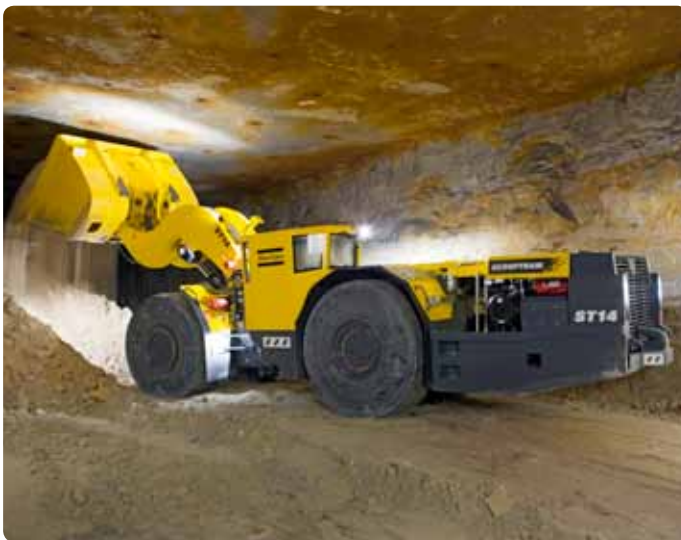
应用中的技术：由于有 RCS 控制系统，这台 Scooptram ST14 铲运机能够收集并共享信息，例如载重量、运量和服务。
