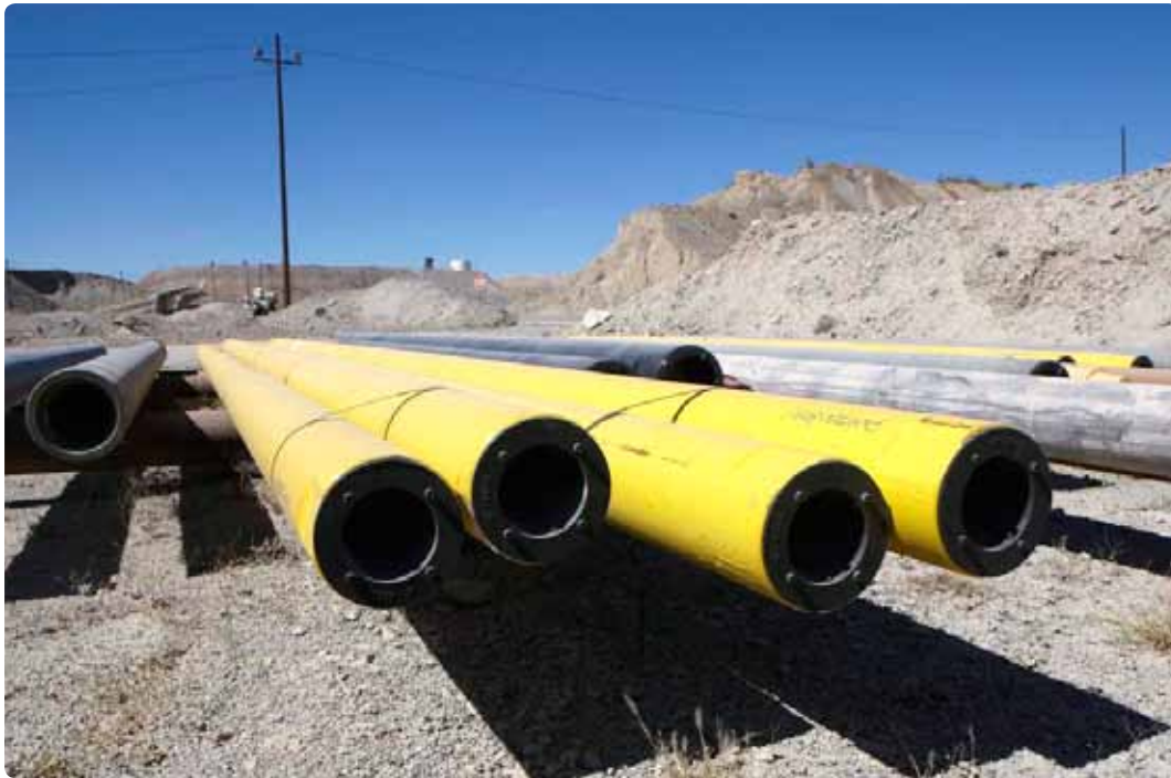
阿特拉斯·科普柯 TEAMALLOY™ 钻管在 Mission Complex 矿山：PV-271 钻机用两根 7.6 m (25 ft) 长和一根 2.4 m (8-ft) 长、直径 219 mm (18 5/8") 的钻管钻孔。右图：矿山机组人员为 PV-271 电动钻机连接电源，当条件允许时使用电动钻机。
