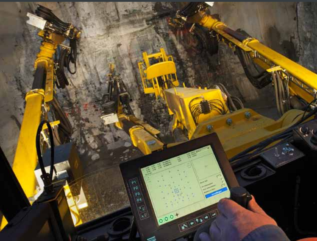
全面控制：钻机控制技术在显示屏上显示所有必要的信息，并且允许共享来全面优化操作。
