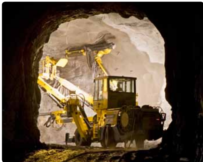
应用中的技术：所有信息储存在机载式中央电脑中，参与工程的每一个人访问这台 Boomer XE3 C 台车。
