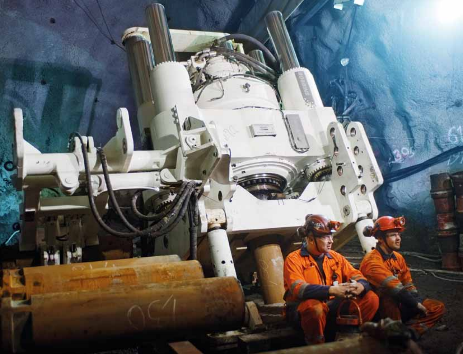
Установка для бурения восстающих Atlas Copco Robbins 91RH C на руднике Кируна. Суперсовременная машина исключительной мощности, на которой посменно работают два оператора – Ульф Линдстрём и Йохан Гарп компании Bergteamet
