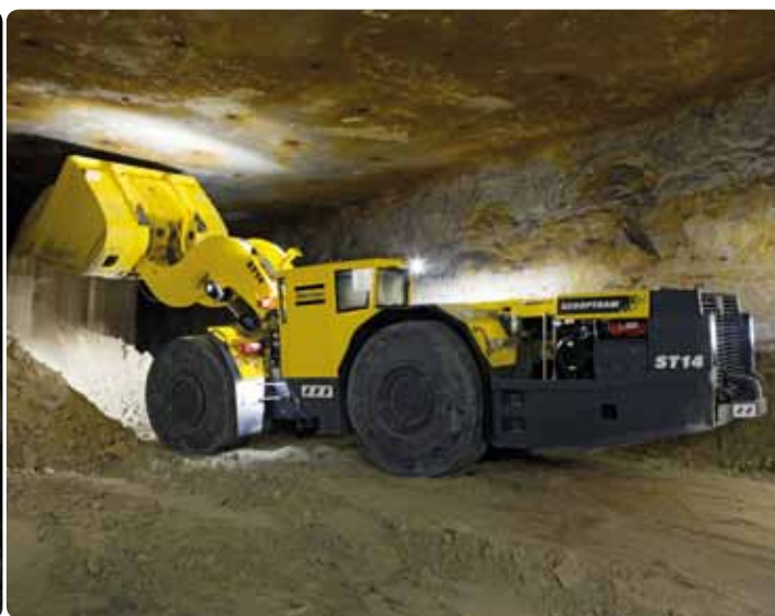
Технология в действии: благодаря системе управления RCS эта ПДМ Scoopteam ST14 может получать и “делиться” информацией по взвешиванию, весу и сервису
