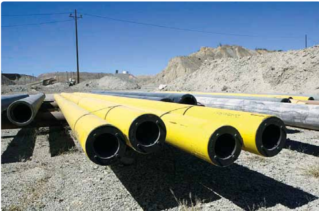
Трубы Atlas Copco TEAMALLOY™ на Mission Complex: с PV-271 используются 2 x 7.6 м секции и 1 x 2.4 м Ø 219 мм. Справа: бригада рудника налаживает питание электрического станка PV-271, используемого, когда позволяет время
