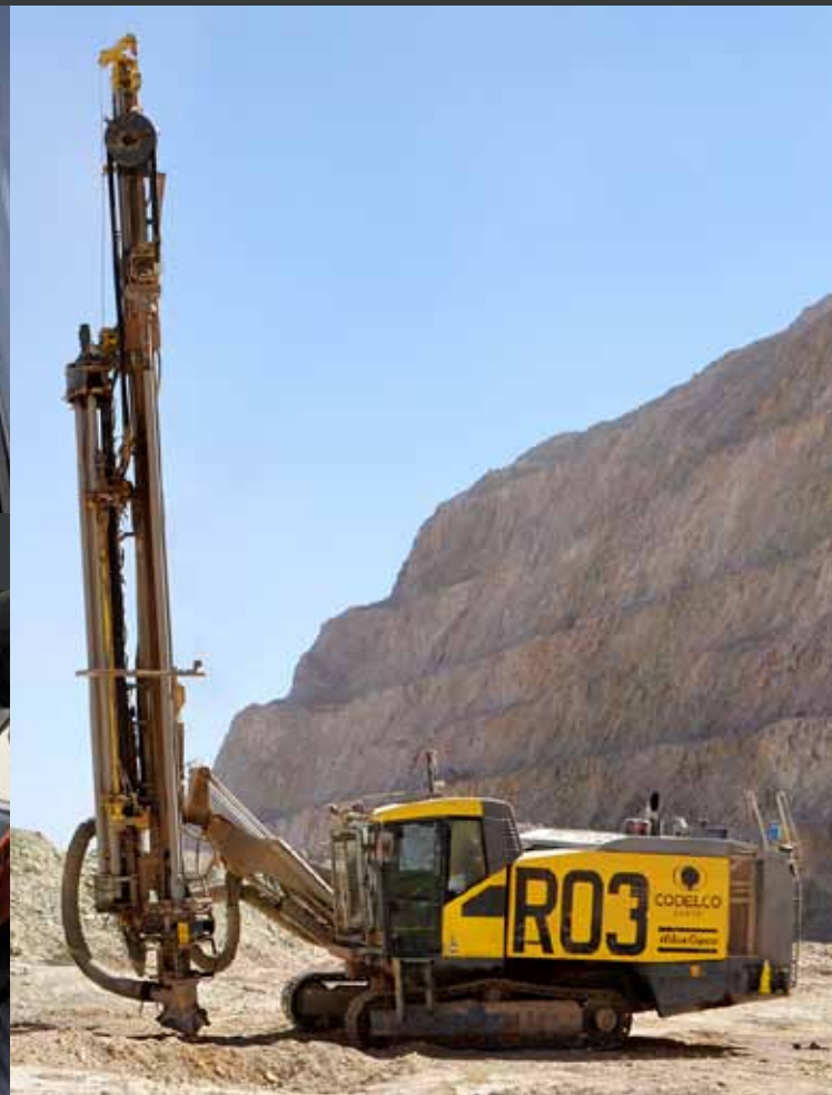
El ROC L8 trabaja duro en la mina desempeñándose en perforación de precorte y perforación.
