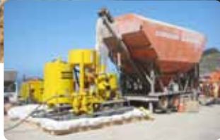
阿特拉斯·科普柯 Unigrout在Big Sur帮助稳固道路。
