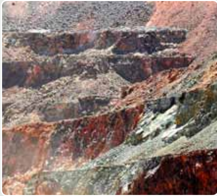
典型的痕迹：用不适合钻预裂孔的钻机执行最终边坡钻孔的矿山导致不稳定的矿坑和台阶边坡，经过一段时间就会塌落。
