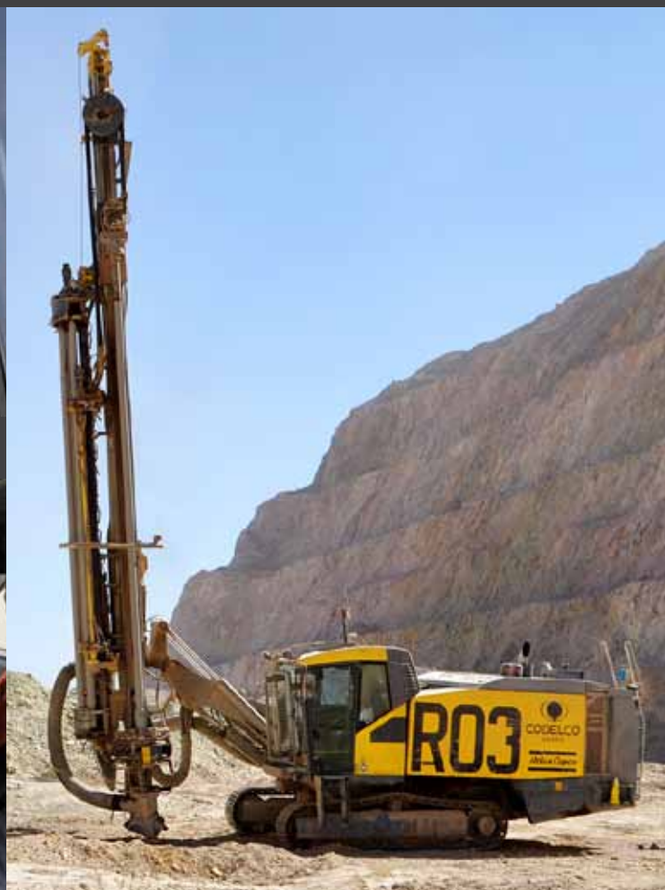
ROC L8在矿山能承担钻预裂孔和生产孔的任务。
