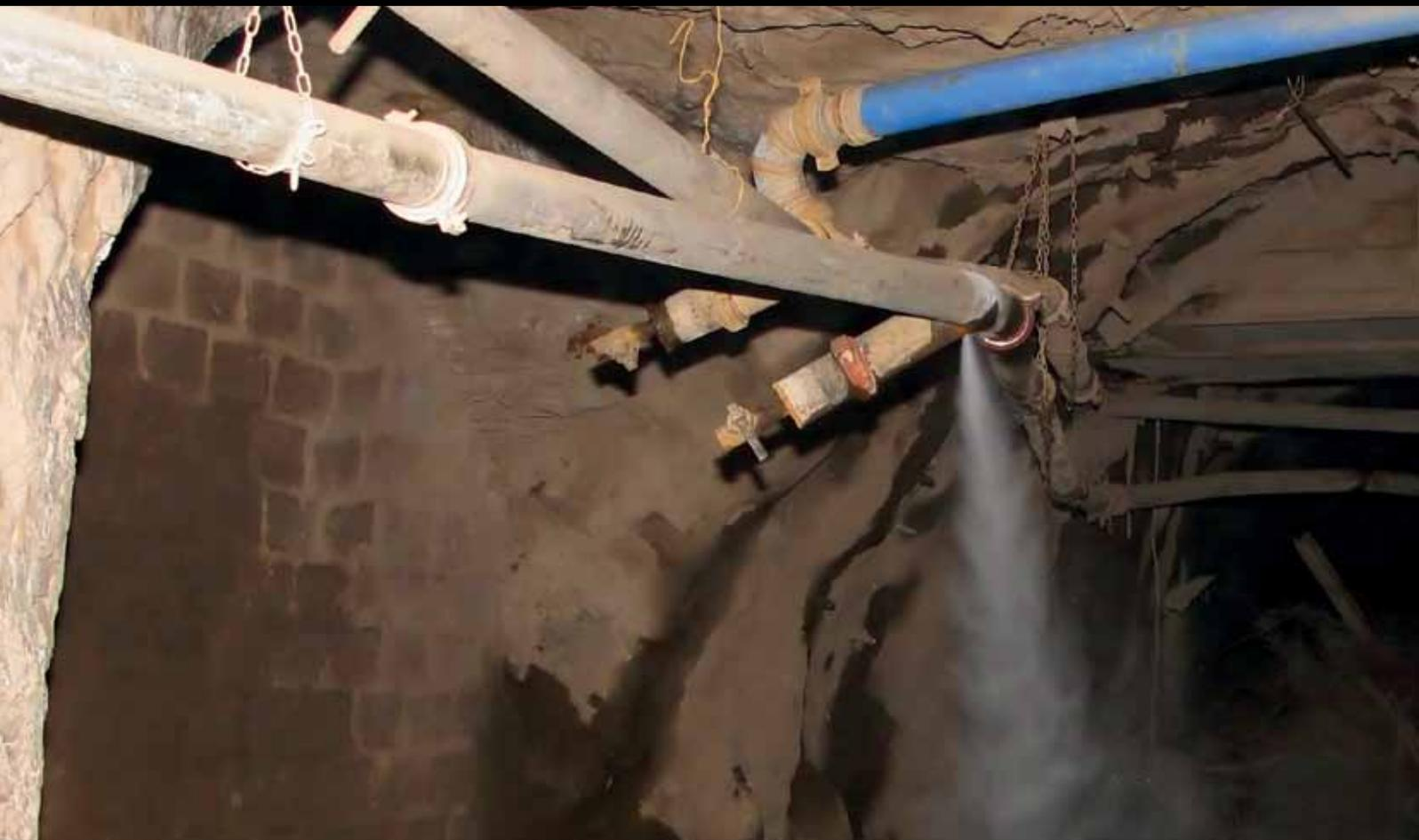
*Утекающие деньги: трубопроводы сжатого воздуха иногда протяженностью в несколько километров с болтовыми соединениями каждые пять метров – это риск течи соединений. Чем длиннее линия, тем вероятнее утечки. По словам Ларса Бергквиста, даже в лучших системах течи составляют до 30%*
