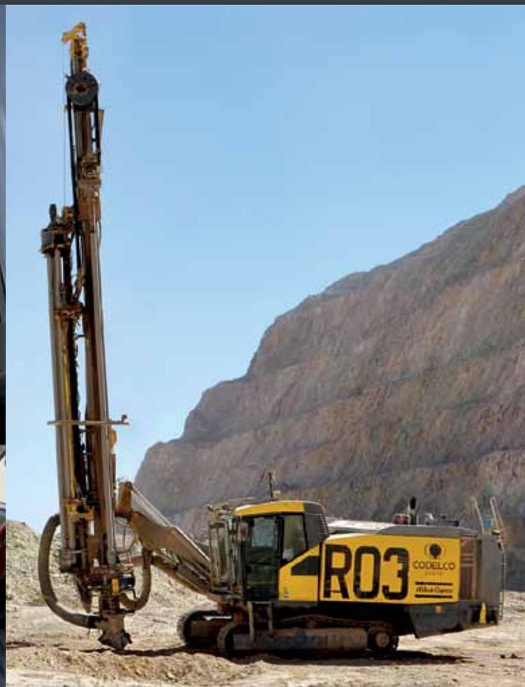
Испытания ROC L8 на бурении оконтуривающих и добычных скважин
