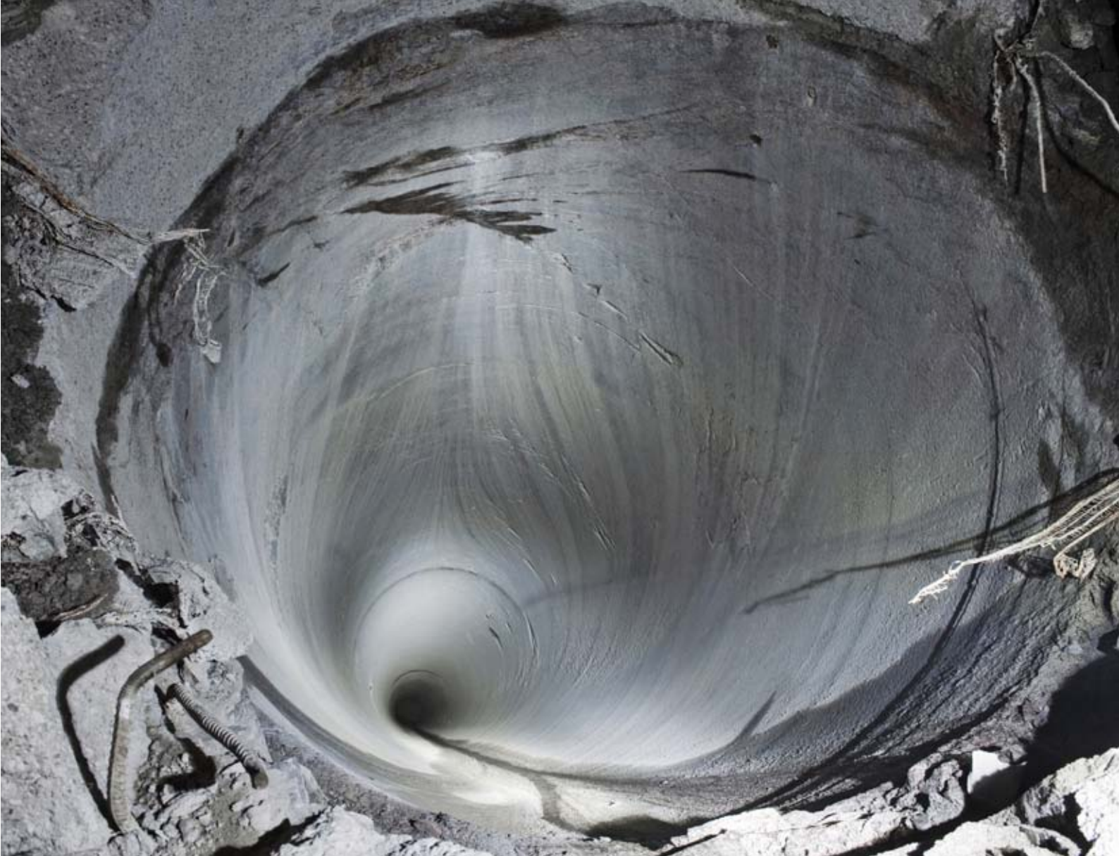
近年のレイズボーリング技術を示す好例：完璧に滑らかで真っ直ぐな壁面と計画通りの孔径
