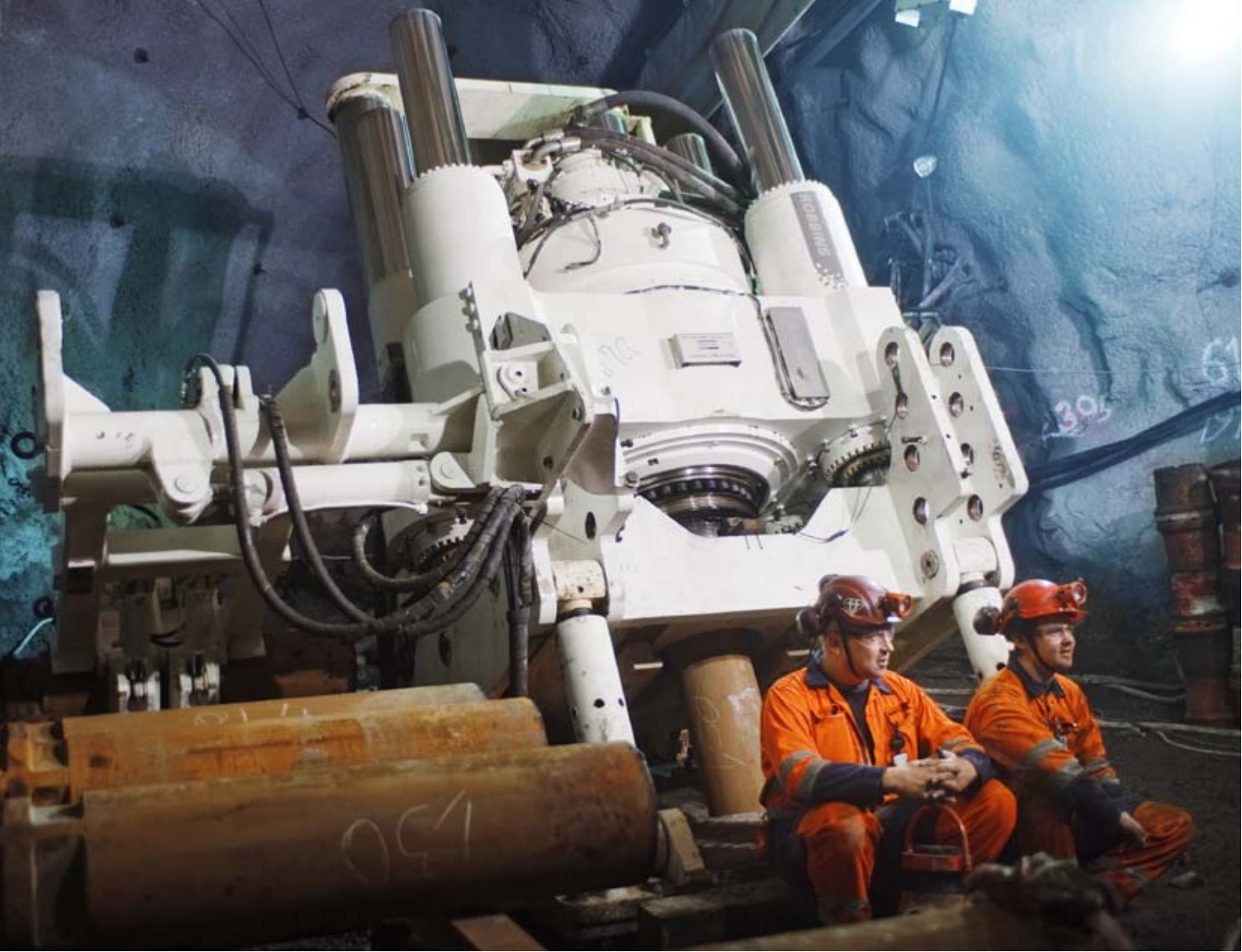
キルナ鉱山でのアトラスコプコ Robbins 91RH C レイズボーリングリグ：ベルグティーム社オペレータのウルフ・リンドストルム氏とヨハン・ガルブ氏と共に写真におさまる、最強のパワーとトルクを持つ最先端リグ
