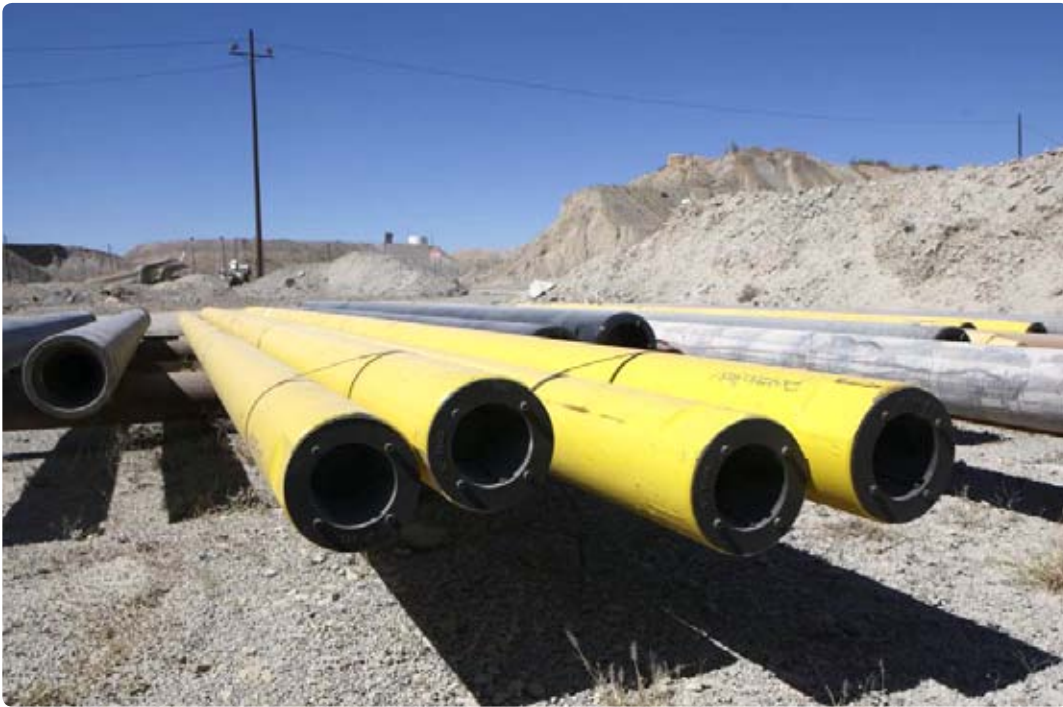
ミッション・コンプレックス鉱山でのアトラスコプロ TEAMALLOY™ パイプ：PV-271には2本の7.6m (25フィート) セクション長と、1本の2.4m (8-フィート) セクション長のパイプを使用。外径は、219mm (8 5 / 8 ”)。右：ミッション鉱山の作業員に電力セットアップをしてもらい、出番を待つ電動駆動式 PV-271。
