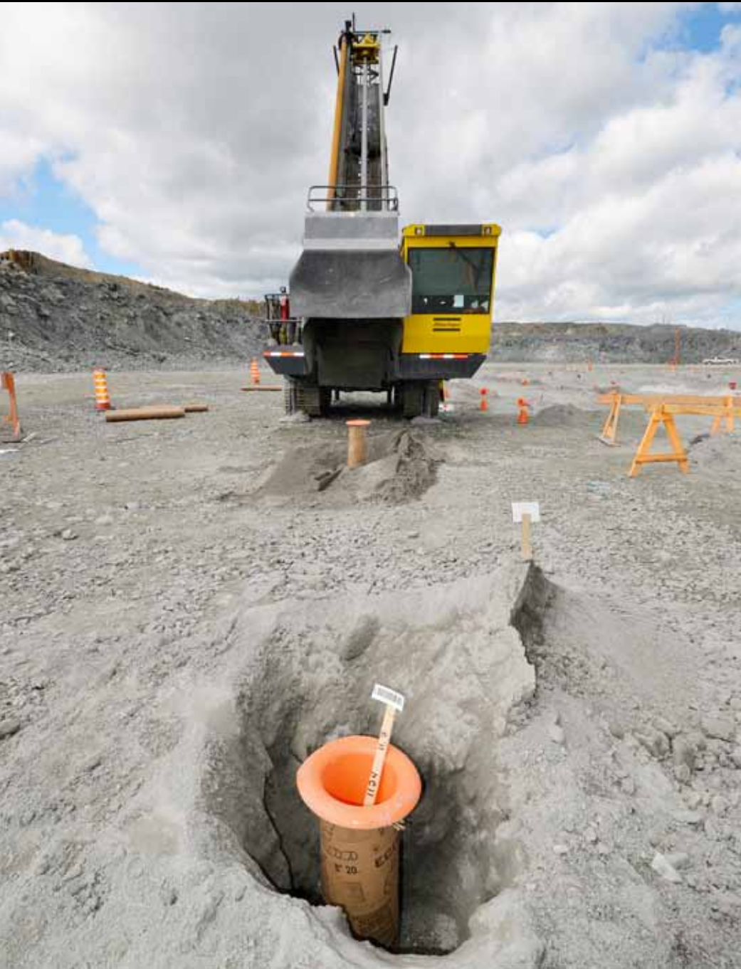
En Malartic, el Pit Viper 235 perfora pozos verticales en un diámetro de 216 mm (8,5").
