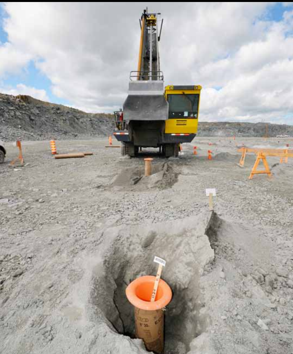
在 MALARTIC, PIT VIPER 235 钻 216 mm (8.5") 垂直孔
