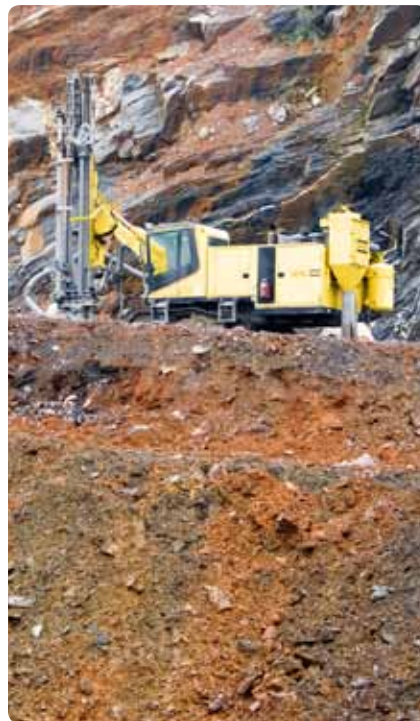
追溯：阿特拉斯·科普柯从1993年开始成为海螺集团的钻孔设备供应商。这是2007年阿特拉斯·科普柯 CM 760 D 钻机在广东省英德海螺石灰石矿工作。
