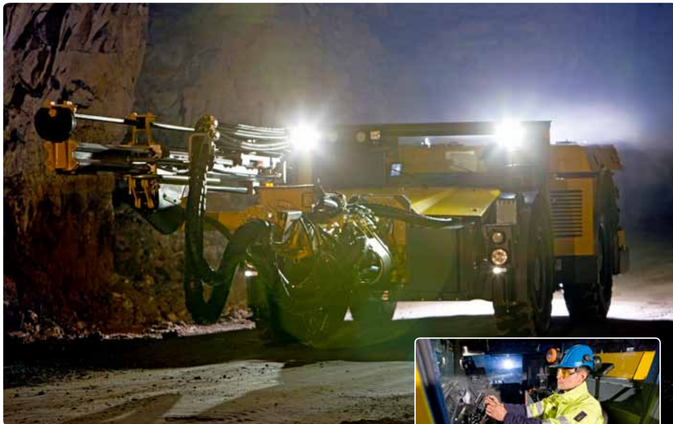
外形低而坚固：新的 Boomer M1 L 是为在顶板高度为 2.2 – 2.5 m 的矿山进行房式采矿和柱式采矿专门设计的钻孔台车。高强度和容易维修是其新增的两个特点。
