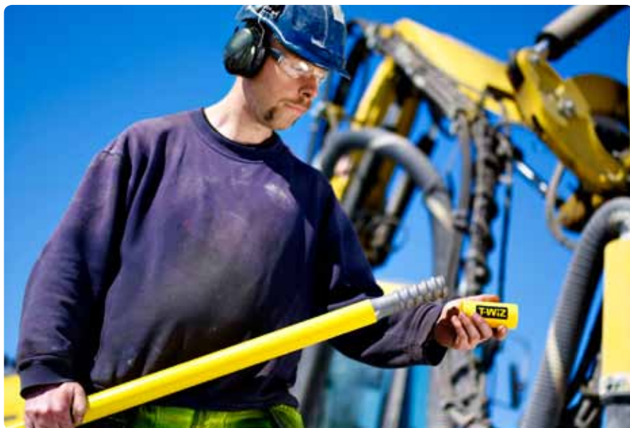
外观相似但是总体性能更好：T-WiZ Speedrods 快速钻杆和连接套有三种规格 – T38、T45 和 T51
