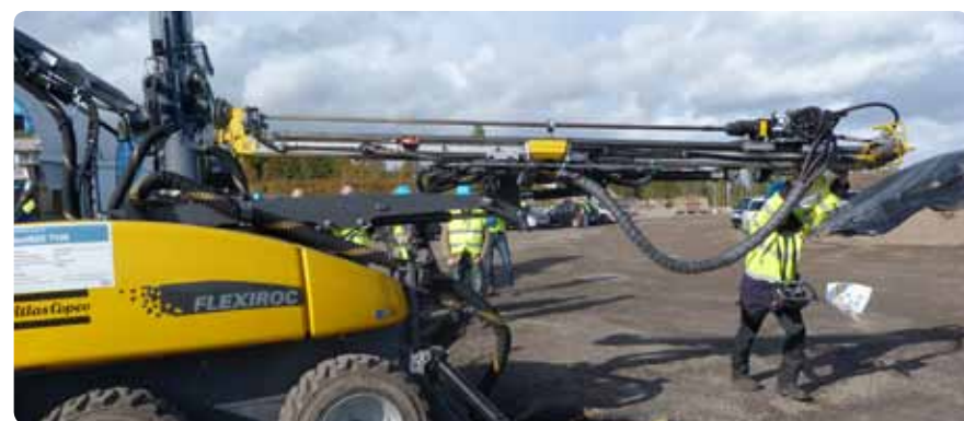
容易转换：新的 FlexiROC T15 钻机的翻转推进器能够使钻机向上、向下和以各种不同角度钻孔。
