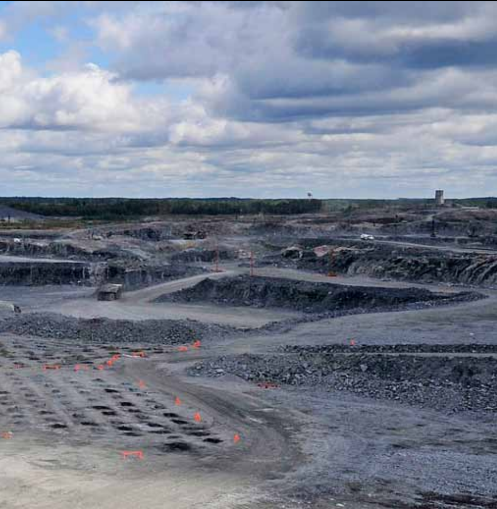
响尾蛇 PIT VIPER 235 用于在 10 m 高的台阶 上钻 12 m 深的孔。
