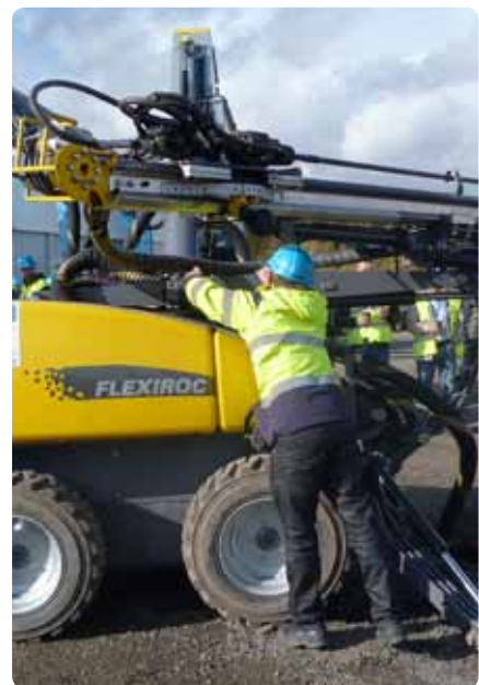
容易转换：新的 FlexiROC T15 钻机的翻转推进器能够使钻机向上、向下和以各种不同角度钻孔。
