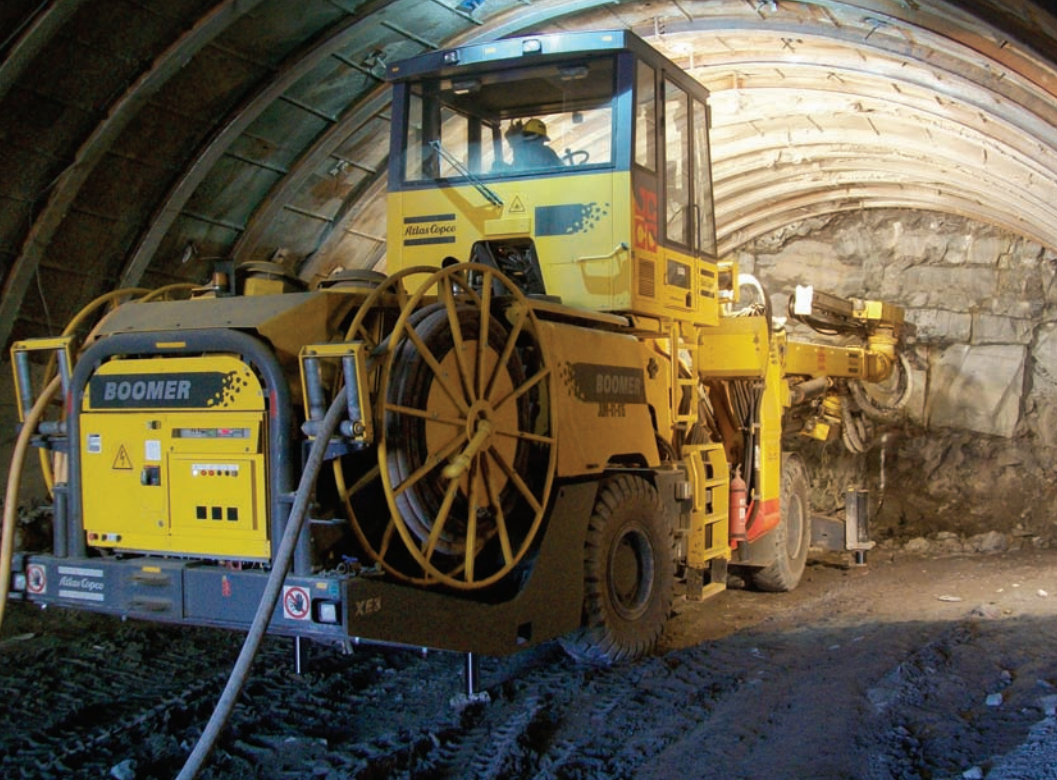
执行困难任务的现代技术：具有阿特拉斯·科普柯钻机控制系统 (RCS) 的阿根廷第一台阿特拉斯·科普柯 Boomer XE3 C 钻孔台车在该国西北山区钻爆破孔。
