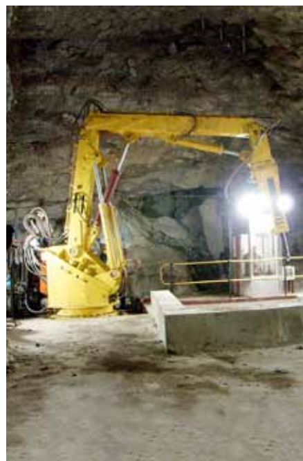
适合的工作：新的 XD 基座式动臂系统是专门为采矿设计的
