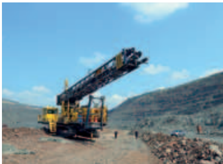
The Pit Viper 275 используется для бурения взрывных скважин Ø 251 мм для производства железорудного окатыша. Pit Viper – воплощение современной буровой технологии.
