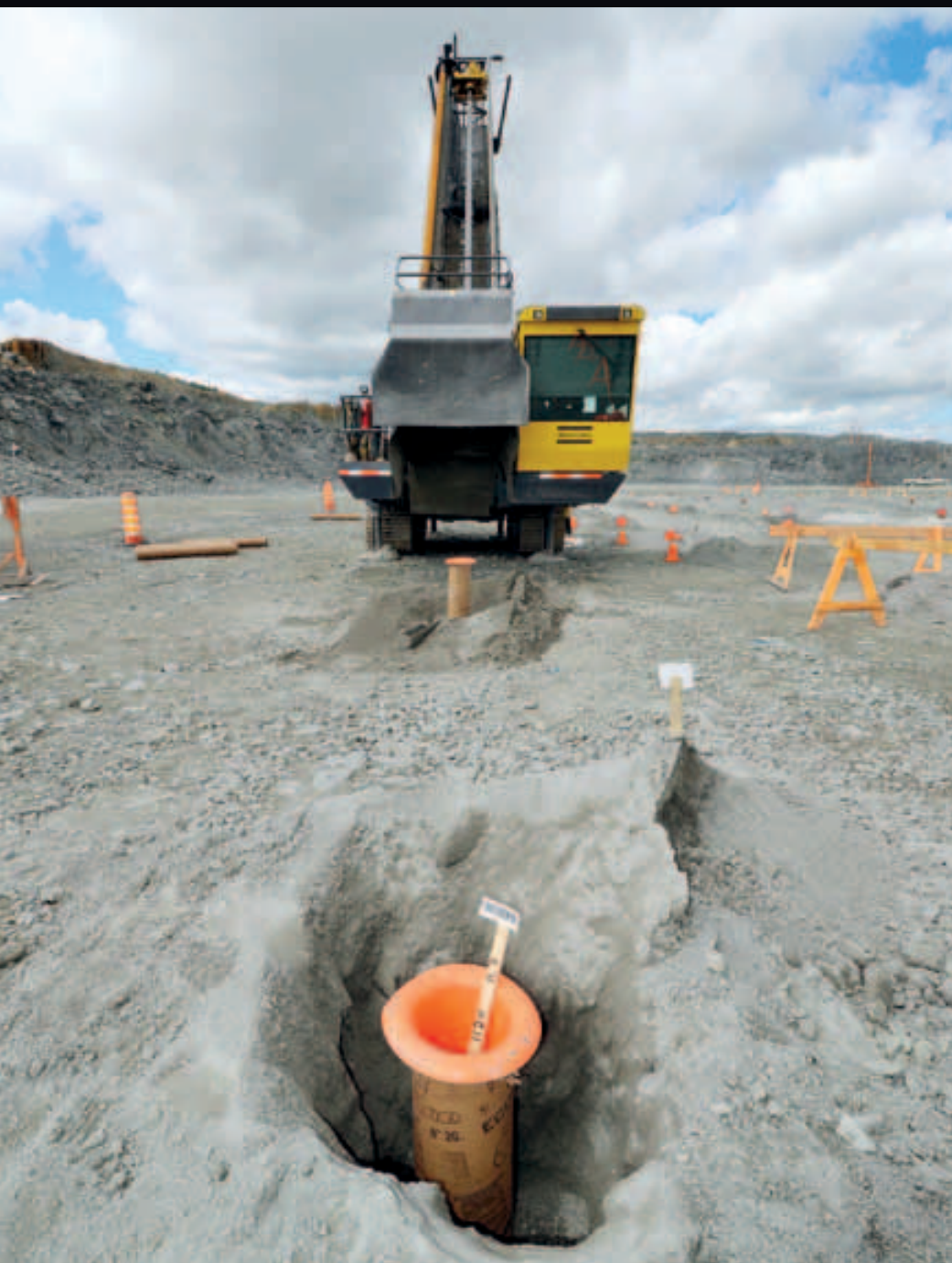
На Малартике Pit Viper 235 бурит вертикальные скважины Ø 216 мм.
