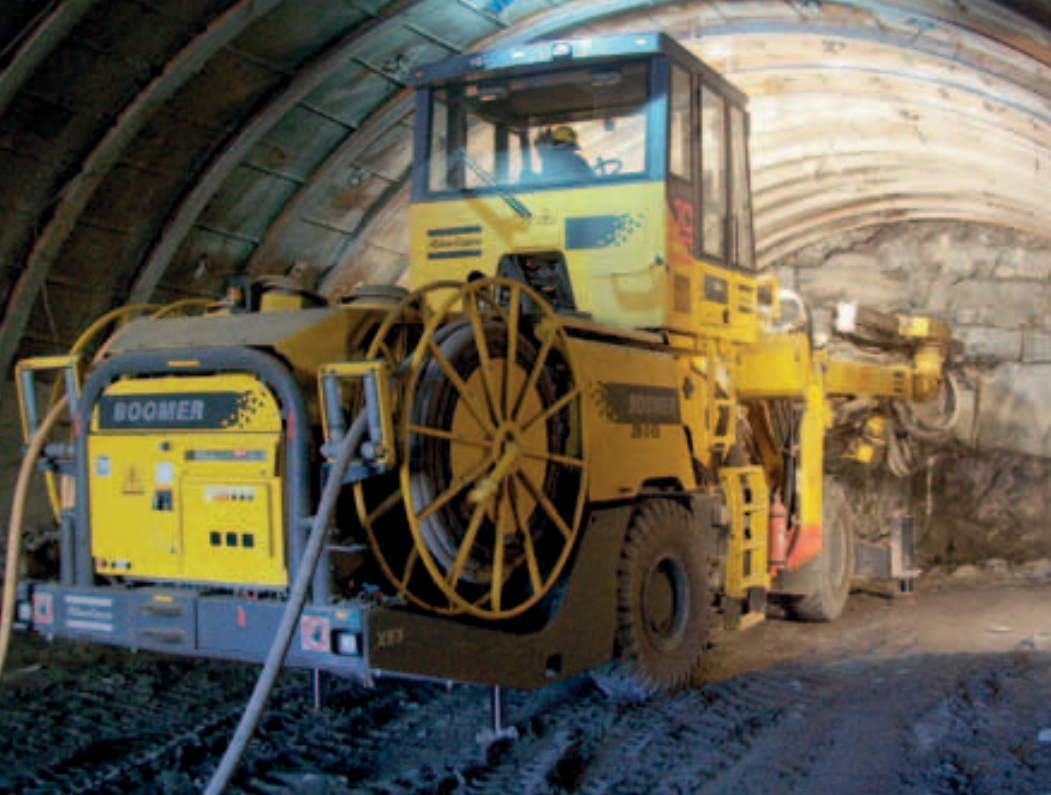
Современная технология решает трудные задачи: первый станок Boomer XE3 C Atlas Copco в Аргентине с системой RCS на бурении взрывных скважин в горах на северо-западе страны.
