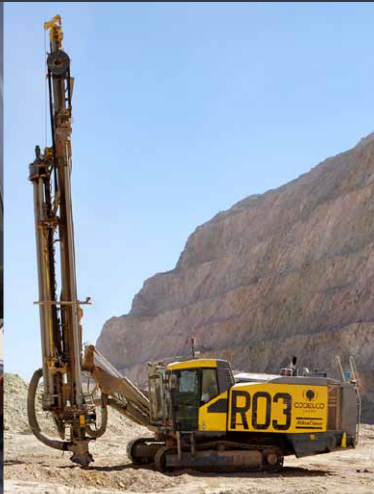
ラドミロ・トミック鉱山ではROC L8 はプレスプリットと生産用孔の両方をさく孔しています。
