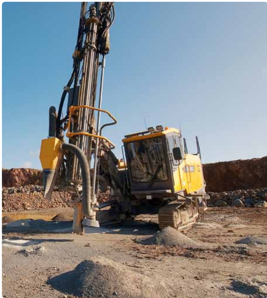
高い稼働率の維持：クィーンズランド州にある2箇所の採石場で PowerROC T35クローラドリルは1日平均300mを掘削しています。
