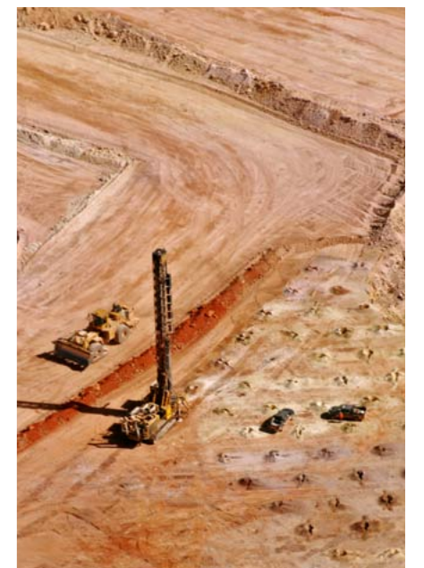
Vista desde arriba: El Pit Viper 271 trabajando en los bancos de 15 m de altura en Veladero.
