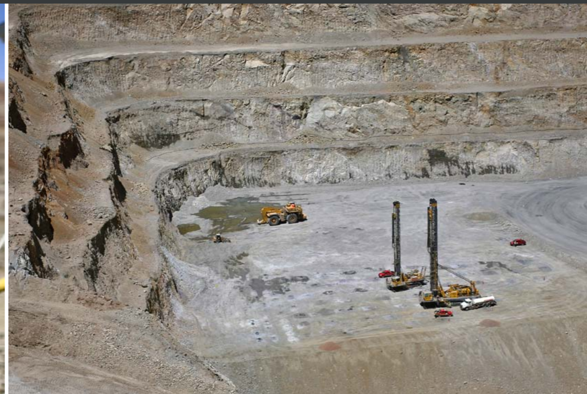
Alta productividad con las PV - 271 y PV-351 en un diámetro de 105/8" y 121/4" con un largo de perforación de 15 metros.
