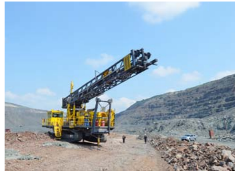
Los equipos preferidos: El Pit Viper 275 es usado en Poltava GOK para perforar pozos de voladura de 251 mm para la producción de pellets de hierro. Estos equipos de perforación representan la tecnología de punta en perforación de pozos largos.
