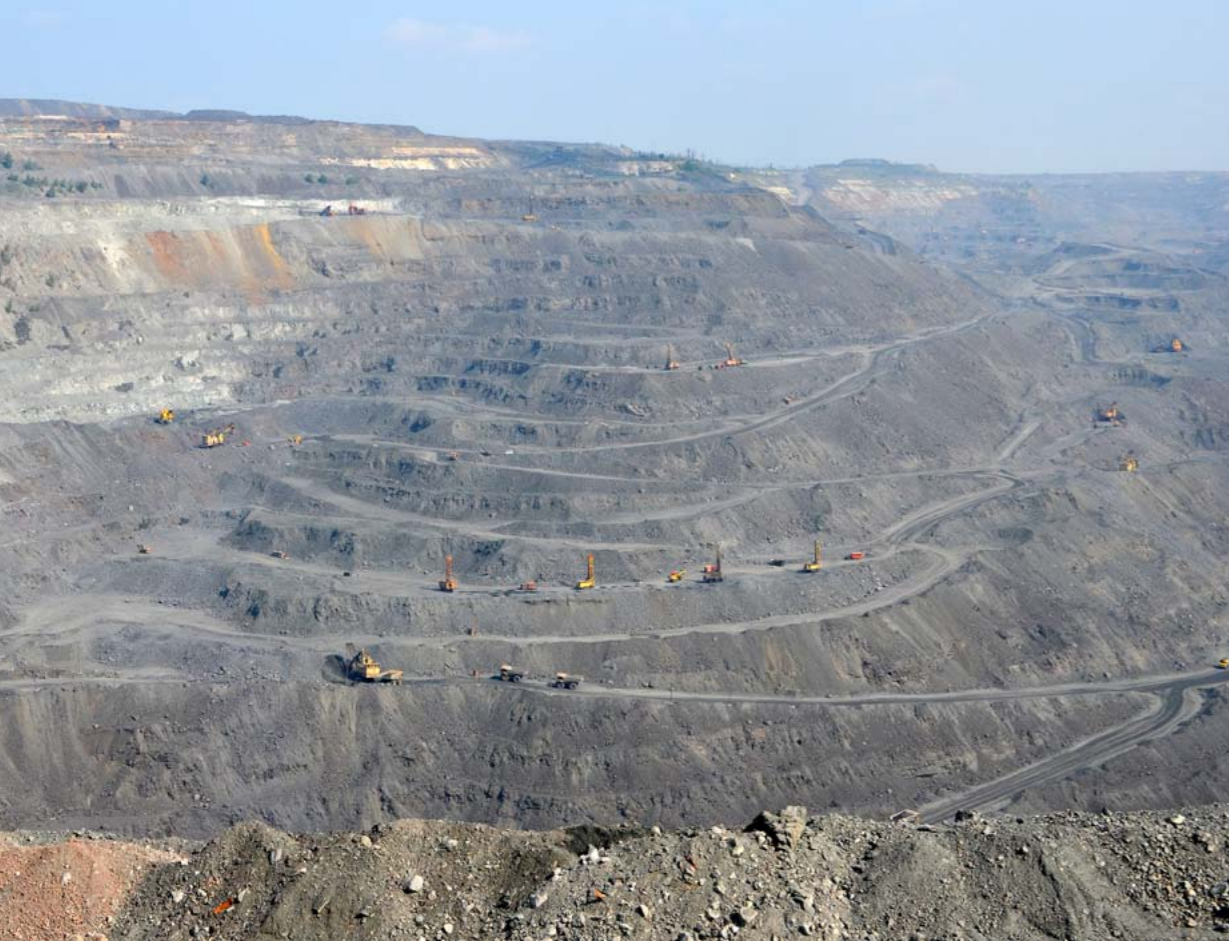
Camino al éxito: La flota de Pit Viper trabajando en los bancos de PGOK que tienen 10 o 12 m de altura. Durante la visita de M&C, los equipos PV alcanzaban un promedio de 6.500 m por mes.
