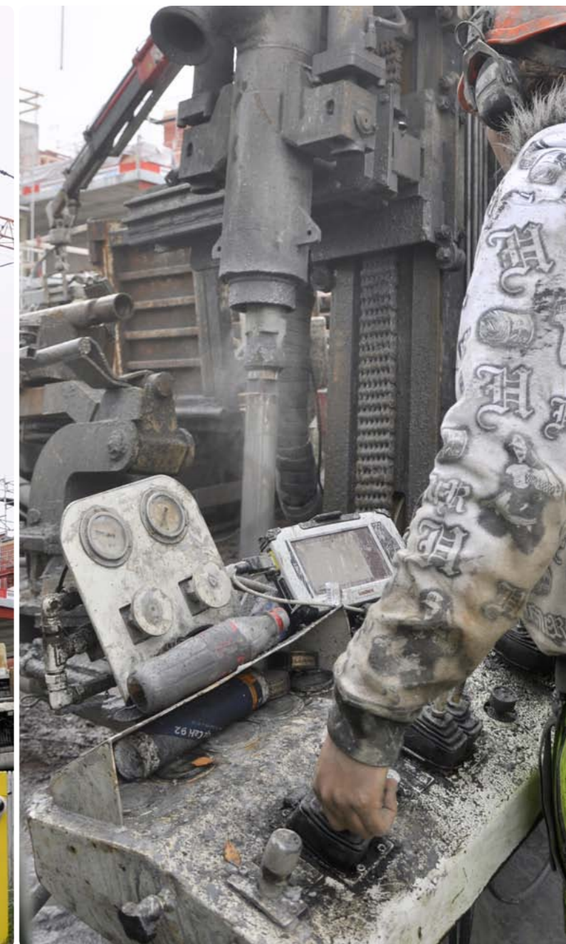
La guía perfecta: El sistema EDGE provee al perforista de información vital, permitiéndole ajustar continuamente y optimizar el proceso.
