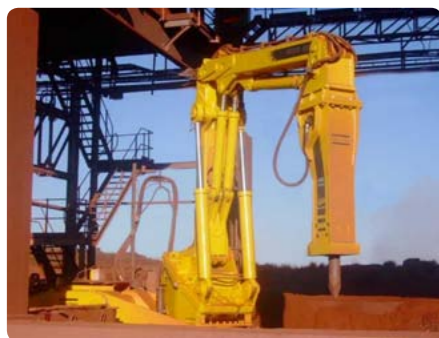
Con la trituradora produciendo 3.000 toneladas de roca por hora, el RB850 XD trabajará las 24 horas del día
