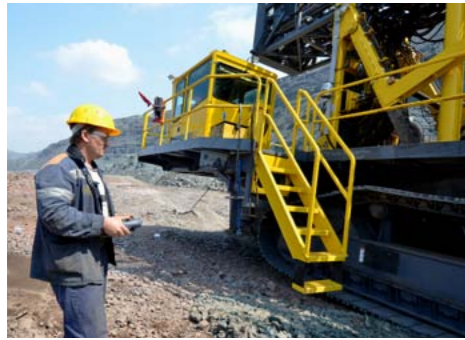
Los equipos preferidos: El Pit Viper 275 es usado en Poltava GOK para perforar pozos de voladura de 251 mm para la producción de pellets de hierro. Estos equipos de perforación representan la tecnología de punta en perforación de pozos largos.
