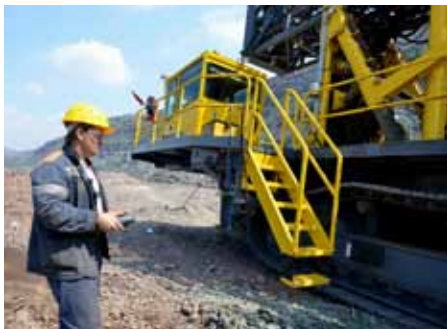
钻机的选择：Poltava GOK 使用 Pit Viper 275 钻机钻直径为 251 mm 的爆破孔，生产铁矿石球团。这款钻机是现代大孔径钻孔技术的典型代表。
