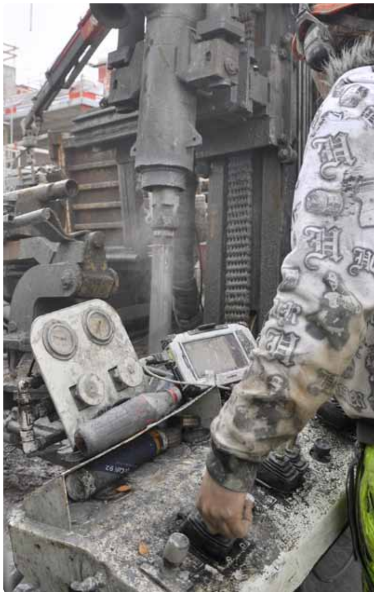
完美的引导：EDGE 系统向操作手提供极其重要的信息，使其能够连续调整和优化钻孔过程。
