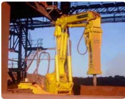
用于大型工程的大型破碎锤：安装在南非 Khumani 矿山的阿特拉斯·科普柯 RB850 XD 支座式动臂系统。
