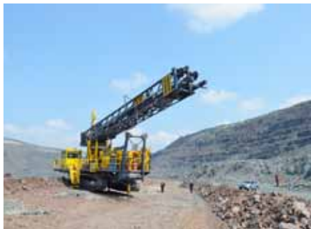
钻机的选择：Poltava GOK 使用 Pit Viper 275 钻机钻直径为 251 mm 的爆破孔，生产铁矿石球团。这款钻机是现代大孔径钻孔技术的典型代表。
