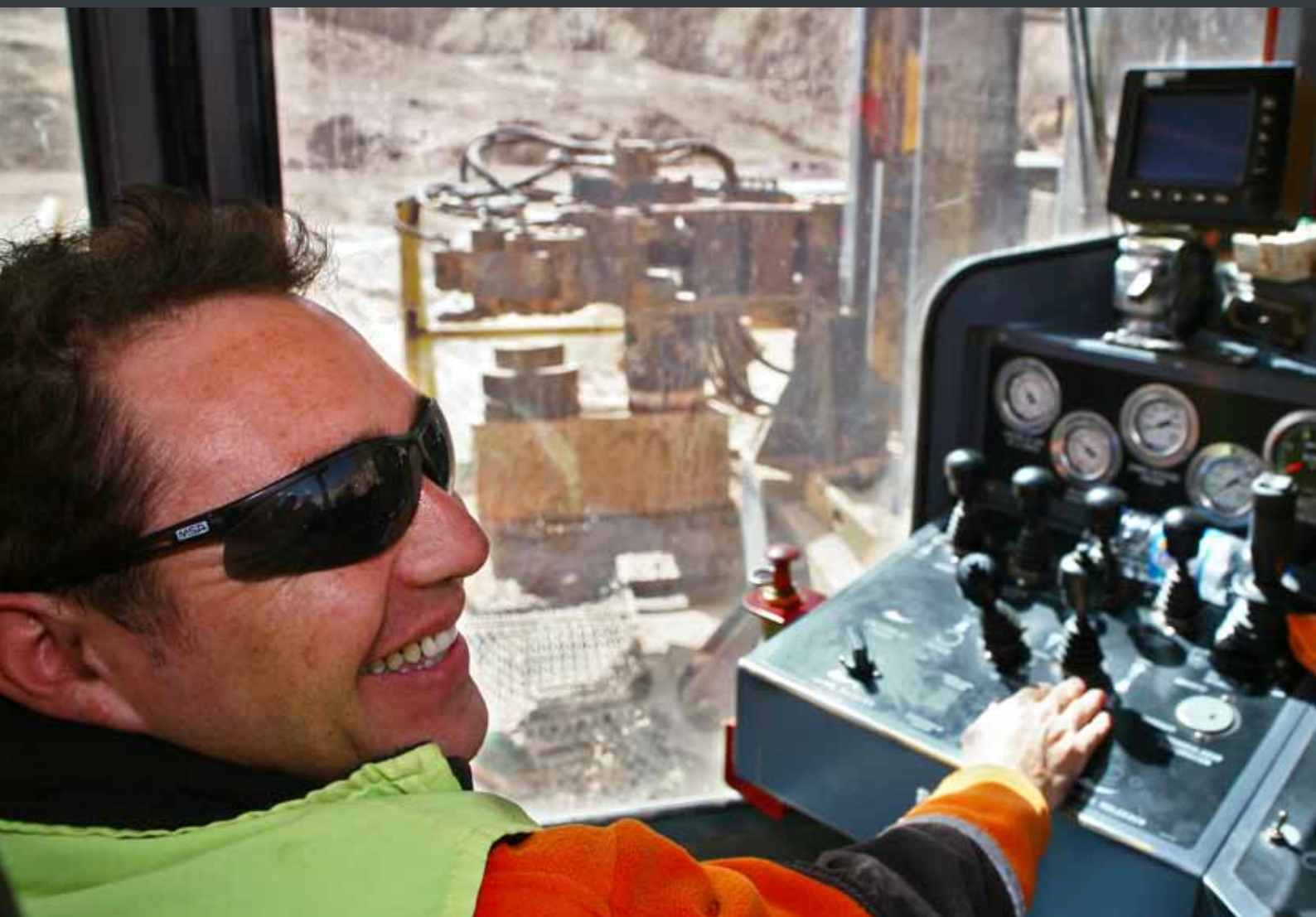
在 Veladero 采矿场，操作手 Victor Astudillo 坐在 Pit Viper 271 的控制台前。根据钻孔区域，钻一个孔需要 18 分钟到 1 小时。
