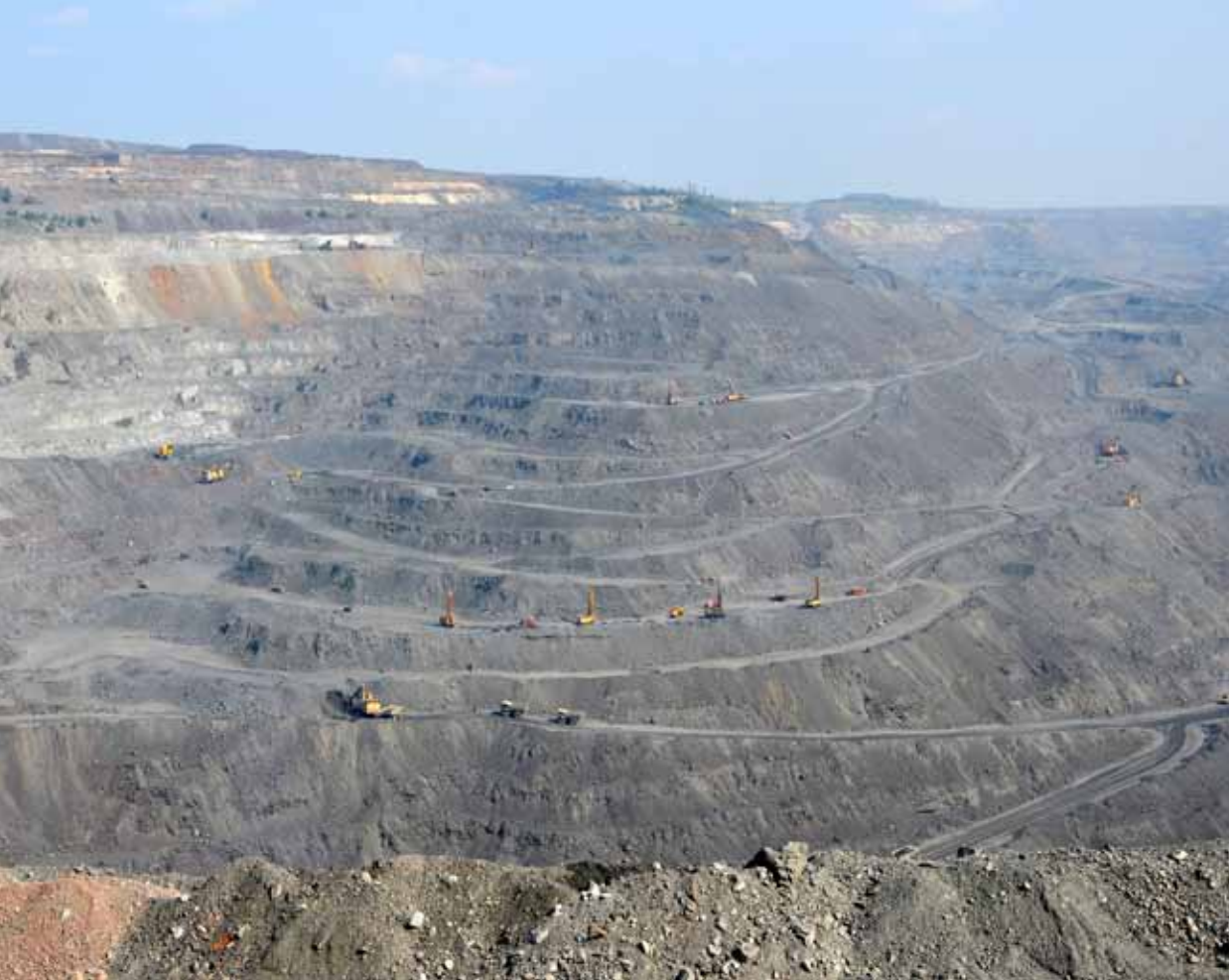
通向成功的道路：Pit Viper 钻机在 PGOK 矿的 10 m 或 12 m 高的台阶上工作。在《采矿与建筑》采访期间，PV 钻机平均每个月能钻 6,500 m 深的孔。
