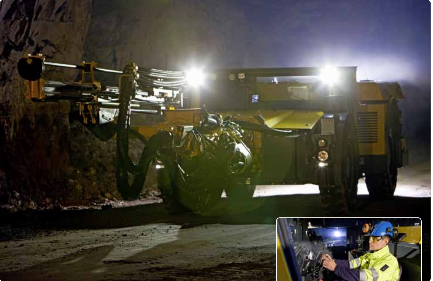
低くて強い: 新型ブーマーM1Lはルーフ高さ2.2~2.5mのピラー採鉱用に開発されました。頑丈でサービスが簡単なのが特長です。
