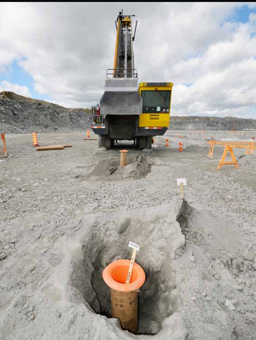
マラルティック鉱山で216mm (8.5インチ) の垂直孔をせん孔するPit Viper 235
