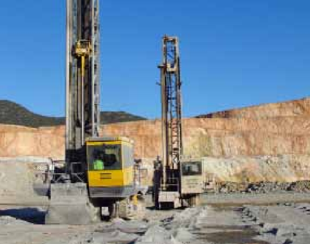
Buen equipo de trabajo: El Pit Viper PV-235 fue entregado a mediados del 2011 y junto a dos equipos DM45 ayudó a completar 650.000 metros de perforación en 11 meses.
