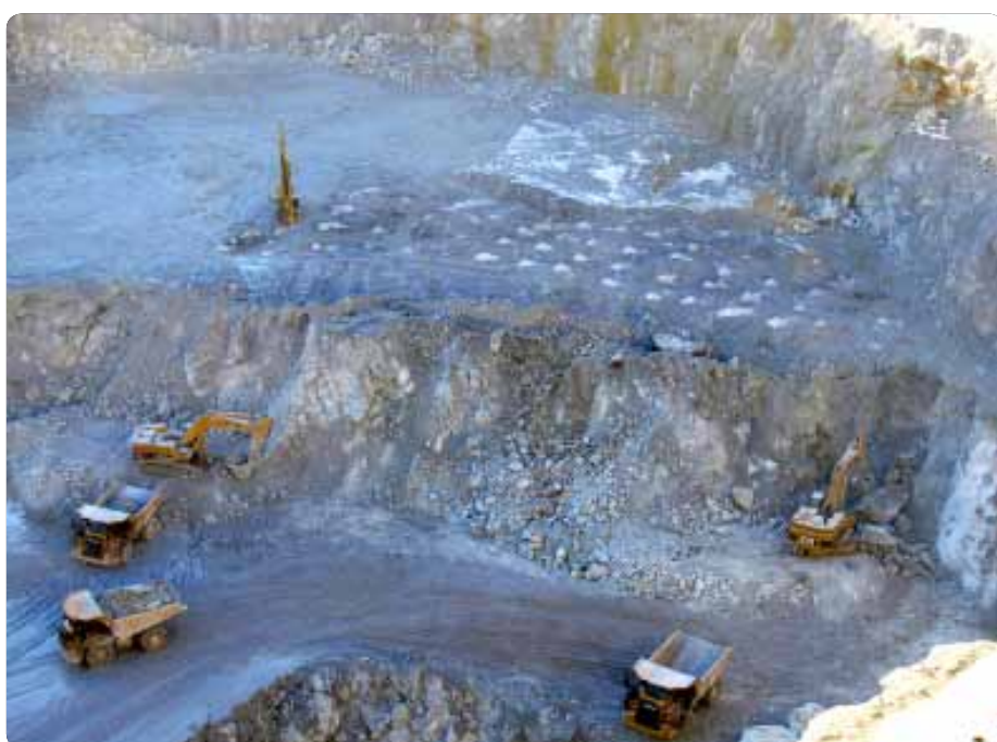
A pleno: Los equipos de Atlas Copco son usados en todas las fases de la operación en el pit Murgul, de la perforación al transporte. Aquí, los bancos tienen 10 m de altura y son perforados con 2 m de sub-perforación con un diagrama 4 x 4 m en mineral y 5 x 5 m en estéril.
