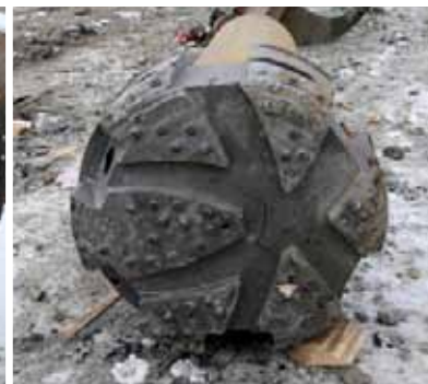
Siguiendo las agujas del reloj, desde la izquierda: Soldando la zapata del tubo de revestimiento con su broca anular sobredimensionada antes de perforar; alineando el sistema de enganche de la pared del tubo; la sarta de perforación interior retirada después de la instalación de los tubos.
