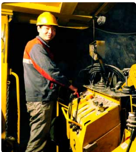
Operación sencilla: Wen Tao Li mantiene trabajando simultáneamente las tres perforadoras COP 1838 del Boomer 353 E.
