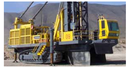
Destinado a Kathu: The Pit Viper 351 para la perforación de pozos de 16 pulgadas.
