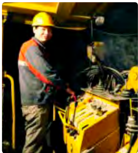
操作简便:李文涛在Boomer 353E凿岩台车上能同时操作3台COP 1828凿岩机。
