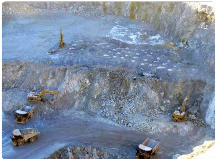
全力生产：在Murgul露天矿，阿特拉斯·科普柯的设备可以用于生产的各个阶段，从钻孔到矿石运输。这里的台阶高度为10米，超钻2米，在矿石中的布孔是4x4米，在废石中的布孔是5x5米。
