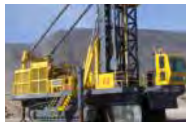
开往Kathu: Pit Viper 351最大钻孔直径为406毫米(16英寸)。
