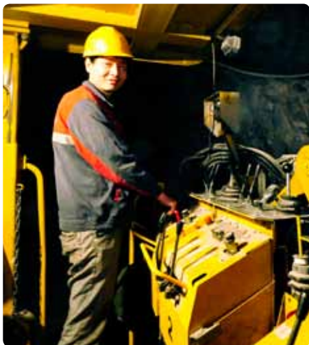
Простая работа: на станке Voomer 353 E Вэн Тао Ли одновременно управляет тремя перфораторами COP 1828.
