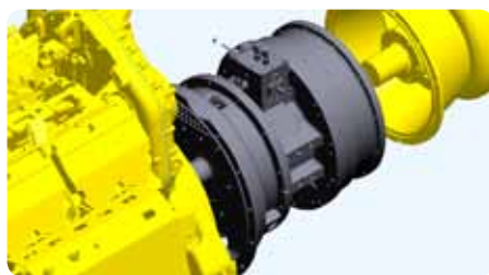
Система автоматического сцепления (патентуемая), поставляемая в качестве опции для отдельных буровых станков для взрывных скважин. Справа: станок с такой системой использует сжатый воздух для бурения и очистки скважины (желтые стрелки).
