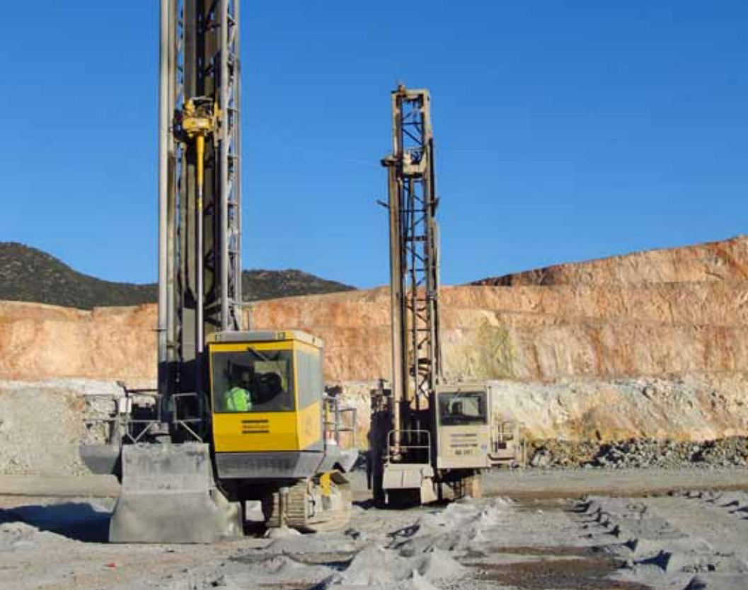
Работа бригады: Pit Viper PV-235 прибыл в середине 2011 г и работает вместе с двумя станками DM45. Это и его вклад в отбуривание 650 000 м за 11 месяцев.
