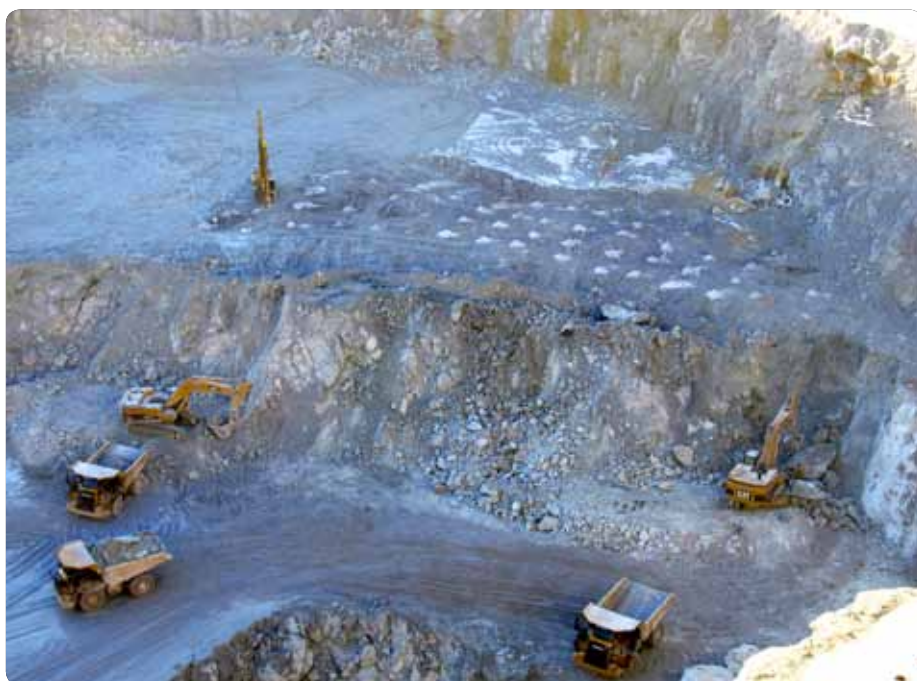
Полным ходом: оборудование Atlas Copco используется на всех стадиях работ в карьере Мургул – от бурения до откатки. На 10 м уступа сетка бурения по руде 4 x 4 м с 2-х м перебуром и 5 x 5 по вскрыше.
