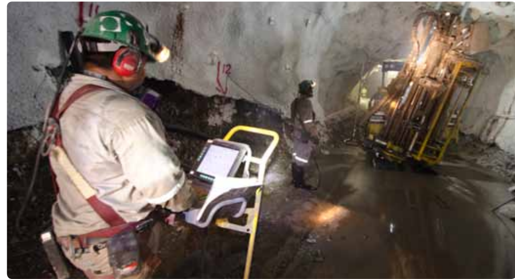
Una amplia gama de equipos en la obra: El equipo de perforación de pozos largos Simba M4 C ITH con su consola de control remoto para posicionamiento y perforación de producción.
