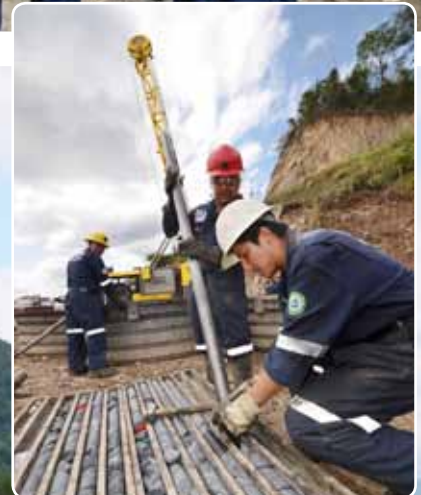
Perforación de núcleo en las hermosas montañas de Molango con equipos Atlas Copco: A la derecha, Carlos Cuellar sostiene el tubo mientras Pablo Guzmán retira una muestra de núcleo y la coloca en la caja.
