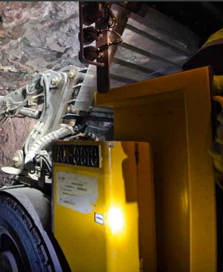
En los controles: Durante la visita de M&C un operador de Scaletec mostró cómo se usa el equipo para sanear las paredes en las galerías y remover piedras sueltas en las gradas.
