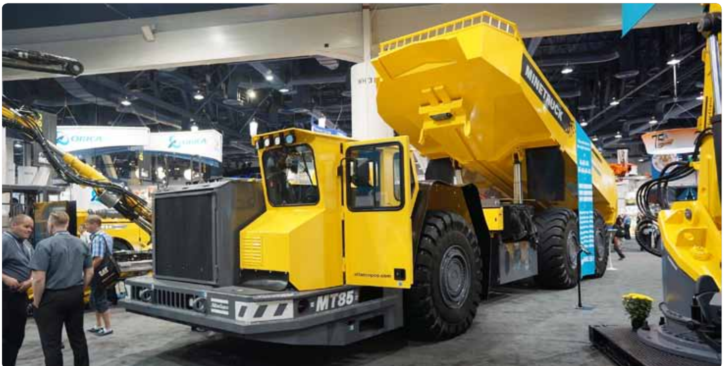
El primero del mundo en la MINExpo: El nuevo Minetruck MT85, que será introducido en el mercado en 2014, tiene una capacidad de 85 toneladas y está diseñado para aumentar la productividad en operaciones subterráneas al mismo tiempo que mejora la seguridad y protege el medioambiente.
