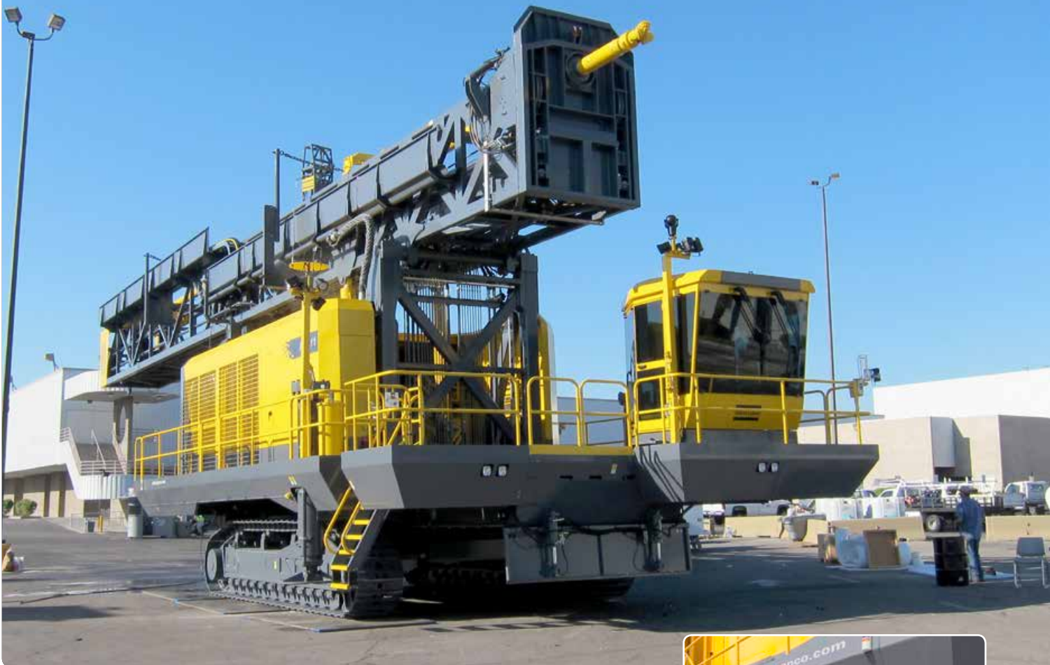
上图是装有钻机控制系统的标准型 PV-311 钻机在 MINExpo 2012 初次登场前的情景。它能让客户从最低的自动化功能开始入手，并在需要时增加新的自动化功能。钻机自动控制系统还为钻机提供几种安全连锁装置，保护操作手和设备的安全。
