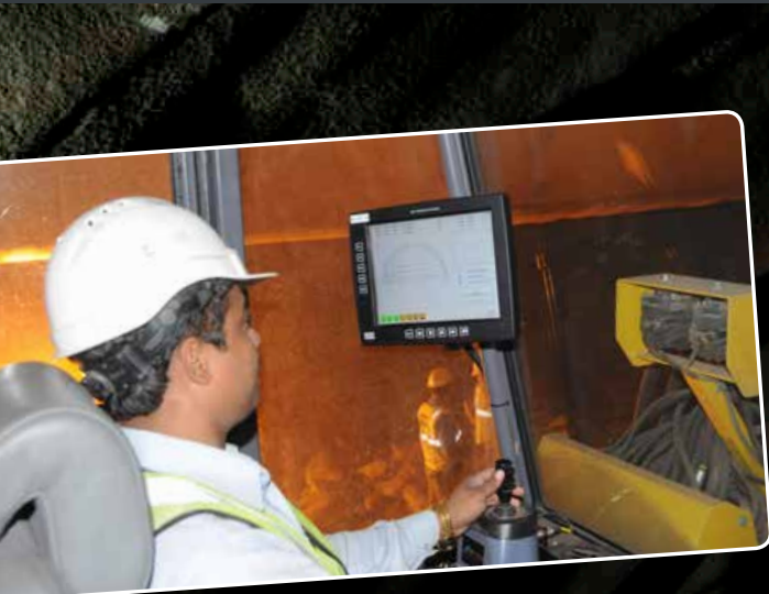
在 Boomer XE3 C 司机室内:全部钻孔布置信息方便地显示在屏幕上,保证精确和高效钻孔。
