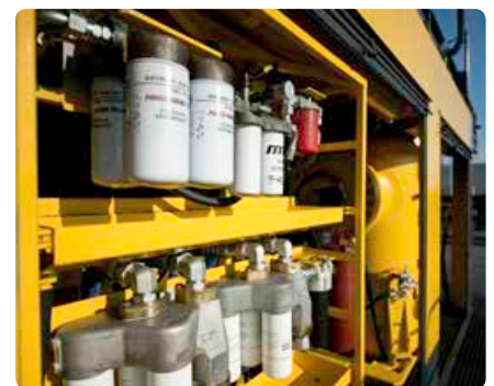
容易保养和维护：上图是 PV-311 钻机的近地保养点，下图是易接近的滤清器排架。
