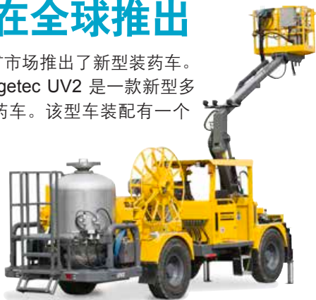
Chargetec UV2:同类装药车中技术最先进的产品之一，并且配有新一代容器。
