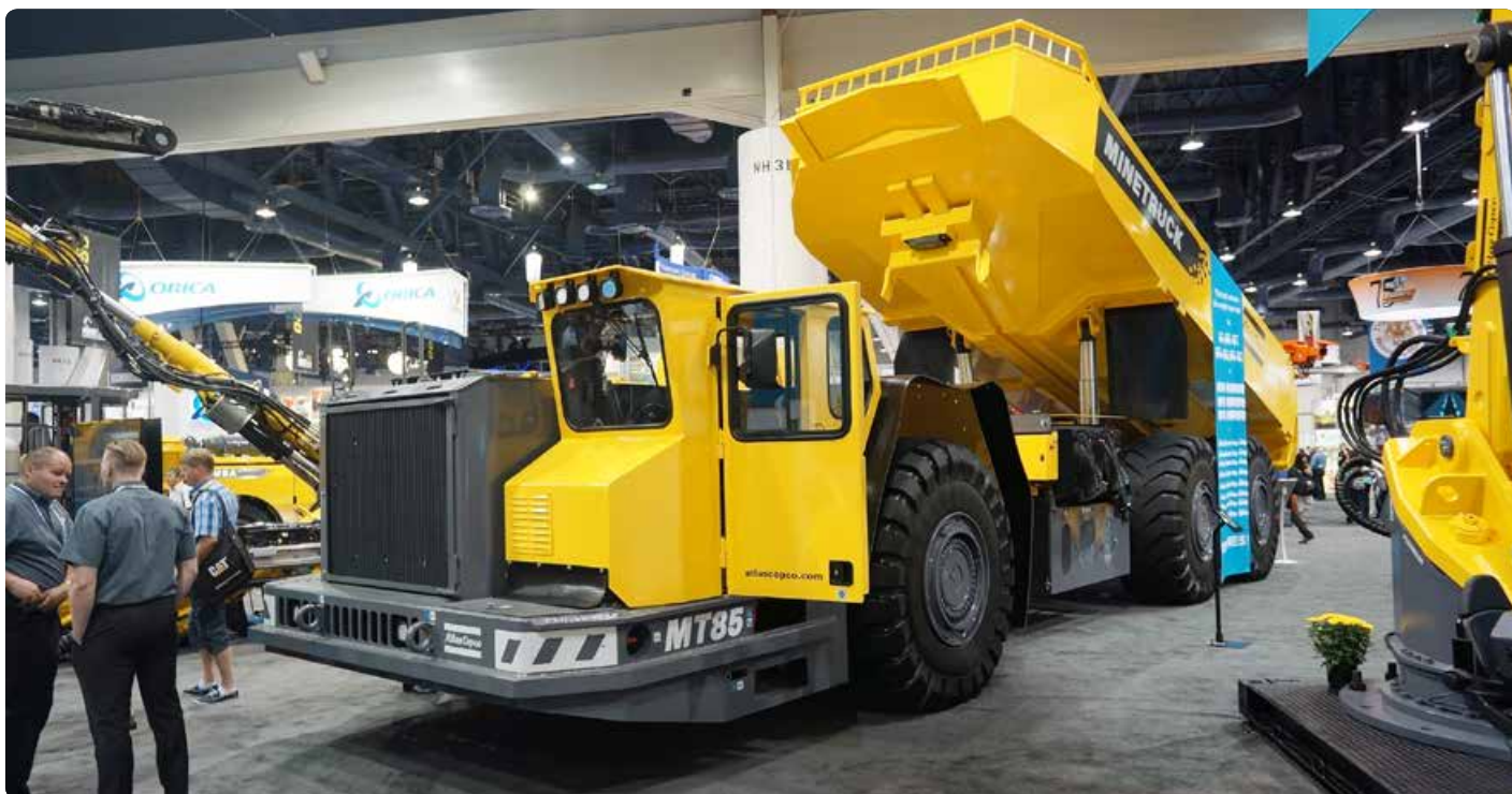
世界上第一台 MT85 型卡车：将在2014年推出的 Minetruck MT85 卡车的载重量为85吨，是为提高地下采矿的生产率而设计的，同时具有更高的安全性和环境保护能力。
