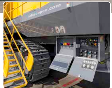
上图是装有钻机控制系统的标准型 PV-311 钻机在 MINExpo 2012 初次登场前的情景。它能让客户从最低的自动化功能开始入手，并在需要时增加新的自动化功能。钻机自动控制系统还为钻机提供几种安全连锁装置，保护操作手和设备的安全。
