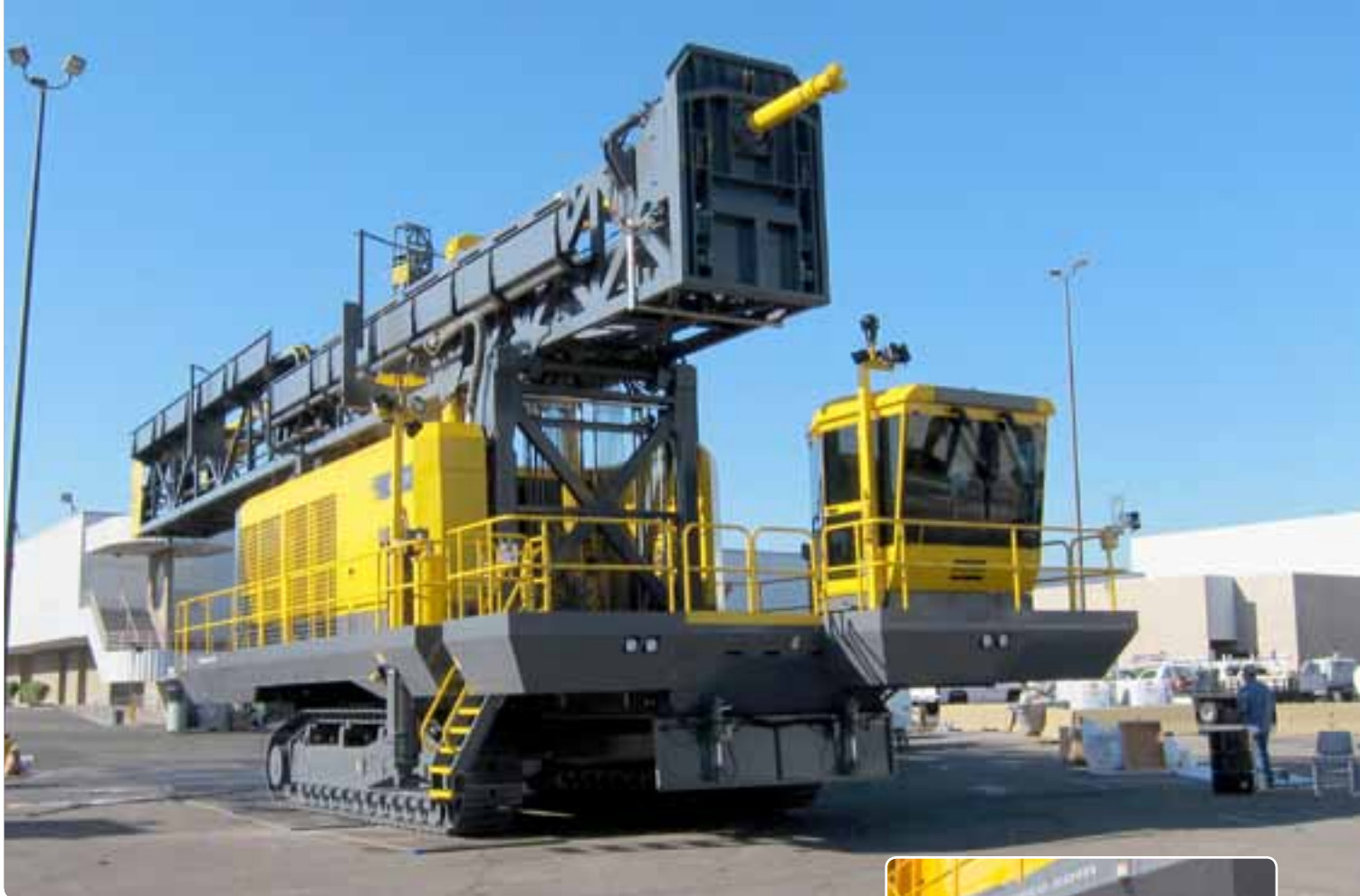
PV-311 перед презентацией на MINExpo 2012 стандартно укомплектован системой RCS Basic. Заказчик может начать с низкого уровня автоматизации, позже добавив новые функции. RCS также обеспечивает станок рядом защитных блокировок, что делает безопасной работу оператора и оборудования машины.
