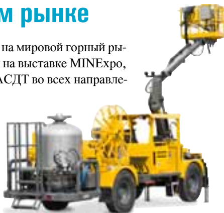
Chargetec UV2: один из наиболее технически совершенных этого типа, комплектуется емкостями последнего поколения.
