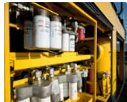
Удобство сервиса и ТО: (сверху) зона доступа Pit Viper 311 с уровня земли, (ниже) доступ в блок фильтров.
