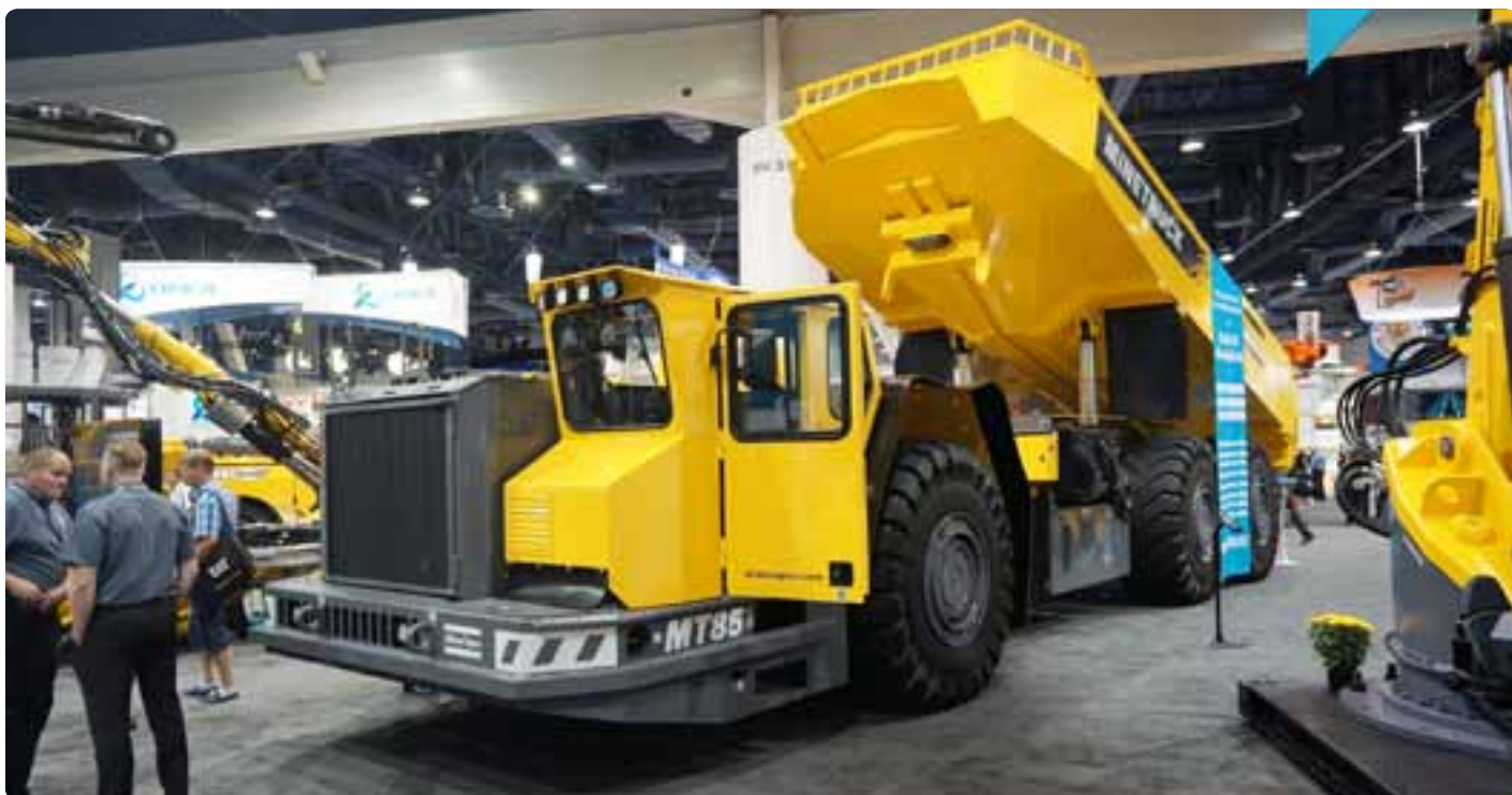
Впервые в мире на MINExpo: новый Minetruck MT85, который выйдет на рынок в 2014 г, имеет грузоподъемность 85 т и сконструирован для повышения производительности подземных работ, одновременно повышая безопасность и экологичность.
