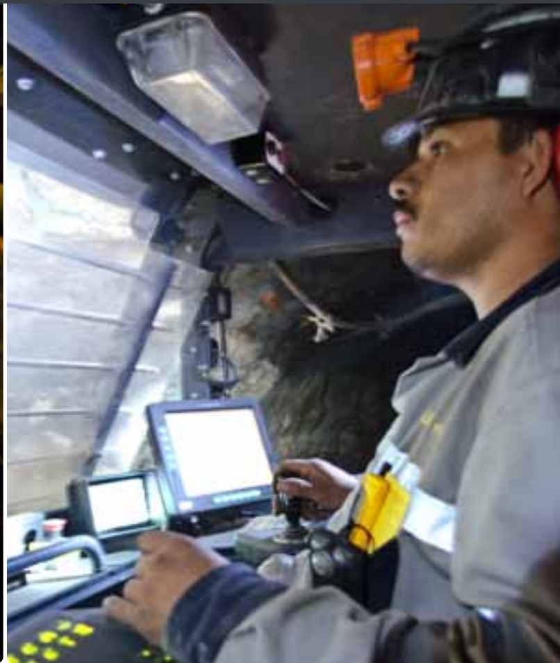
За управлением станка: оператор станка Scaletec показал нам, как используется машина для оборки бортов и кровли в новых выработках.
