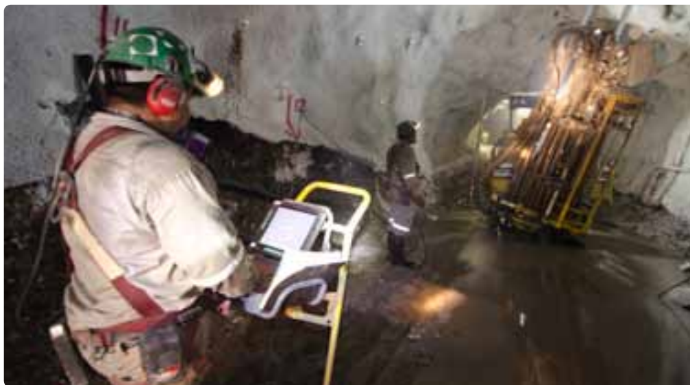
Оборудование на площадке: станок добычного бурения с отбойкой глубокими скважинами Simba M4 C с ППУ и с консолью дистанционного управления для позиционирования и бурения.
