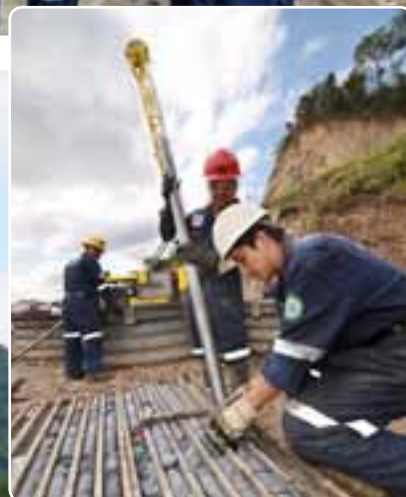
Колонковое бурение станками Atlas Сорсо в горах Моланго: (правее) Карлос Куэлар держит трубу, а Пабло Гузман извлекает образец керна и укладывает его в ящик.
