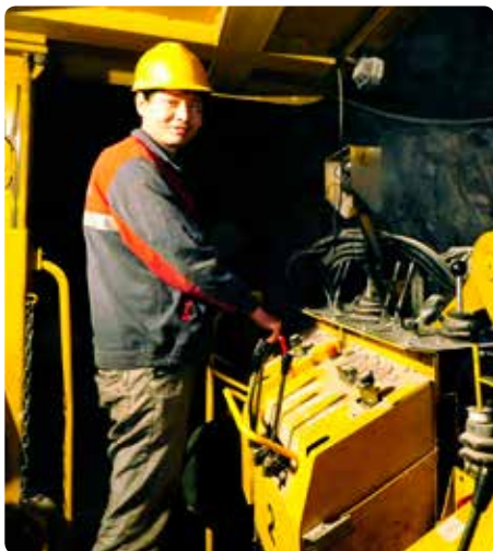
操作は簡単:Boomer 353 E に搭載された3台のCOP 1838を同時に操作するウェン・タオ・リーさん。
