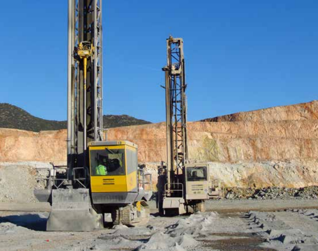
最強のコンビ: Pit Viper PV-235(上)は2011年半ばに搬入され、DM45とともに11ヶ月間で650kmのさく孔を行ないました。
