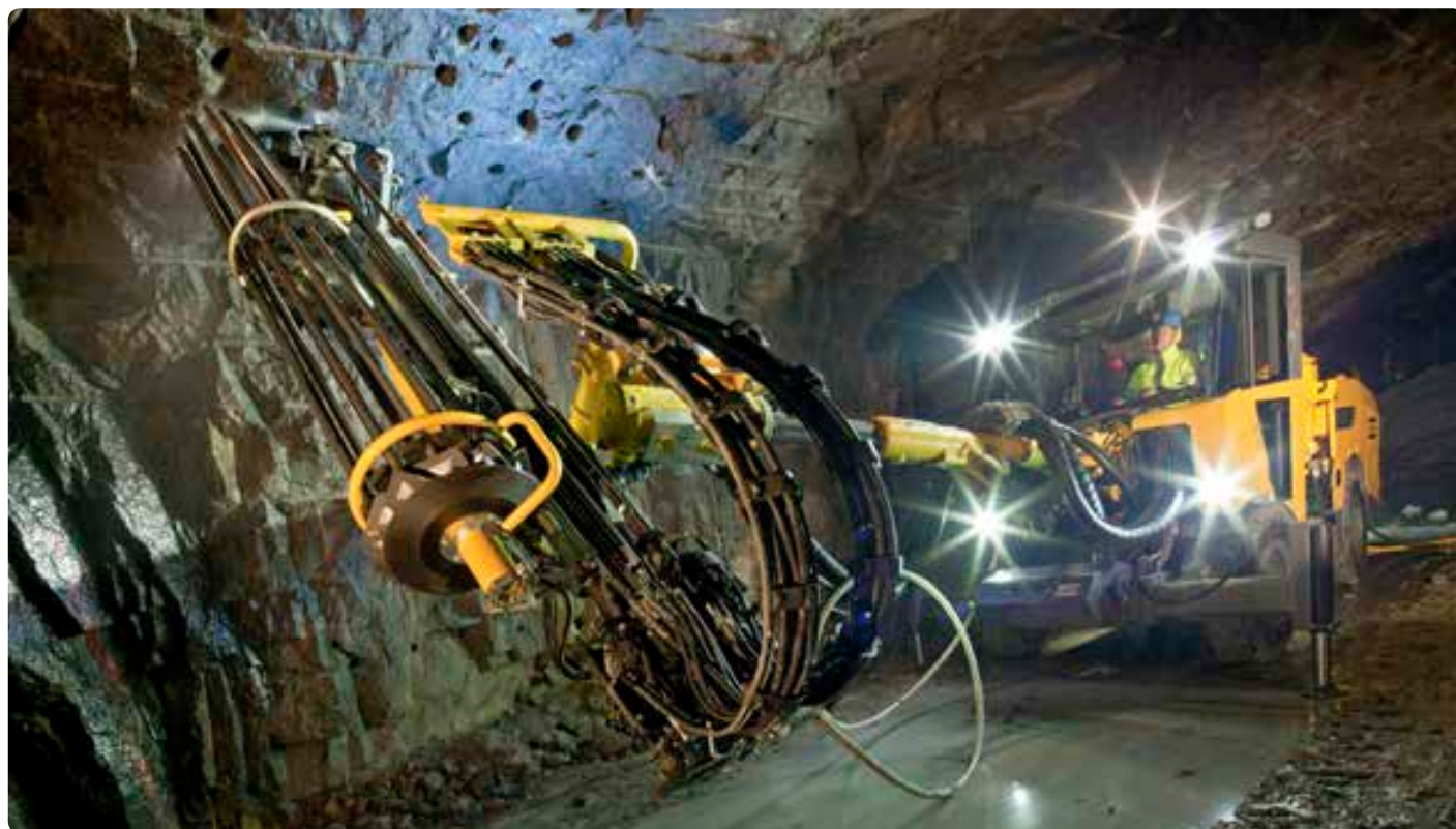
为中小型隧道和巷道而设计的全新Boltec S：适合安装长度为1.5-2.4m的锚杆，安全可靠。
