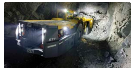
Scooptram ST7：一种可以配备康明斯Tier 4i发动机的阿特拉斯·科普柯铲运机。
