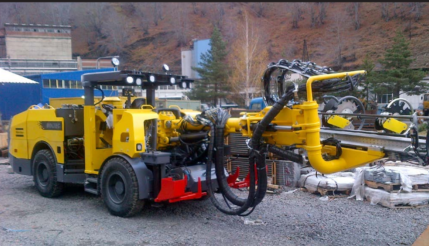
新成员：目前，这台崭新的锚杆台车已经被送往Sasa的工地，这款名为Boltec S的锚杆台车代表了锚杆支护领域的最新技术（见11页），并且被列入矿山与阿特拉斯·科普柯签订的全程服务协议当中
