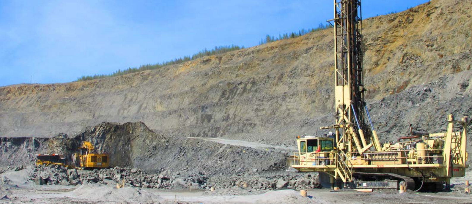
攻坚克难：该矿山拥有一批阿特拉斯·科普柯多杆成孔钻机Pit Viper 275，最近又购买了一台新的，用于在岩石异常坚硬的地方钻孔。
