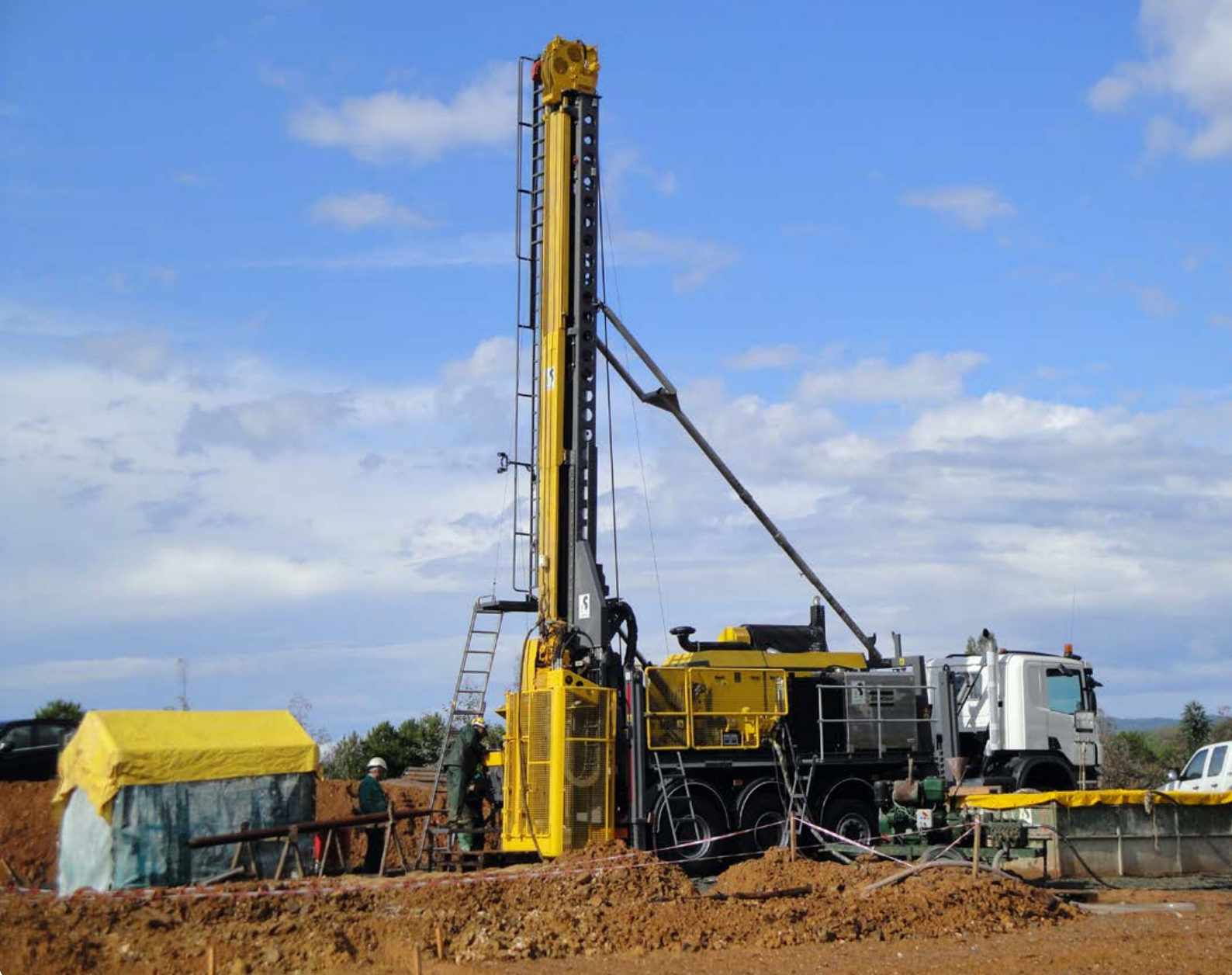
阿特拉斯·科普柯勘探钻机Christensen CT20：最初，这款钻机在西班牙南部的Rio Tinto矿山中并没发挥到其最好的性能，但是经过改进钻进参数和对员工的培训后，结果超出了预期。
