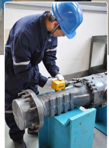
这是一台即将被拆卸接受检查的Boomer凿岩台车车轴。
