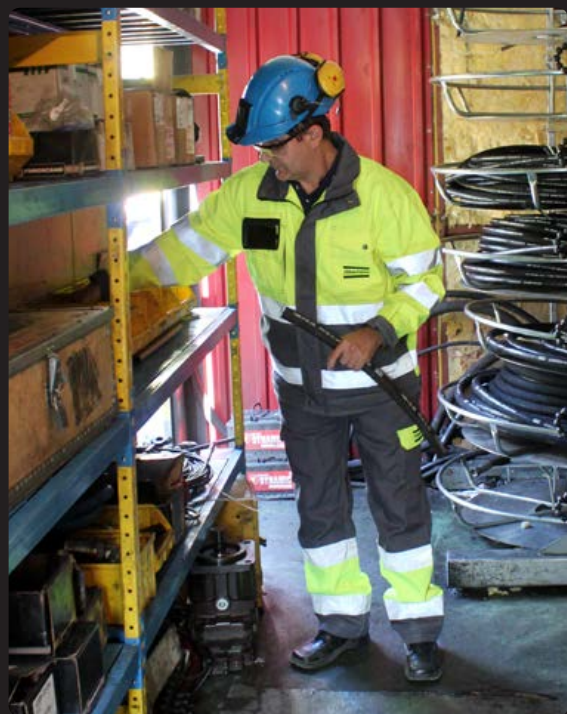
随时可得正品配件：现场软管车间组装的阿特拉斯·科普柯原厂软管。该策略是Sasa矿山确保设备可用性的关键因素。
