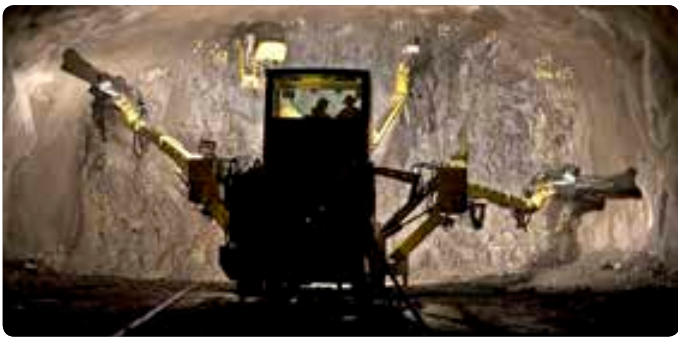
一个强大的团队：在挪威公路-铁路隧道项目中使用的6台Boomer XE3 C凿岩台车
