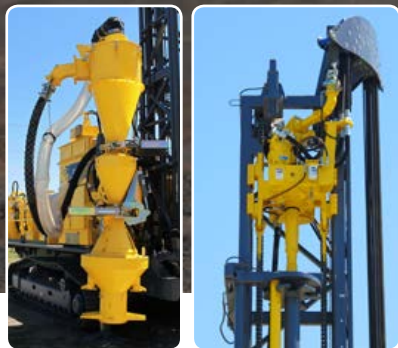
旋流式取样系统（左）和回转头转换系统及软管架（右），都是反循环装置的标准特征。
