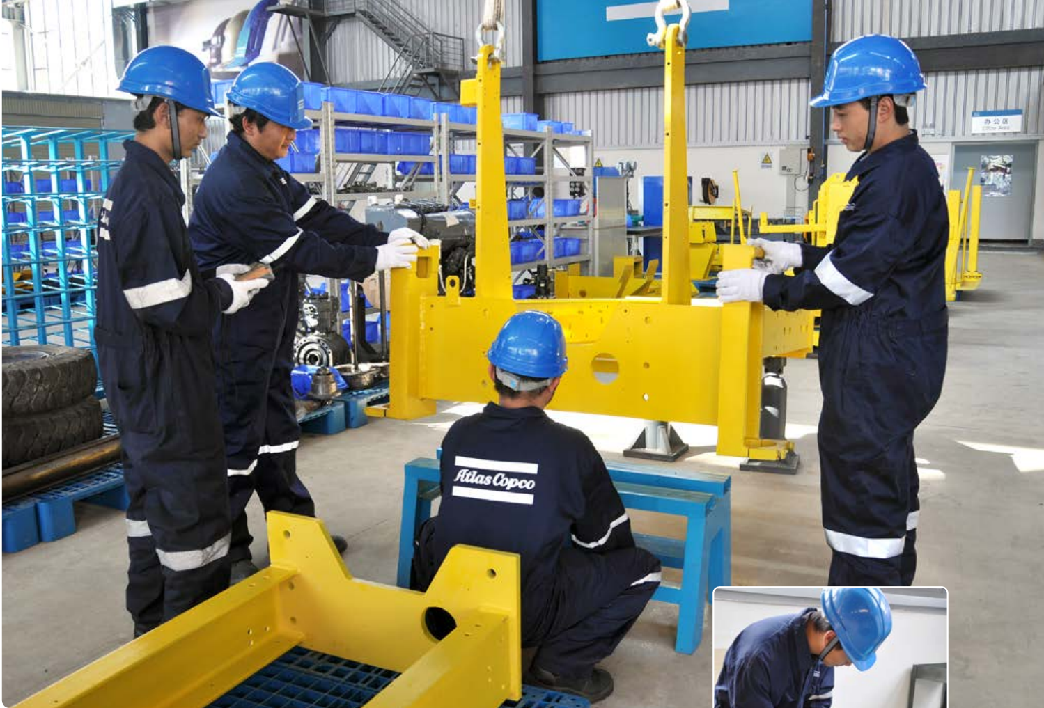
昆明再造中心的技术人员正在组装一台Boomer 281凿岩台车的主车架。
