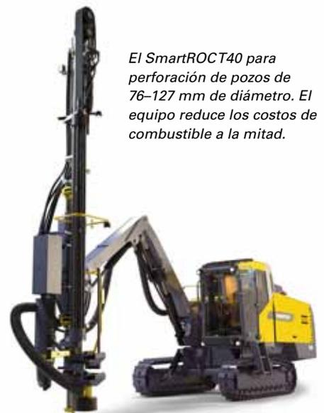
*El SmartROCT40 para perforación de pozos de 76–127 mm de diámetro. El equipo reduce los costos de combustible a la mitad.*
