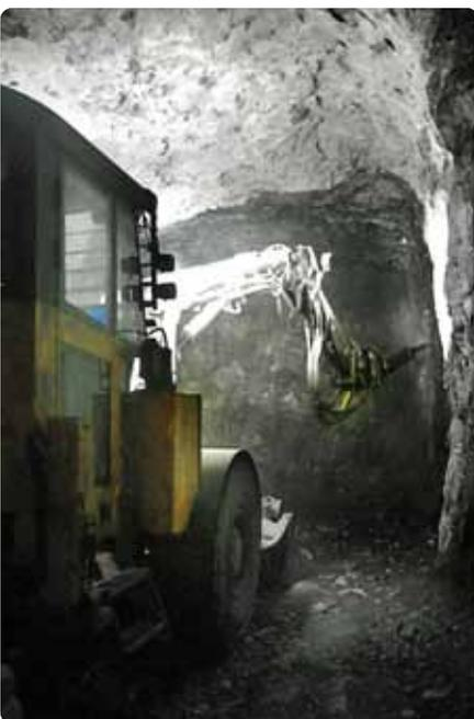
Una alternativa segura: El equipo Scaletec, usado rutinariamente para desincrustado en la Mina Tara.
