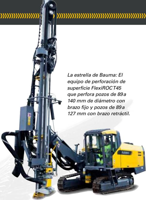
*La estrella de Bauma: El equipo de perforación de superficie FlexiROCT45 que perfora pozos de 89 a 140 mm de diámetro con brazo fijo y pozos de 89 a 127 mm con brazo retráctil.*
