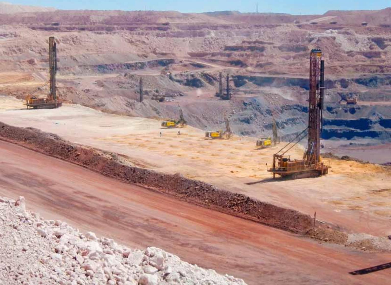
*Panorama de la gigantesca mina "open pit" Sishen: Equipos Pit Viper 351 perforan los pozos de voladura mientras que equipos ROC L8 se encargan de la perforación de cresta en la mina Sishen.*
