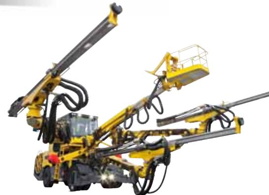
*El Boomer XE3 C: Computarizado e imbatible para abrir túneles viales y ferroviarios. En Bauma se presentará con la perforadora COP 4038.*
