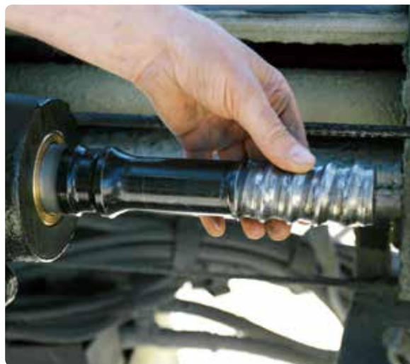
全面改善：螺纹磨损降低，钎杆拆卸简便，钎杆转换工作量更少，使得钻孔工作更为简单、高效。
