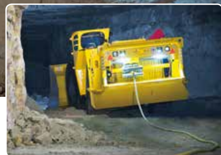
引领装载作业进入新阶段：新款Scooptram EST1030电动铲运机拥有10吨的有效装载能力，在大幅提高环境效能的同时，为用户带来了出众的生产效率。
