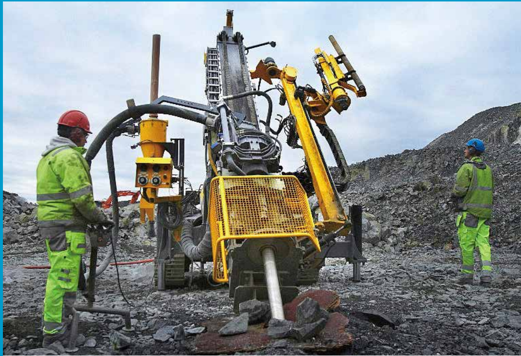
致力于反循环钻探技术的开发：新款 Explorac 100 型钻机设计紧凑，动力强劲，配备有一套自动换杆系统，有利于保护现场人员的安全。
