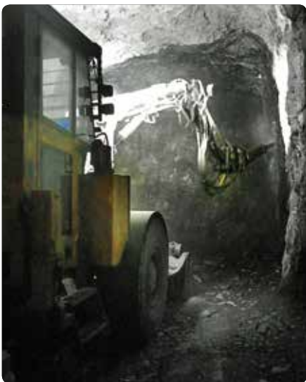
安全的选择：Scaletec撬毛台车现在已经成为塔拉矿撬毛作业的标准设备。
