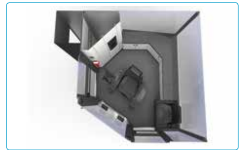
安装具有RCS控制系统的铲斗式座椅，同时配备一个见习座位。从今年8月份开始交付的PV-351钻机将配备新驾驶室。
