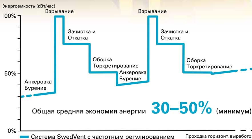
Рис. 1. При проходке обычные системы вентиляции работают на полную мощность. Система SwedVent с частотным регулированием выходит на полную производительность только при необходимости, напр. после взрывания. По мере проходки потребление воздуха возрастает, но в целом 30-50% обычно потребляемой энергии экономится, снижая общую стоимость проекта.
