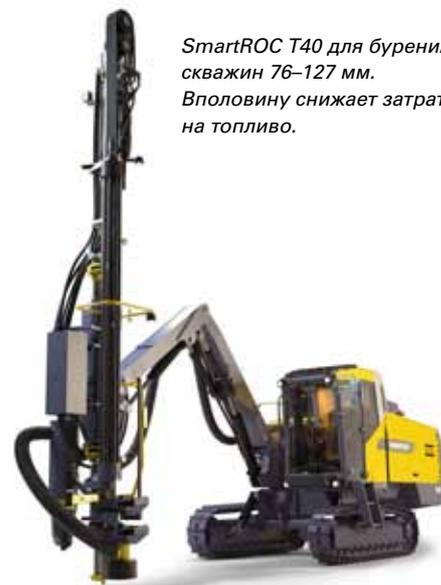
SmartROC T40 для бурения скважин 76–127 мм. Вполовину снижает затраты на топливо.
