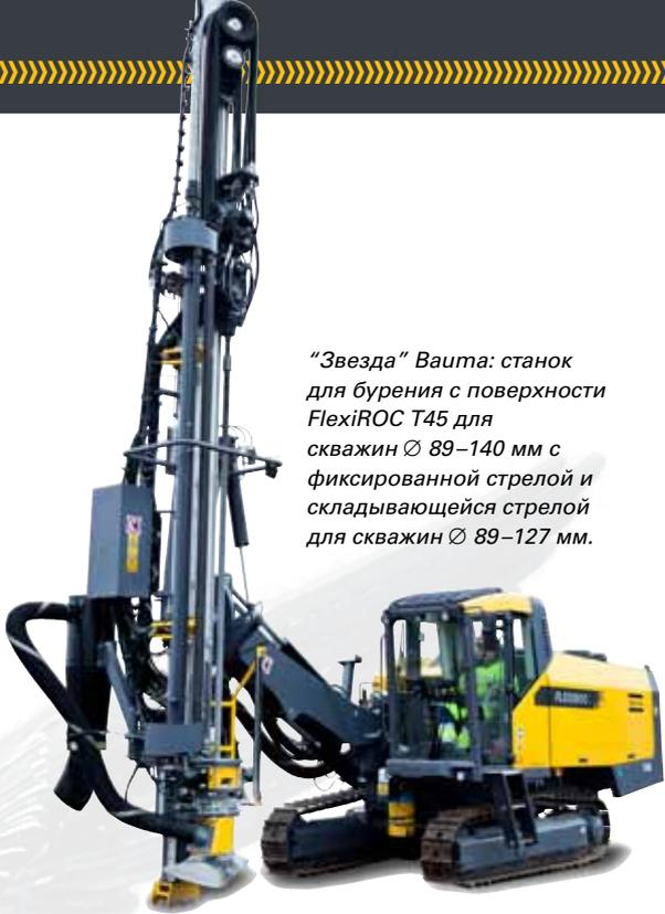
“Звезда” Ваума: станок для бурения с поверхности FlexiROC T45 для скважин  $\varnothing$  89–140 мм с фиксированной стрелой и складывающейся стрелой для скважин  $\varnothing$  89–127 мм.
