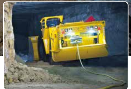
積込作業のレベルがさらに向上：10トンの積載能力を持つ新型スクープトラム EST1030 は環境対応と生産性をさらに向上させました
