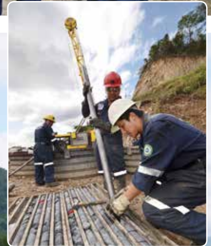
モランゴの美しい山でコアドリル作業中のアトラスコプコ ドリルリグ:カルロス・クエジャルさんがロッドを支え、パブロ・グスマンさんがコアサンプルを取り出し、箱に納めています。
