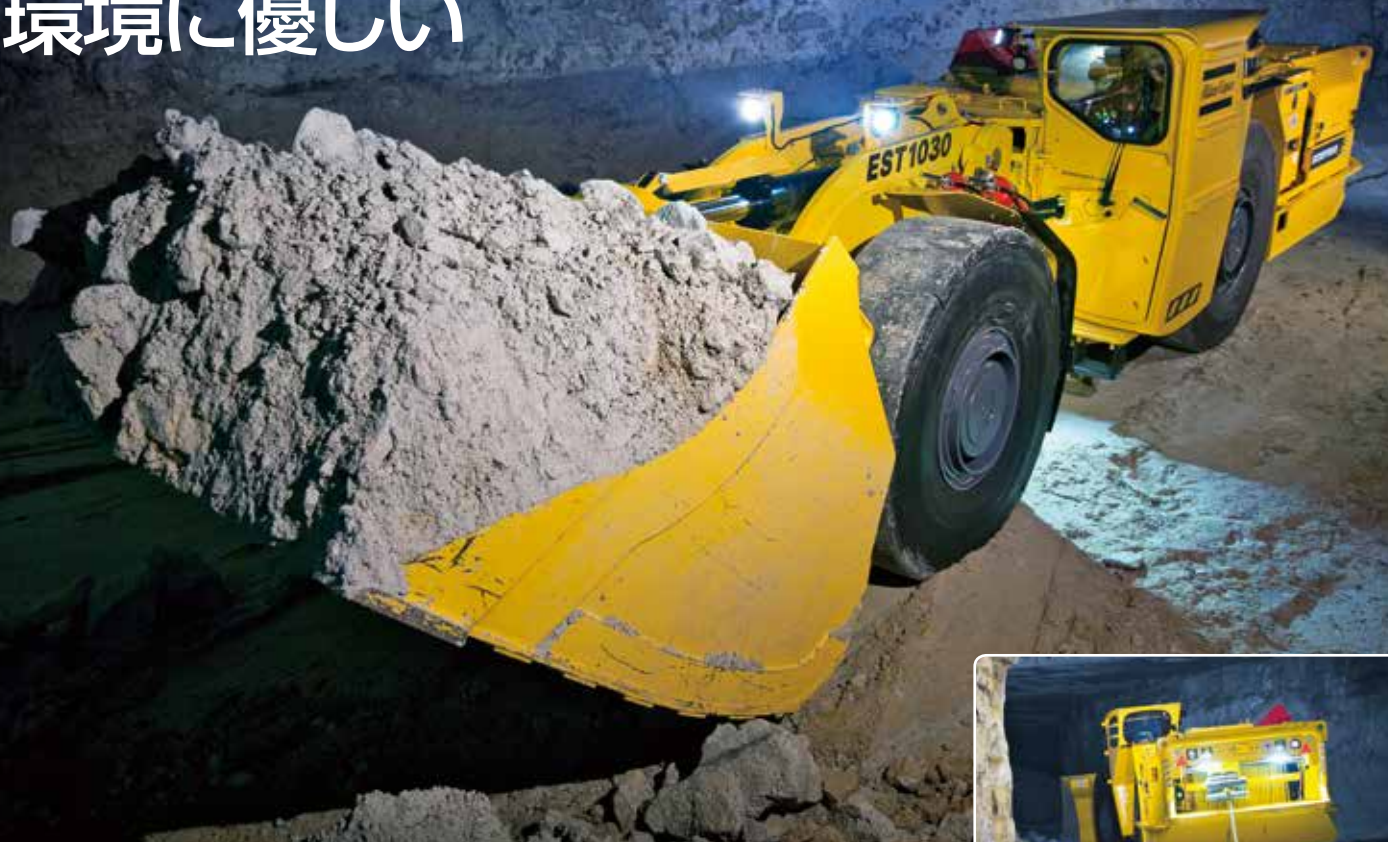
積込作業のレベルがさらに向上：10トンの積載能力を持つ新型スクープトラム EST1030 は環境対応と生産性をさらに向上させました
