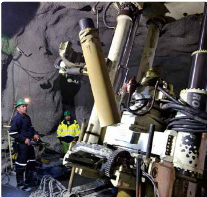
生産性を高めているフレズニーリョ: アトラスコブコレイズボーラー ロビンス 34RH C QRSは地上で組み立てられ、地下で稼働されます。
