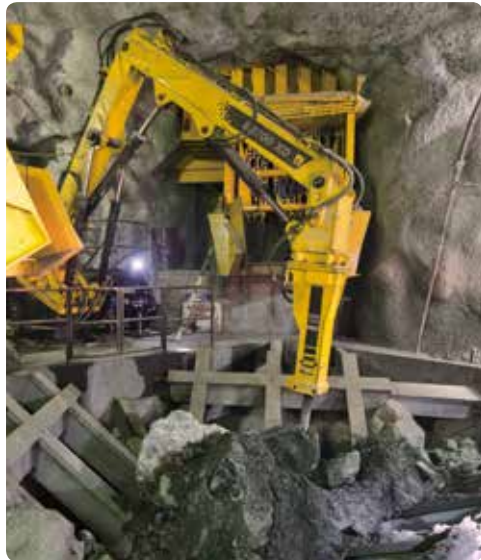
ブレーキングニュース: 破碎帯で稼働するブレーカ RB700 XD
