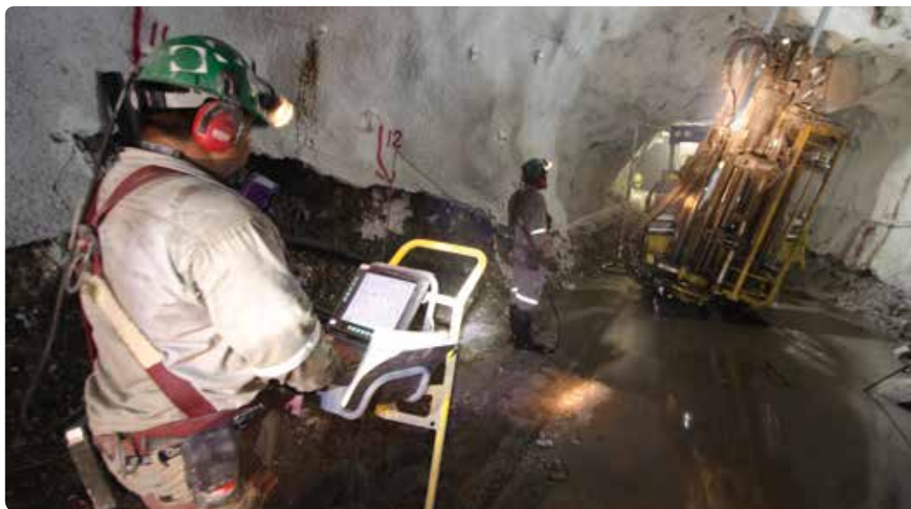
幅広い製品がある現場:位置決めと生産ドリリング用のリモートコントロール付きの長孔さく孔用リグ シンバ M4C ITH
