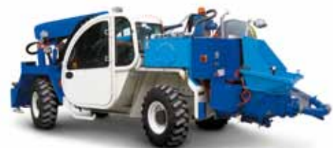
Poca: La unidad móvil más compacta en el mercado para proyección profesional de concreto.
