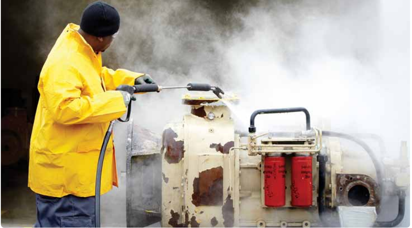
Remanufacturando en USA: El proceso comienza con la limpieza de todos los componentes antes de pasar por las cinco navas de trabajo. Los procedimientos y procesos desarrollados en Garland establecen el estándar para los Centros Remán de Atlas Copco en todo el mundo.
