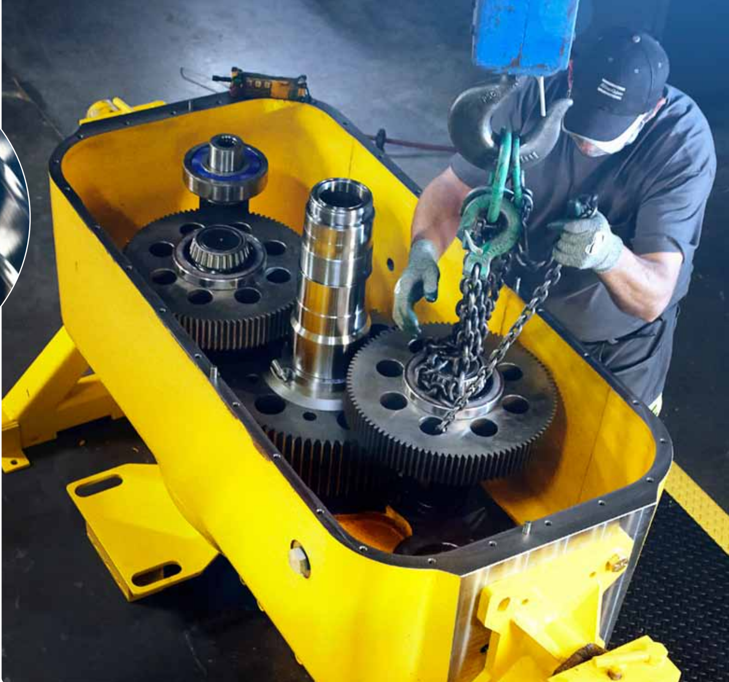
Remanufactura en acción: Esta cabeza rotativa de un Pit Viper 351 será completamente restaurada y rearmada usando partes originales y aplicando las últimas especificaciones de ingeniería y actualizaciones de fábrica
