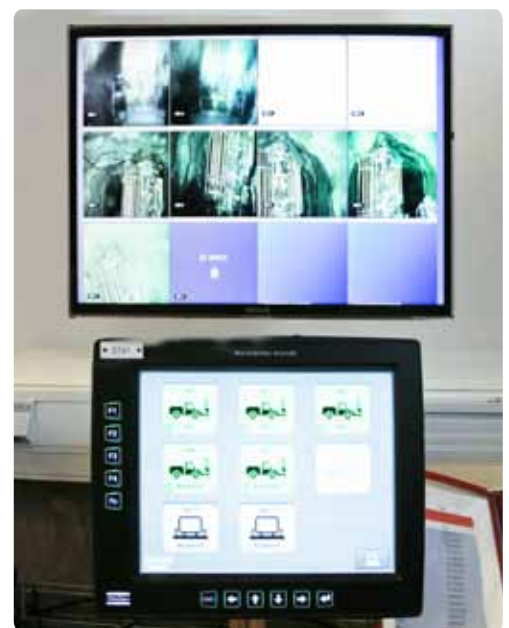
Tecnología de control remoto: Arriba a la izquierda, los planes de perforación para los equipos Simba WL6 C como aparecen en la consola del operador. A la derecha, la configuración de la pantalla que monitorea el progreso de cada equipo en la mina.
