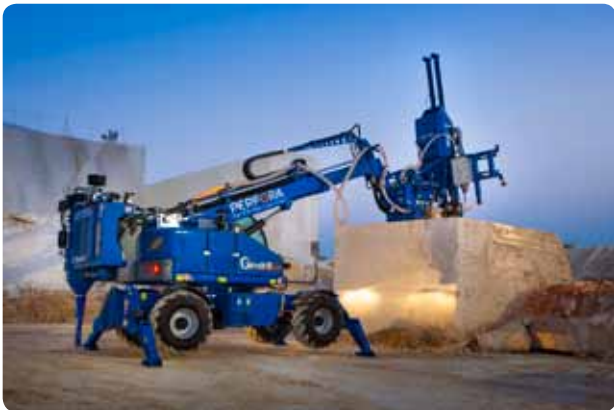
Cuidadosamente seleccionado: El Girodrill EVO perfora un bloque de mármol en la cantera Pinoso en Algueña. Arriba, el Manager de Cantera Jesús Pérez de la Muela (derecha) con Fernando Menéndez, Manager de Línea de Negocios de Atlas Copco en España.
