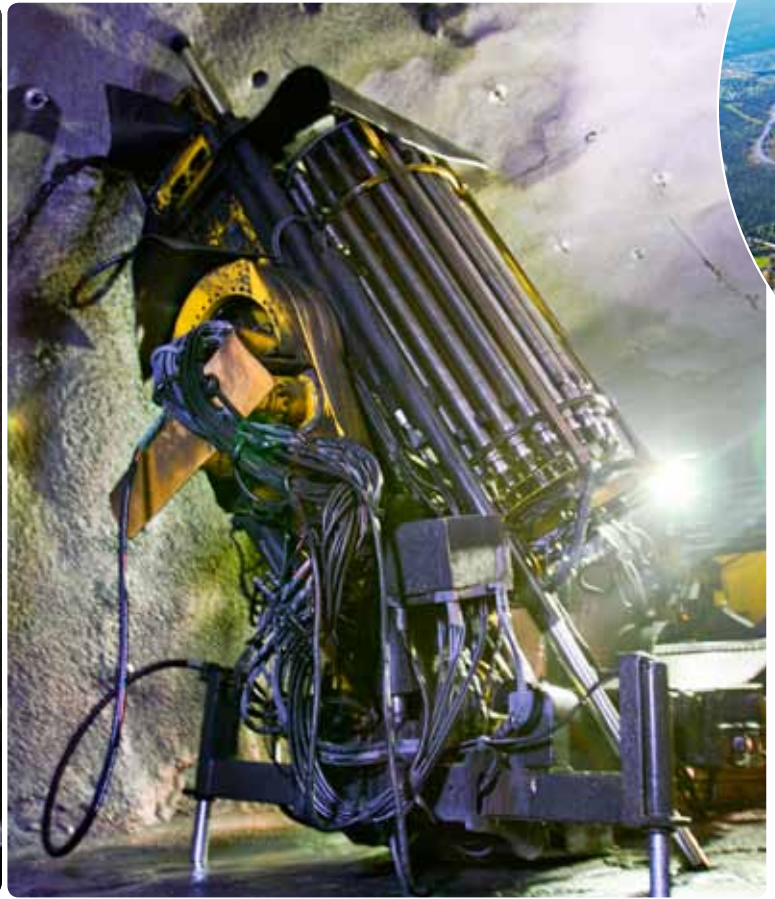
Arriba, el operador Andreas Larsson en una de las pocas ocasiones en que entra a la galería a reponer el equipo para un nuevo abanico de pozos de voladura. A la derecha, el Simba WL6 C en el modo de perforación "full fan", perforando pozos de 30 m de largo en el centro del abanico y pozos de 17 m en los costados.
