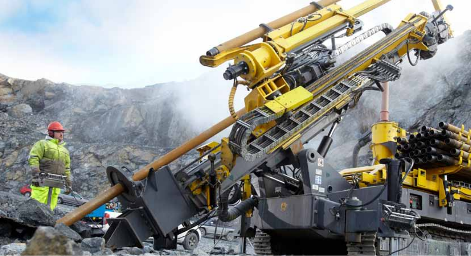
Compacto pero poderoso: El nuevo Explorac 100 realiza perforación CR en la mina Björkdalsgruvan de Suecia, la mayor mina de oro puro en el norte de Europa. El sistema automático de manejo de barras y el panel de control remoto mantiene a los perforistas lejos del peligro.
