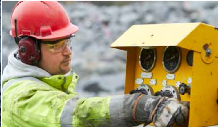
Foto superior: Una caja protectora aumenta la seguridad de los perforistas. Foto inferior: Usando el sistema de drenaje para eliminar el exceso de agua, y así eliminar el riesgo de contaminar las muestras.
