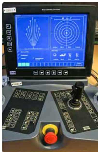
Tecnología de control remoto: Arriba a la izquierda, los planes de perforación para los equipos Simba WL6 C como aparecen en la consola del operador. A la derecha, la configuración de la pantalla que monitorea el progreso de cada equipo en la mina.
