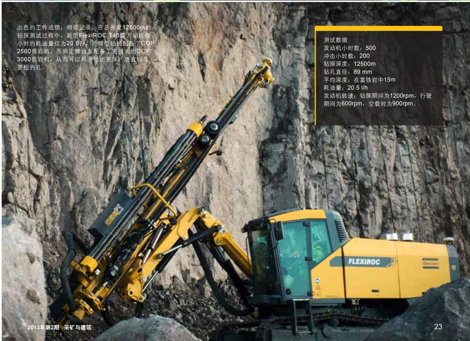
出色的工作成绩：根据记录，在总长度12500m的钻探测试过程中，新型FlexiROC T45露天钻机每小时的耗油量仅为20.5升。折臂型钻机配备了COP 2560凿岩机，而固定臂台车配备了更强大的COP 3060凿岩机，从而可以用于钻出更深、更直以及更粗的孔。
