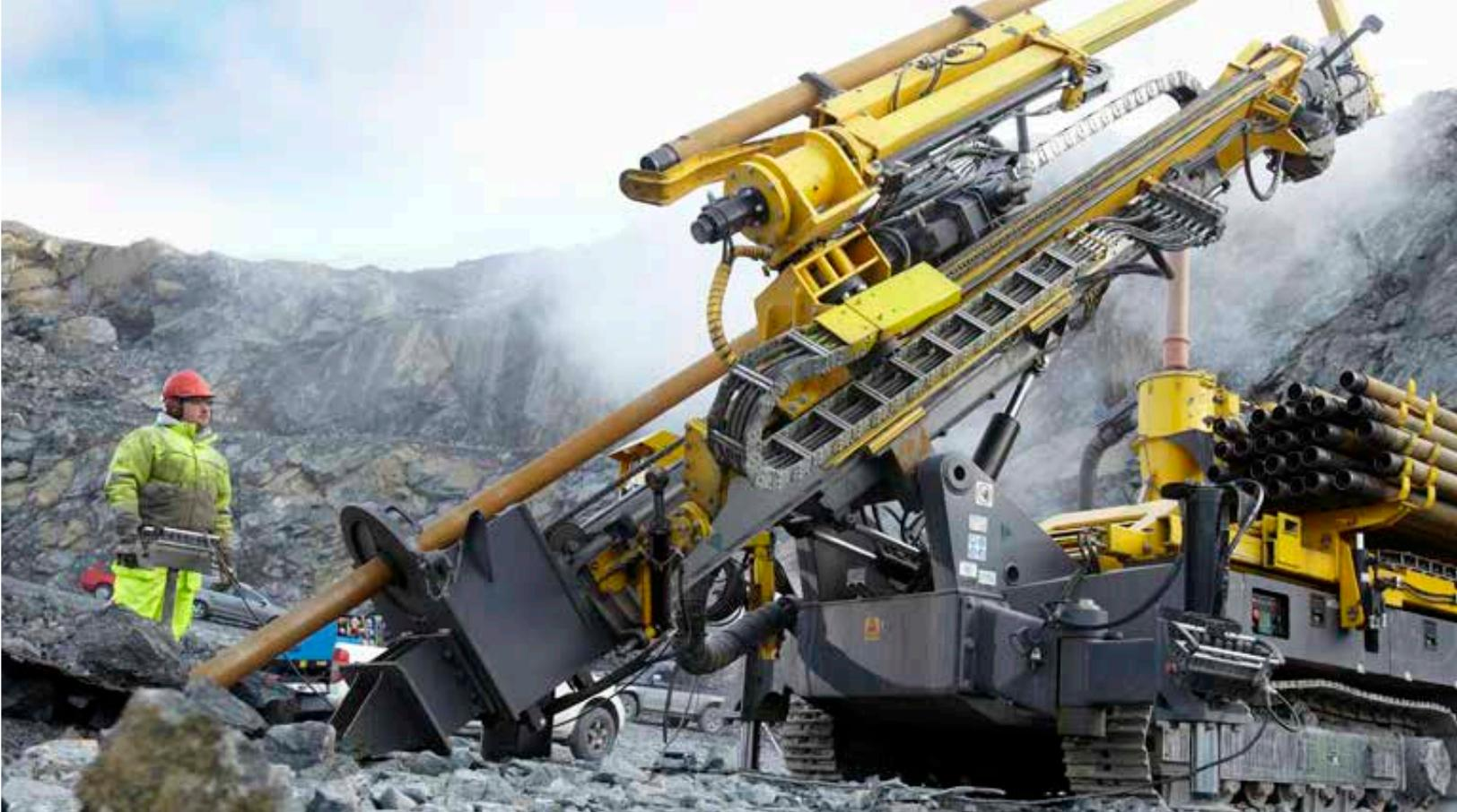
结构紧凑且功能强大：新型Explorac 100钻机在北欧最大的纯金矿——瑞典Björkdalsgruvan进行反循环钻孔。该钻机的钻杆自动化操作系统和电子远程控制面板让钻孔人员远离易于受伤的作业方式。
