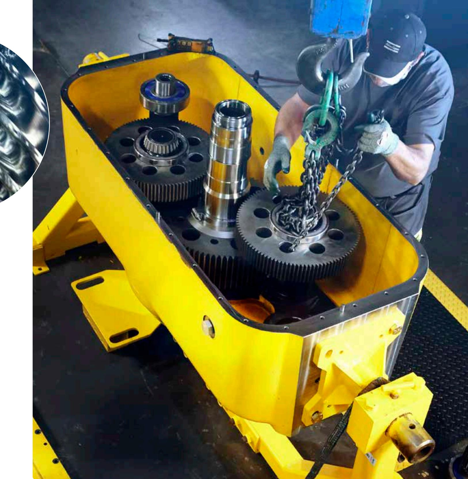
再制造：使用新的正品配件、最新的工程标准和升级的厂房来修复和重新组装Pit Viper 351钻机的回转头。
