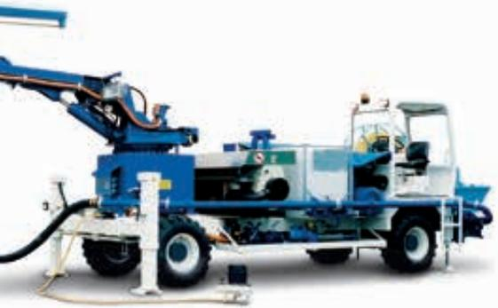
Potenza: 移动式混凝土喷射机
