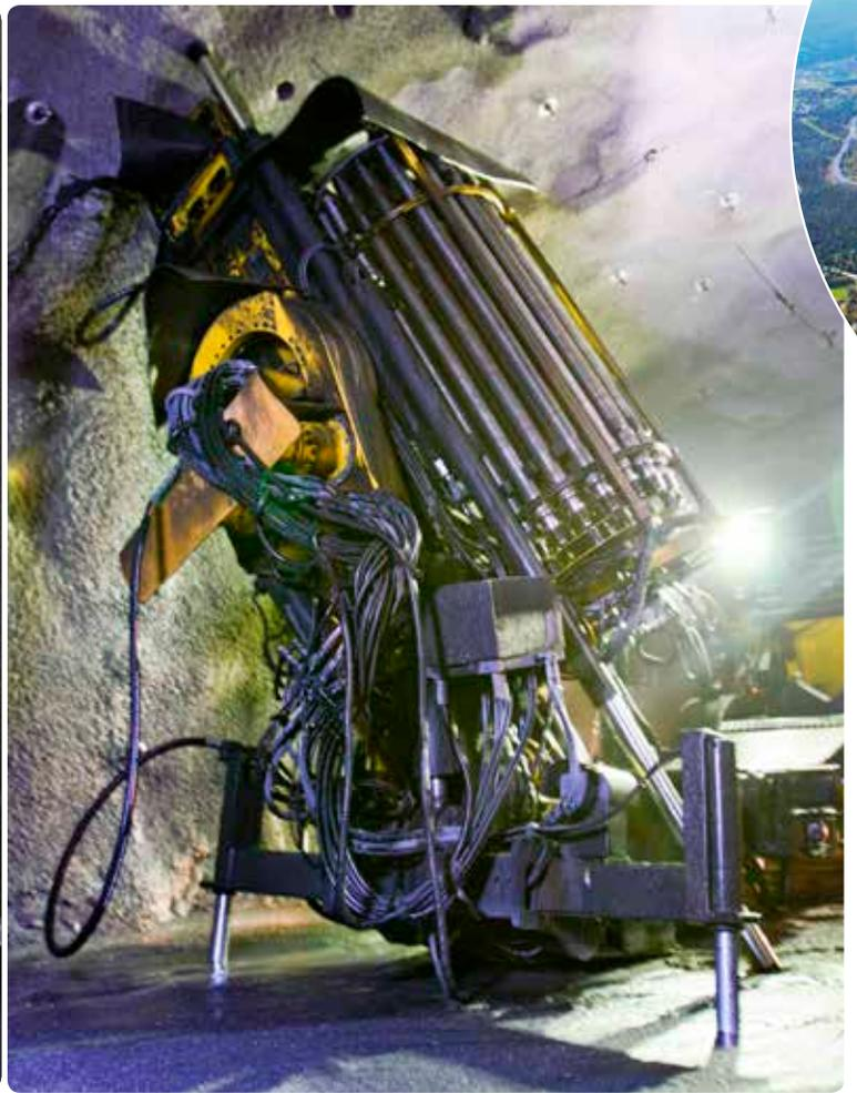
上图是操作员Andreas Larsson进入工作区域对台车的下个爆破孔扇形面进行再定位,当然这属于极个别的情况。右图是处于全扇面钻孔模式下的Simba WL6 C,在扇形面的中间位置钻出30m深的孔,在两侧钻出17m深的钻孔。
