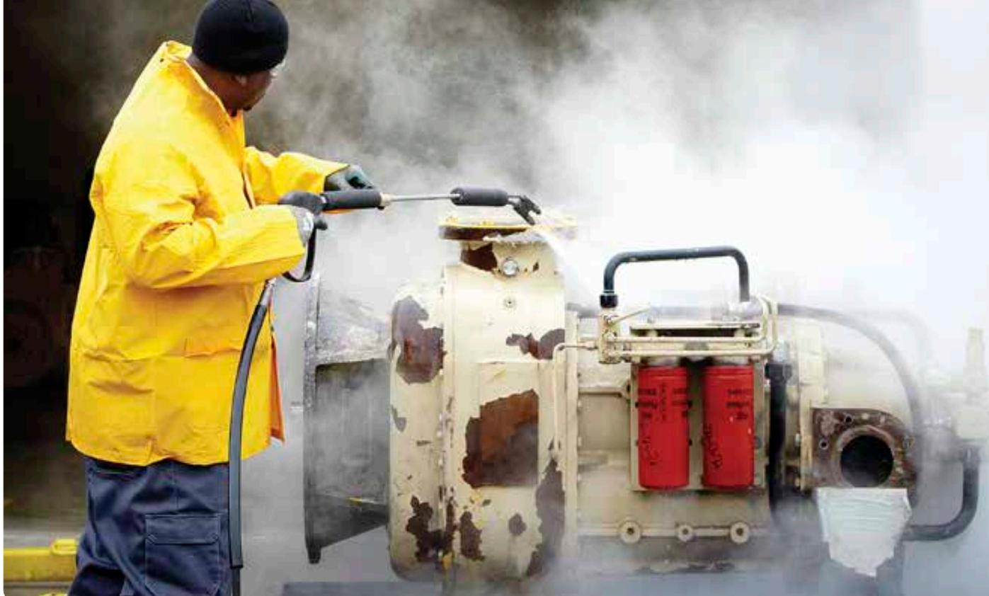
美国的再制造：在通过5个再制造车间之前，需要先清洗所有的零部件。加兰开发出的工艺流程为阿特拉斯•科普柯公司在全球范围内的再制造中心提供了参考标准。
