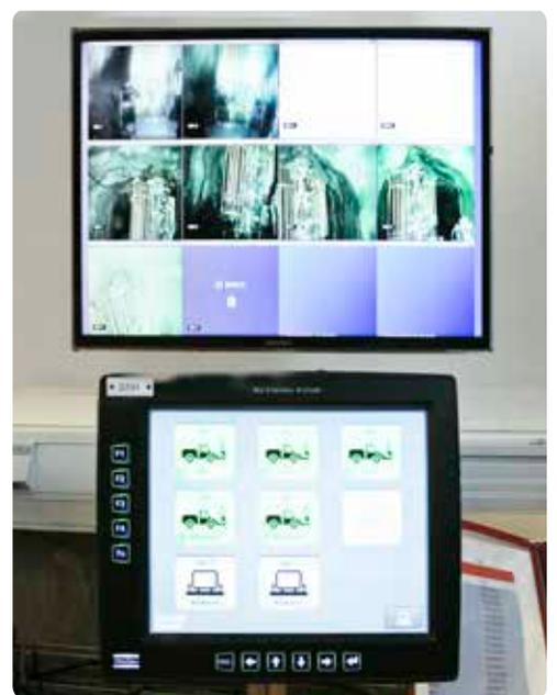
无线遥控技术: 上面左边为操作员控制台上显示的Simba WL6C台车的钻孔计划。右边为用于监视矿山各台车的工作进展的屏幕设置。
