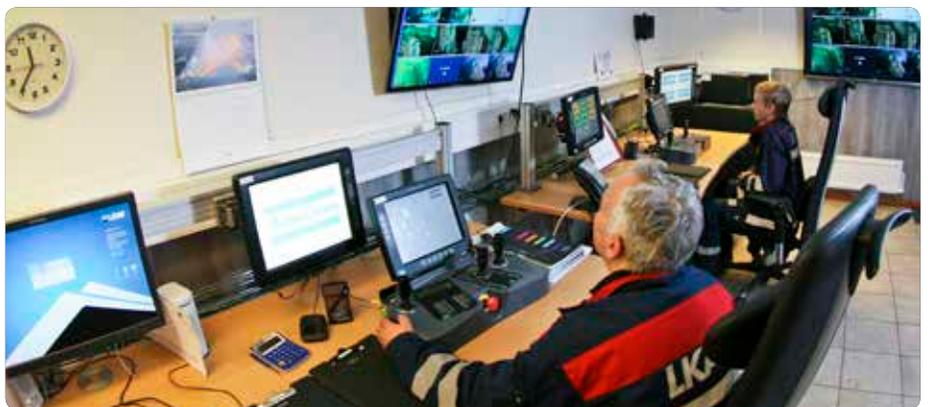
在安全距离外：Malmberget 矿山的控制室，每名操作员可以负责控制两台Simba钻机。生产主管Bengt Anttila在这里检查夜间的钻井数据记录。
