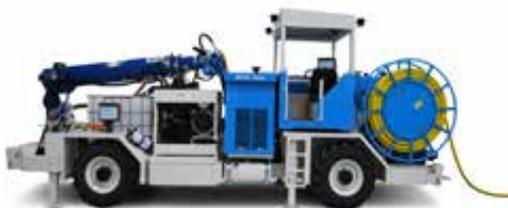
Versa: 结构紧凑且具备通用性，在狭窄隧道、联络通道和弯曲平巷中可自由移动。
