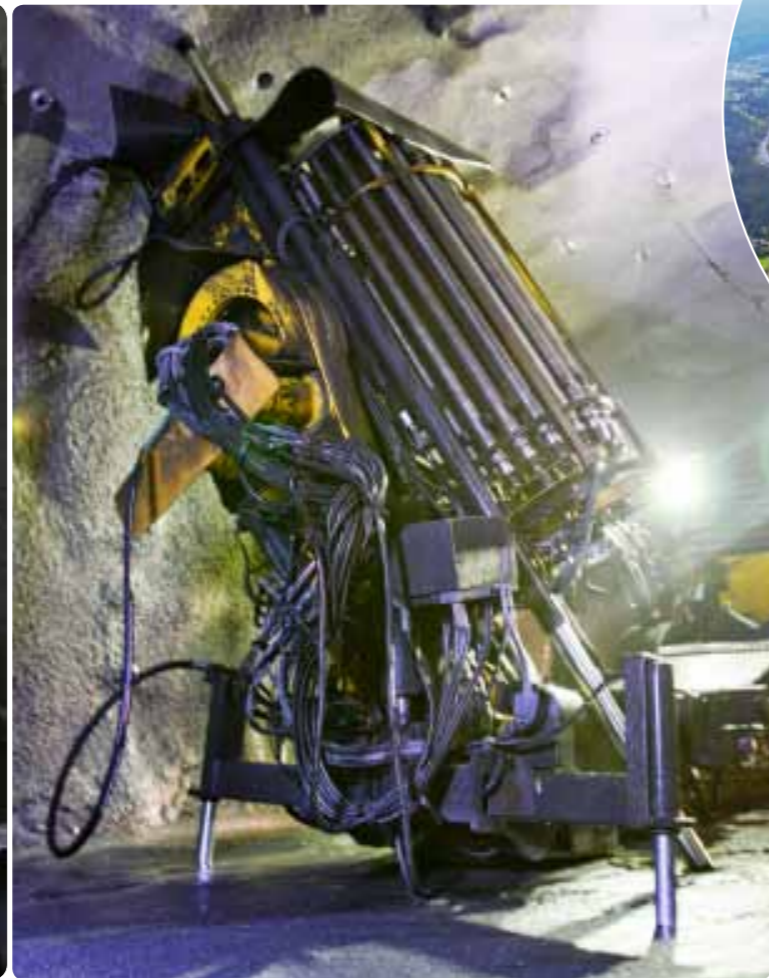
Вверху: оператор Андреас Ларссон во время одного из редких выходов в выработку для перемещения станка к следующему вееру взрывных скважин. Справа: Simba WL6 C на бурении полного веера, глубина в центре 30 м и 17 м по бокам.
