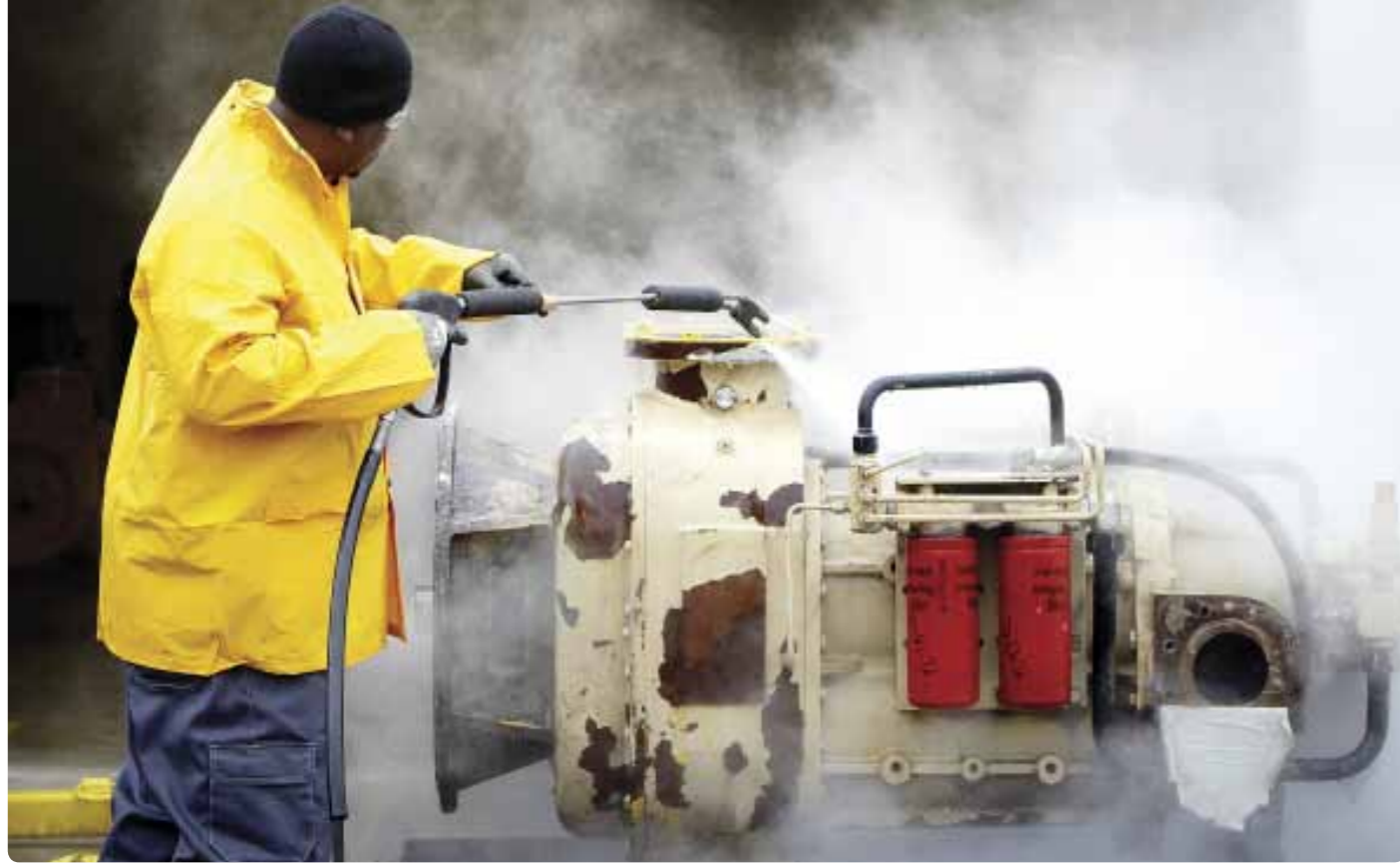
Модернизация в США: работа начинается с очистки всех компонентов перед их прохождением по пяти восстановительным цехам. Порядок работ и технология, разработанные в Гарланде, устанавливают стандарт для центров модернизации Atlas Copco во всех странах.
