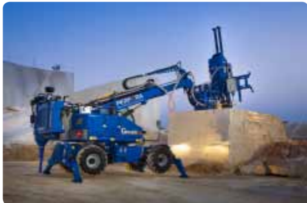
Тщательный выбор: станок Girodrill EVO на бурении мраморного блока в карьере Пиносо в Альгуэне. Вверху: управляющий карьером Хесус Перес де ла Мануэла (справа) и менеджер бизнес-направления продукции Atlas Copco Испания Фернандо Мендес.
