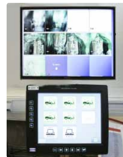
Телекоммуникационная технология: слева вверху – буровые планы для станков Simba WL6 C на панели оператора. Справа – экранная программа установок мониторинга бурения каждым станком в руднике.
