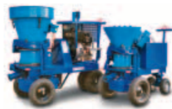
Piccola: предназначена для перемешивания вращением сухой смеси торкретбетона.
