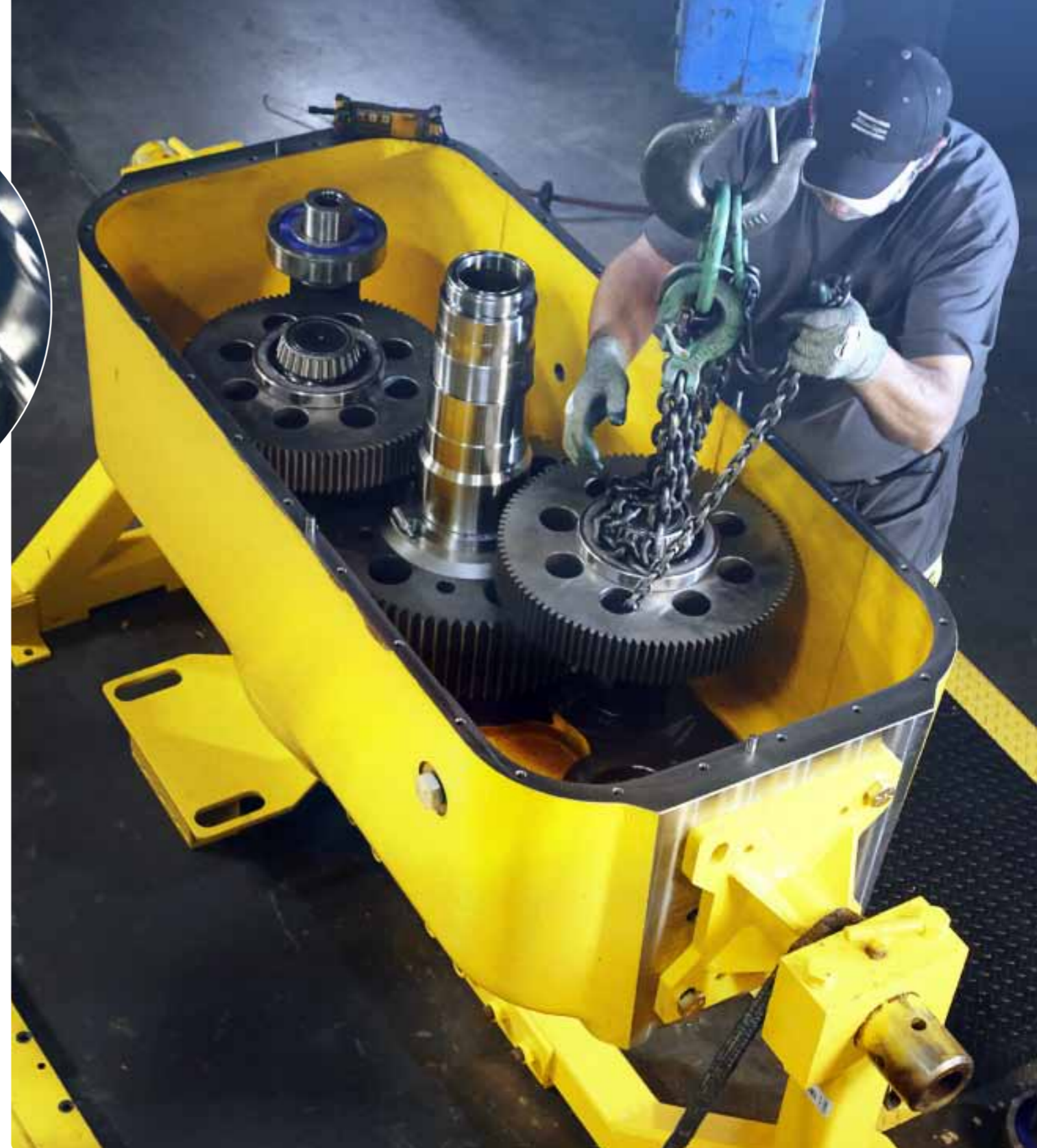
Модернизация: вращатель от бурового станка Pit Viper 351 будет полностью восстановлен и собран заново с использованием новых подлинных частей и самых современных технических спецификаций плюс заводские усовершенствования.
