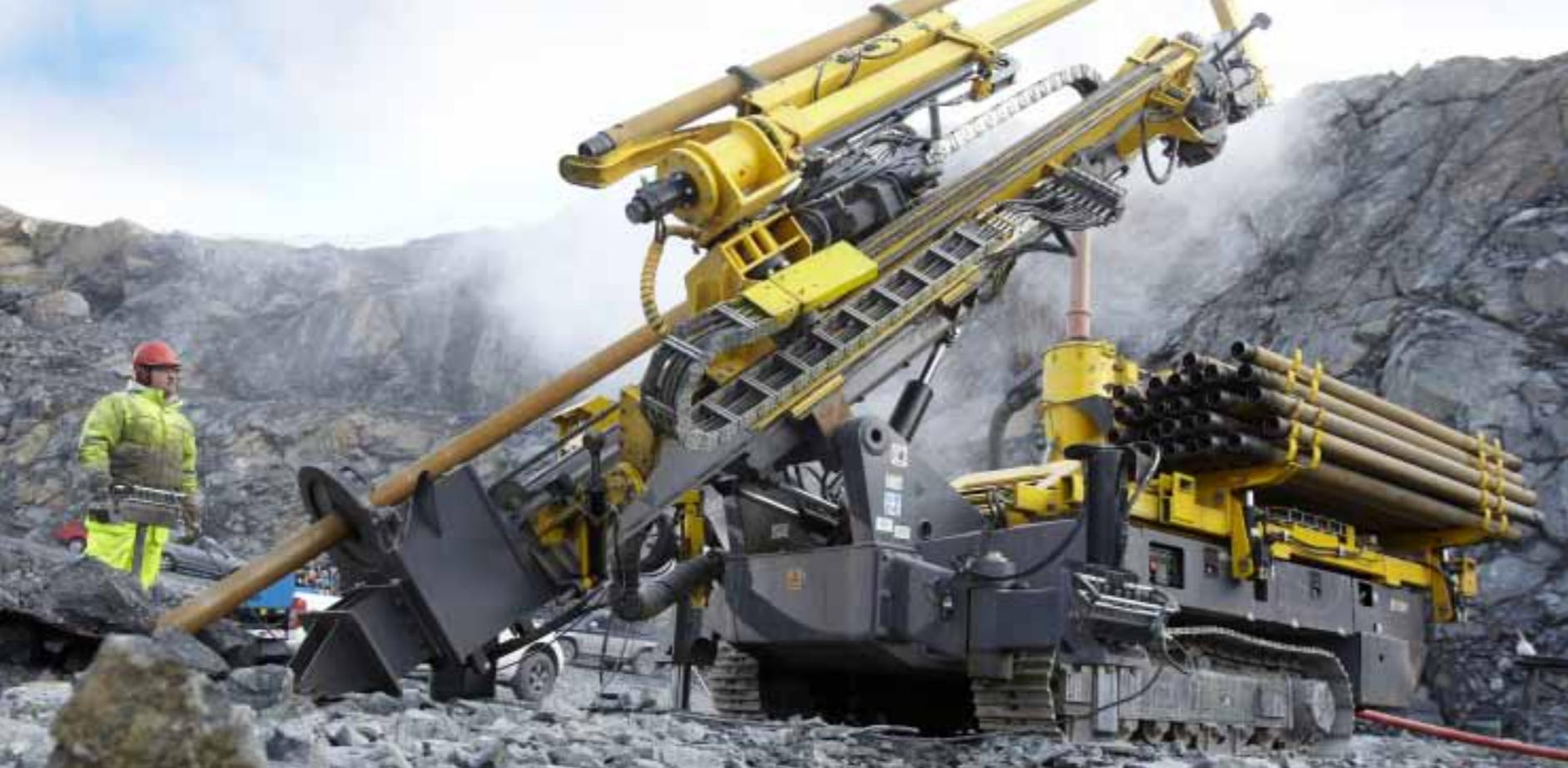
Компактный, но мощный: новый Exprologas 100 ведет бурение методом обратной циркуляции на крупнейшем золотом руднике Северной Европы Бьоркдальсгруван. Благодаря автоматизированной системе наращивания/разборки штанг и панели дистанционного управления работа бурильщиков безопасна.
