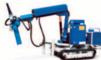
Oruga FBS: мобильный манипулятор для механизированного и автоматизированного набрызга бетона.
