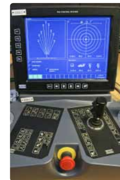
Телекоммуникационная технология: слева вверху – буровые планы для станков Simba WL6 C на панели оператора. Справа – экранная программа установок мониторинга бурения каждым станком в руднике.
