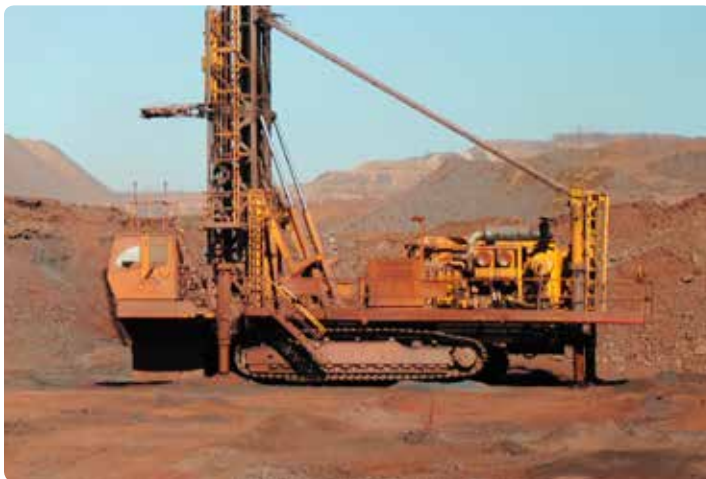
南アフリカ鉄鉱山のベンチにて:クンバ鉄鉱山で活躍するPit Viper 351 ロータリードリルリグ(左)とキング鉱山でのPit Viper 271(右)
