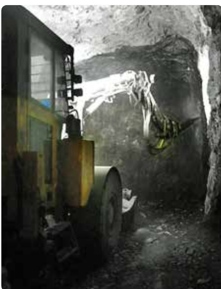
安全な選択:タラ鉱山ではスケールテックが日常のスケーリング作業に使われています。
