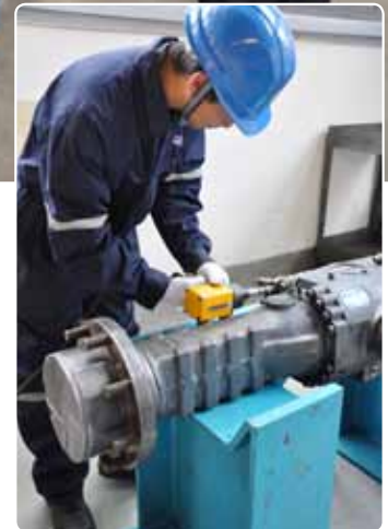
Aquí, el eje de un equipo de perforación Boomer es desmontado para su inspección.
