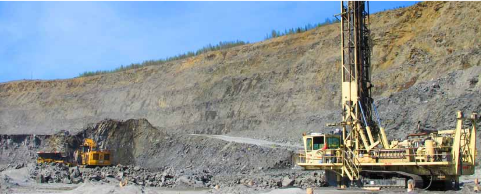
Para roca extraordinariamente dura: Una cantidad de equipos Pit Viper 275 multi-pass de Atlas Copco también son usados en los pits y la mina recientemente recibió otro que será usado en lugares donde la roca es excepcionalmente dura.
