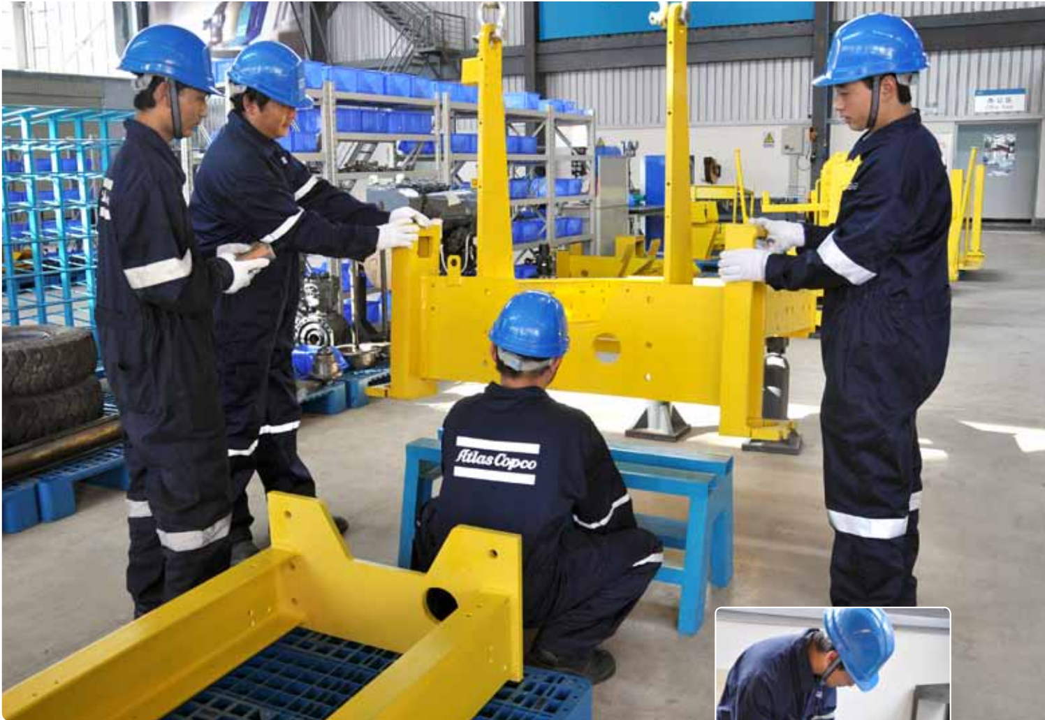
Técnicos del Centro Reman de Kunming armando la estructura principal de un equipo Boomer 281.
