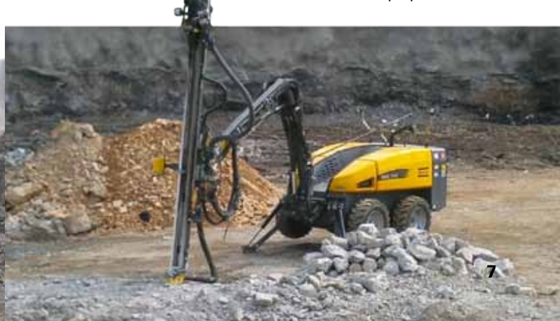
...y perforación de pequeñas dimensiones con el FlexiROCT15 multipropósito.
