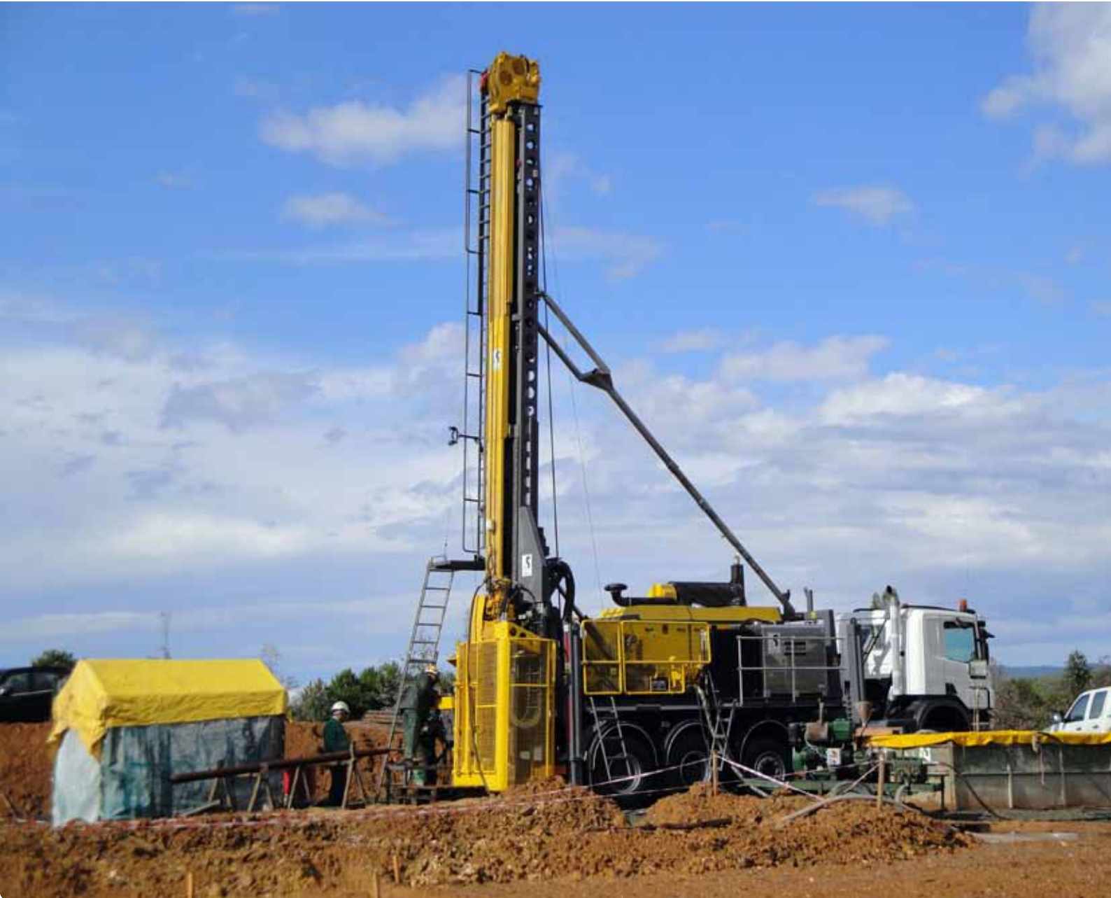
El equipo de exploración Christensen CT20 de Atlas Copco: Inicialmente, el equipo no se desempeñó en su mejor nivel en la mina Río Tinto en el sur de España, pero después de cambiar los parámetros de perforación y con entrenamiento extra del personal, los resultados superaron las expectativas.
