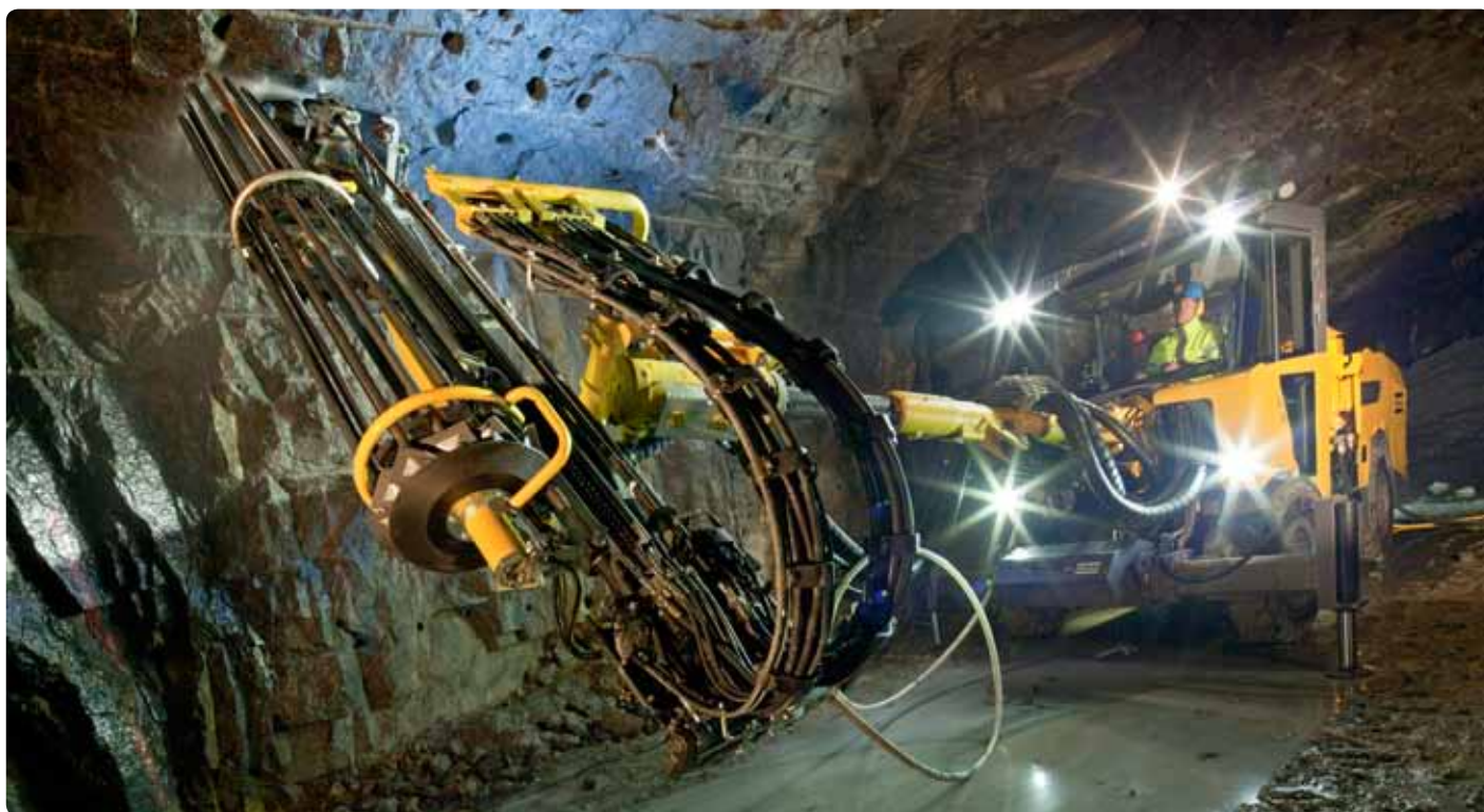
El nuevo Boltec S para túneles y galerías estrechos: Puede ser utilizado para la instalación segura de pernos de 1,5 a 2,4 m de longitud.
