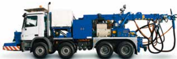
Roadrunner: 一般道を走行できる湿式コンクリート吹付装置
