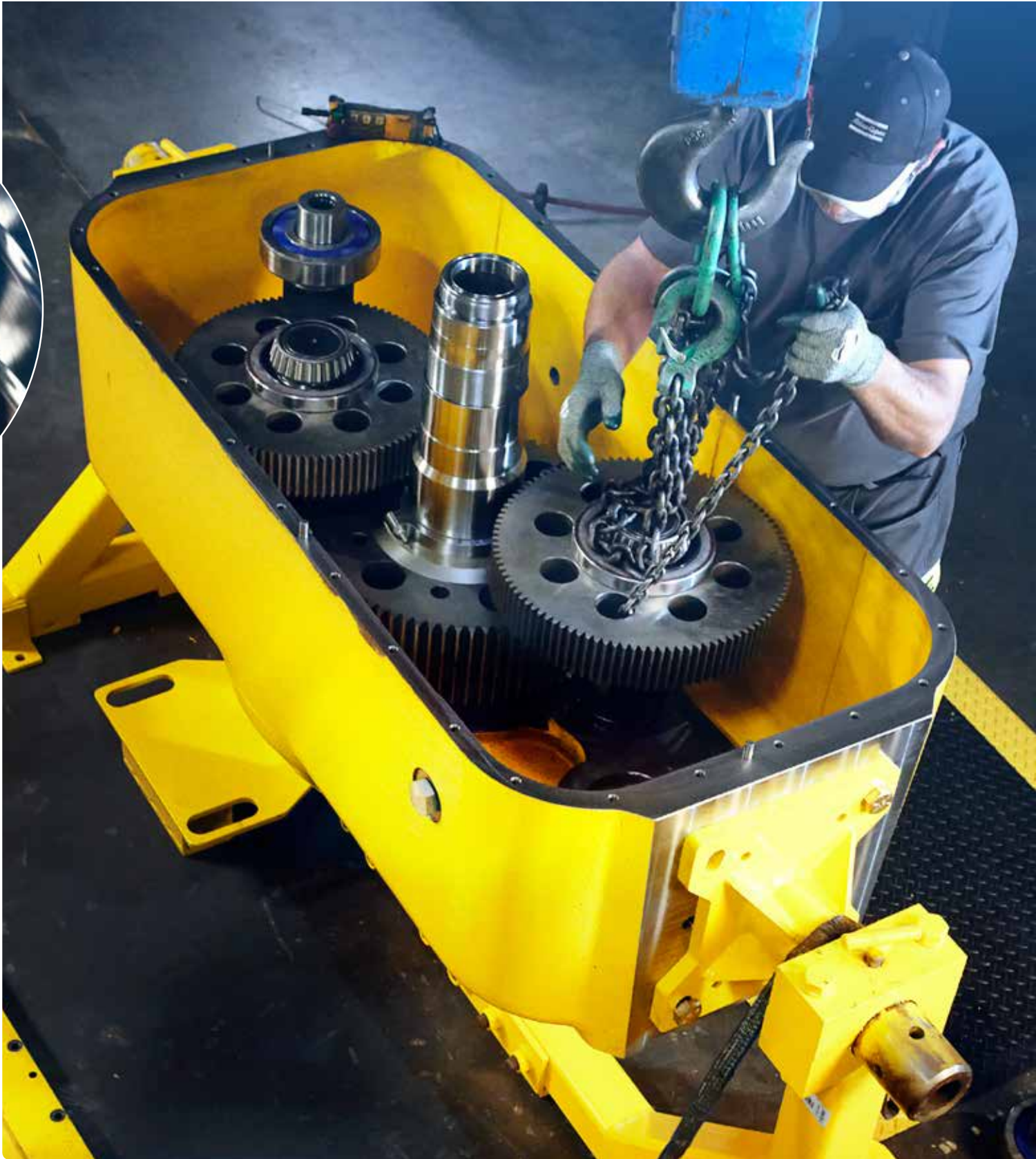
再生中:Pit Viper 351のロータリヘッドは、純正部品と最新の技術によりアップグレードされ、生まれ変わります。
