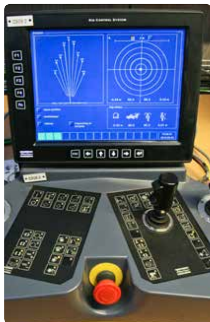
遠隔操作技術:左上、オペレータのディスプレイに表示されたSimba WL6 C リグのせん孔パターン。右、ディスプレイの全リグ表示。リグごとに作業の進捗をモニターします。
