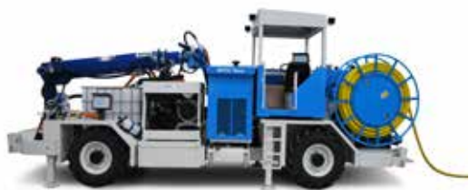
Versa: 狭いトンネル、通路の交差箇所、曲がりくねった坑道など、場所を選ばずにコンパクトで多目的な使用が可能な装置
