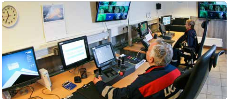
安全な距離を保って:マルムバージェット制御室ではオペレータ1人が2台のSimbaせん孔リグを担当しています。夜間のせん孔作業のデータをチェックしている、プロダクション部門スーパーバイザーのベント・アンティエーラさん
