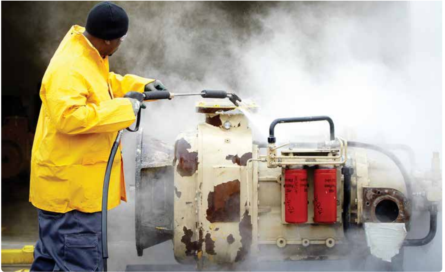
USAで再生中:全てのコンポーネントはクリーニングされた後、5段階の再生過程に運ばれていきます。ガーランドで設定された手順や規程は、世界各国のアトラスコプコ 再生サービスの基準になっています。
