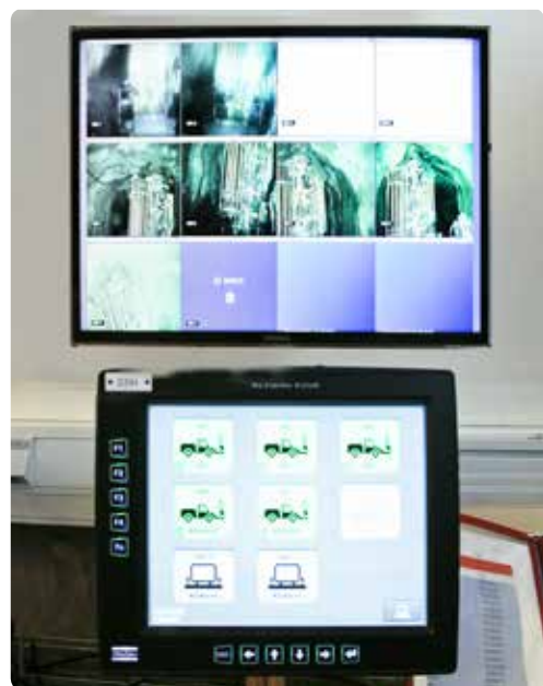
遠隔操作技術:左上、オペレータのディスプレイに表示されたSimba WL6 C リグのせん孔パターン。右、ディスプレイの全リグ表示。リグごとに作業の進捗をモニターします。
