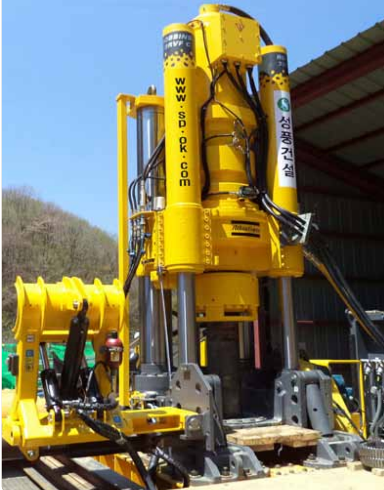
Sobre el túnel: Los ingenieros de Construcciones SungPoong ajustan la configuración del raiseborer Robbins de Atlas Copco.
