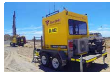
Disponible desde mediados de 2014: La estación BenchREMOTE permite al operador de equipos de perforación de superficie en obras potencialmente peligrosas controlar el equipo desde una distancia segura de hasta 100 m.
