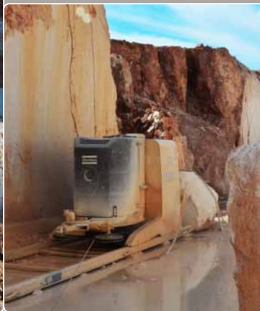
Abajo: La máquina es fácil de configurar y las vías se pueden levantar junto con la máquina.
