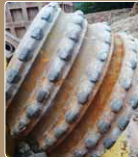
Alta calidad y larga vida: Izquierda, el cortador Magnum G y el cortador Magnum N (derecha) después de escariar la chimenea de 307 m.
