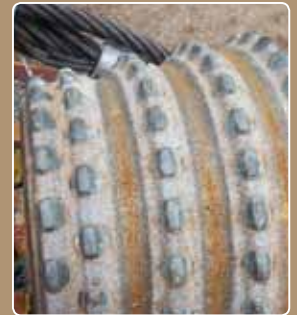
Alta calidad y larga vida: Izquierda, el cortador Magnum G y el cortador Magnum N (derecha) después de escariar la chimenea de 307 m.
