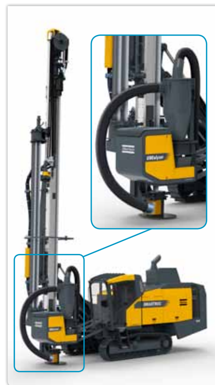
¿Qué hay en el banco? El OREalyzer, montado aquí en el SmartROC D65 (recuadro), da respuestas mientras se está perforando.
