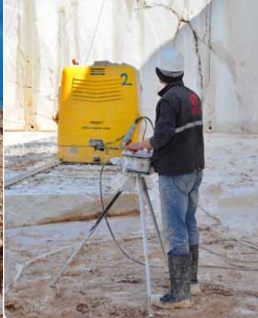
Arriba: La rápida y segura SpeedCut operada por control remoto.
