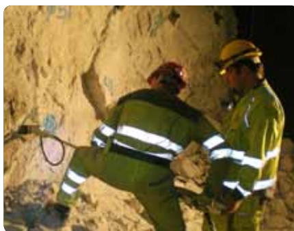
Buena tracción: Las pruebas con el Swellex Spartan mostraron un alargamiento del perno de 6%.
