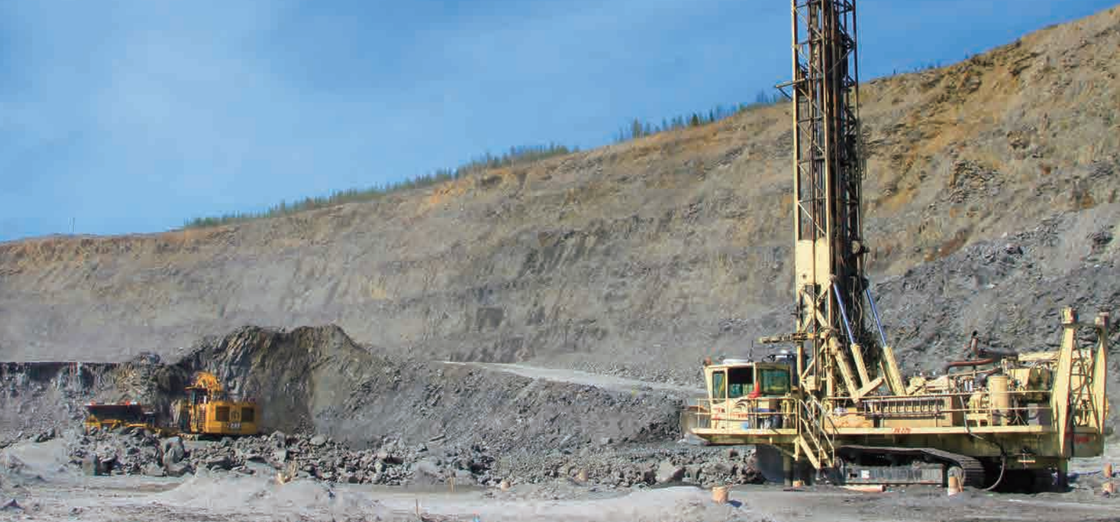
硬い岩盤に挑む現場ではPit Viper 275マルチパスドリルリグ数台も活躍していますが、特に超硬質な岩盤用のせん孔に、さらに追加で1台が最近搬入されました。
