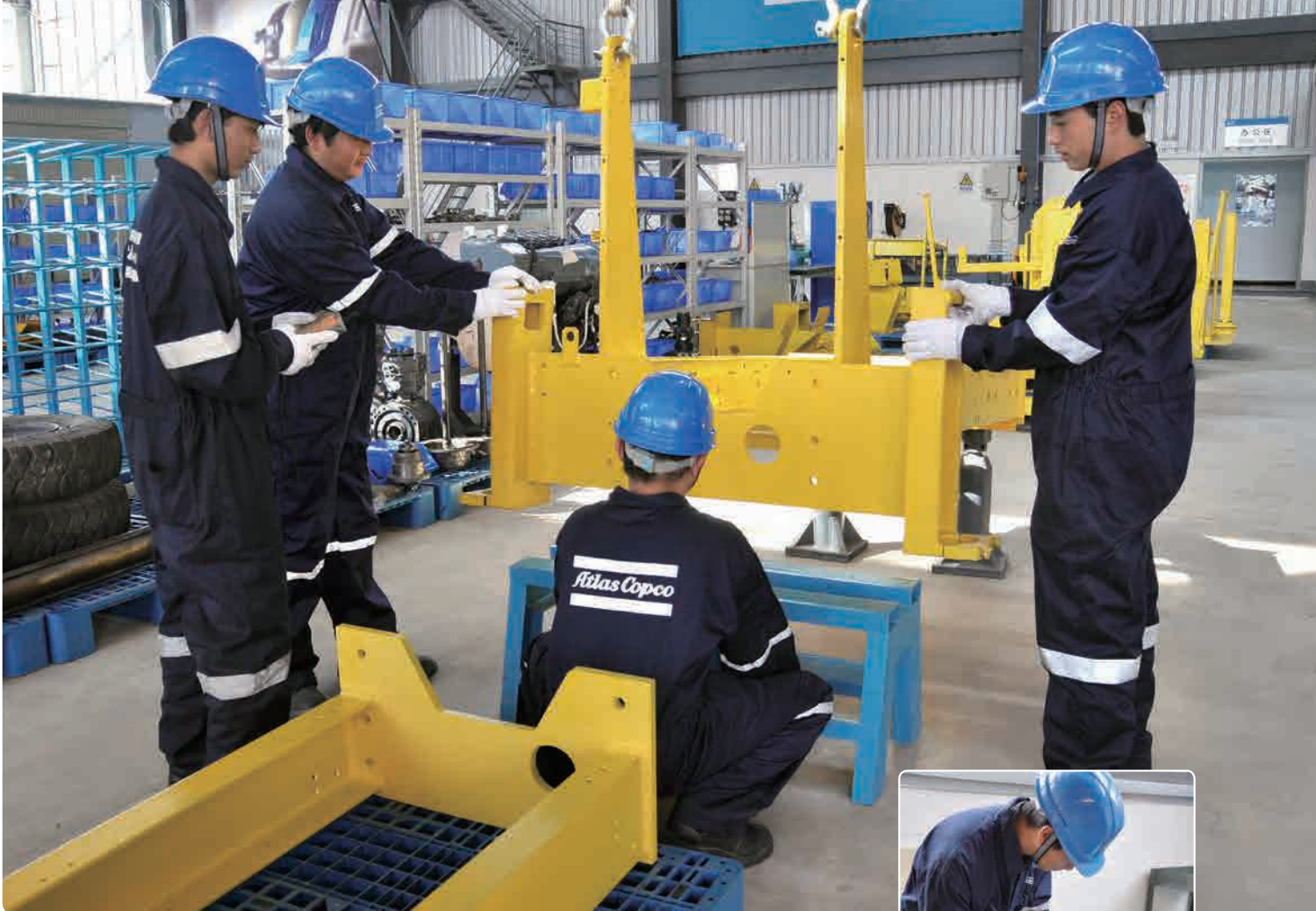
Boomer 281切羽掘削リグの主台枠を組み立てる昆明再生センターの技術者たち
