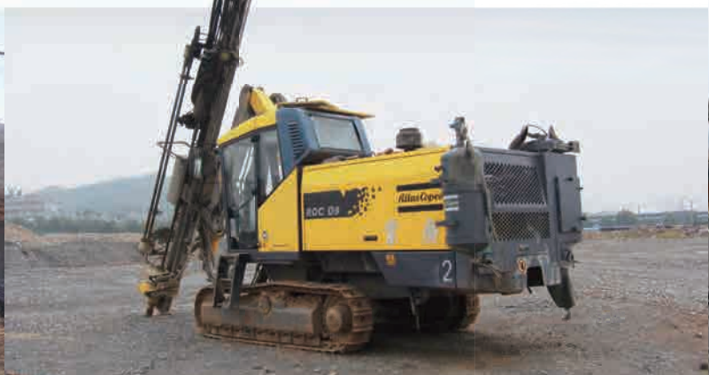
石灰石骨材をさく孔する トップハンマードリル FlexiROC T40 (旧 ROC D9)
