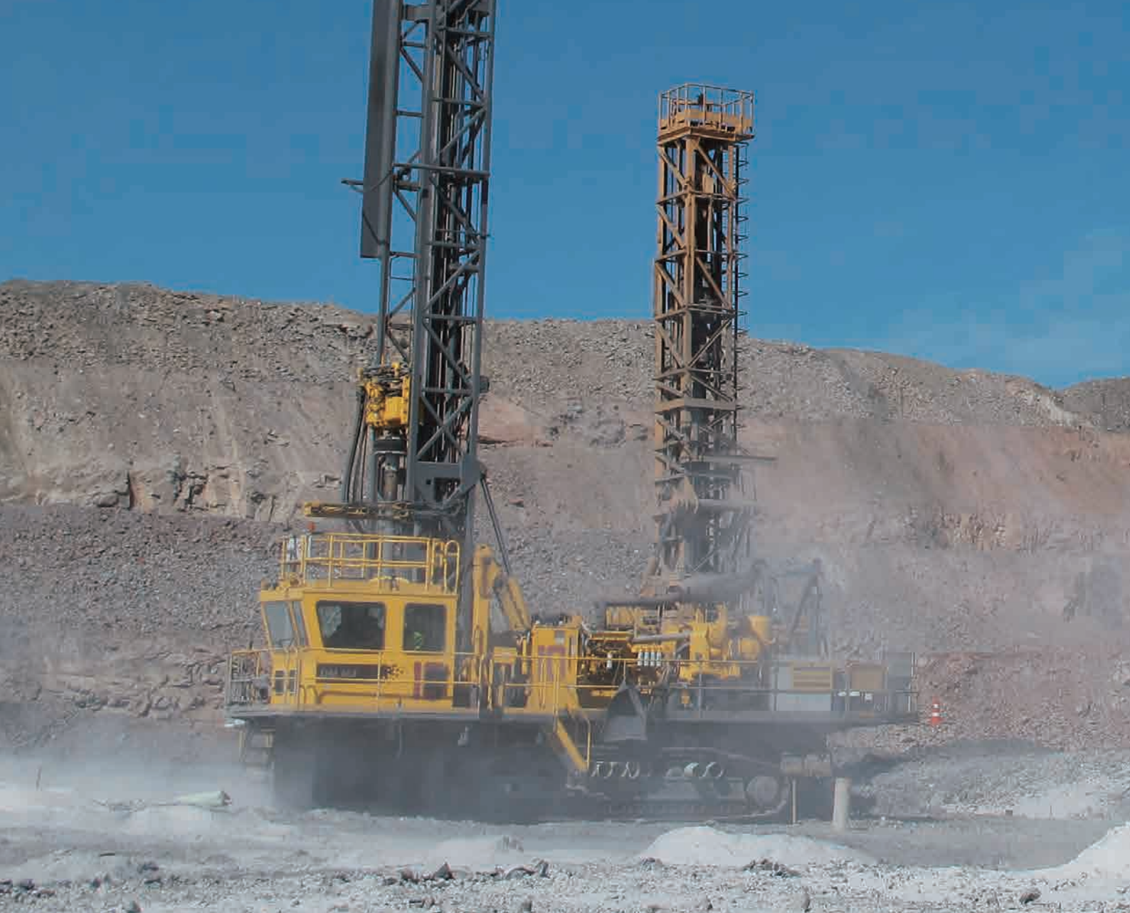
シングルバードリルからマルチバードリルまで:2012年に鉱山に導入されたDM-M3はシングルバードリルで12m長のせん孔を行えますが、鉱山では2本の12.2m長のパイプを使い、21m長孔のマルチバードリルに使用しています。
