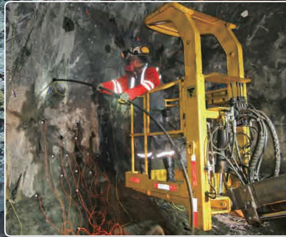
最新の装薬技術・新型Chargetec UV2 はプンタ・デルコブレ銅鉱山で高い場所の作業にも使われています。
