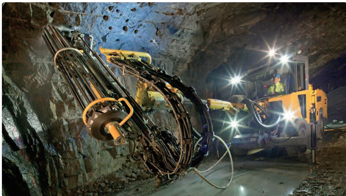
小断面のトンネル及び坑道用新型Boltec S:長さ1.5m～2.4mのボルトを打設します。
