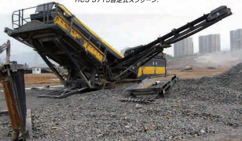
骨材を篩い分けるコンパクトなHCS 3715自走式スクリーン。
