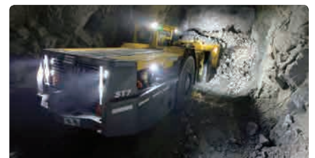
スクープトラム ST7:Cummins Tier 4iエンジン搭載のアトラスコプコのローダーです。
