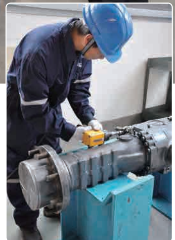
点検のため解体作業中のBoomer切羽掘削リグの走行装置
