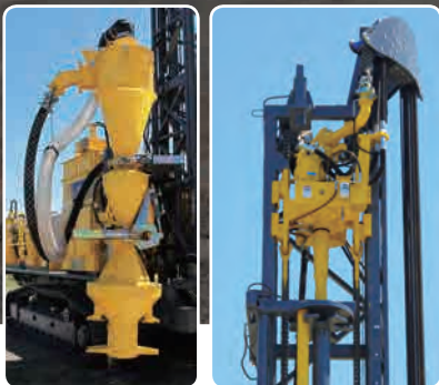
サイクロンサンプリングシステム(左写真)、 ロータリーヘッド変換とホーストレイ(右写真)はRCキットの標準仕様です。
