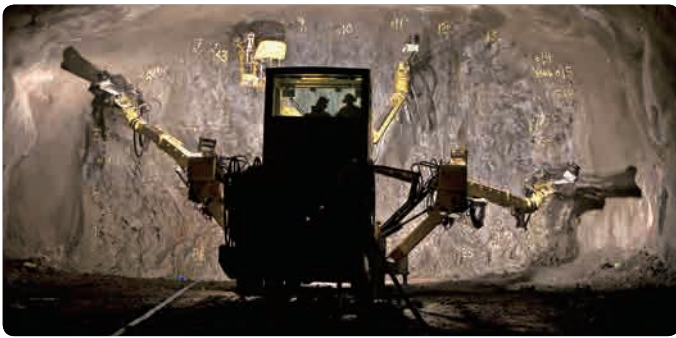
パワフルなチーム・トンネルジャンボBoomer XE3C 6台はノルウェーの新設道路鉄道トンネルプロジェクトで稼働中です。
