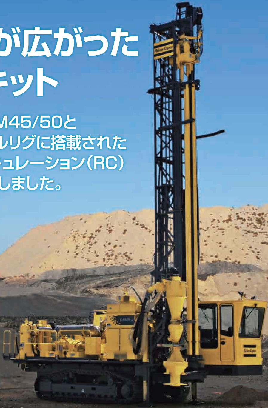
サイクロンサンプリングシステム(左写真)、 ロータリーヘッド変換とホーストレイ(右写真)はRCキットの標準仕様です。
