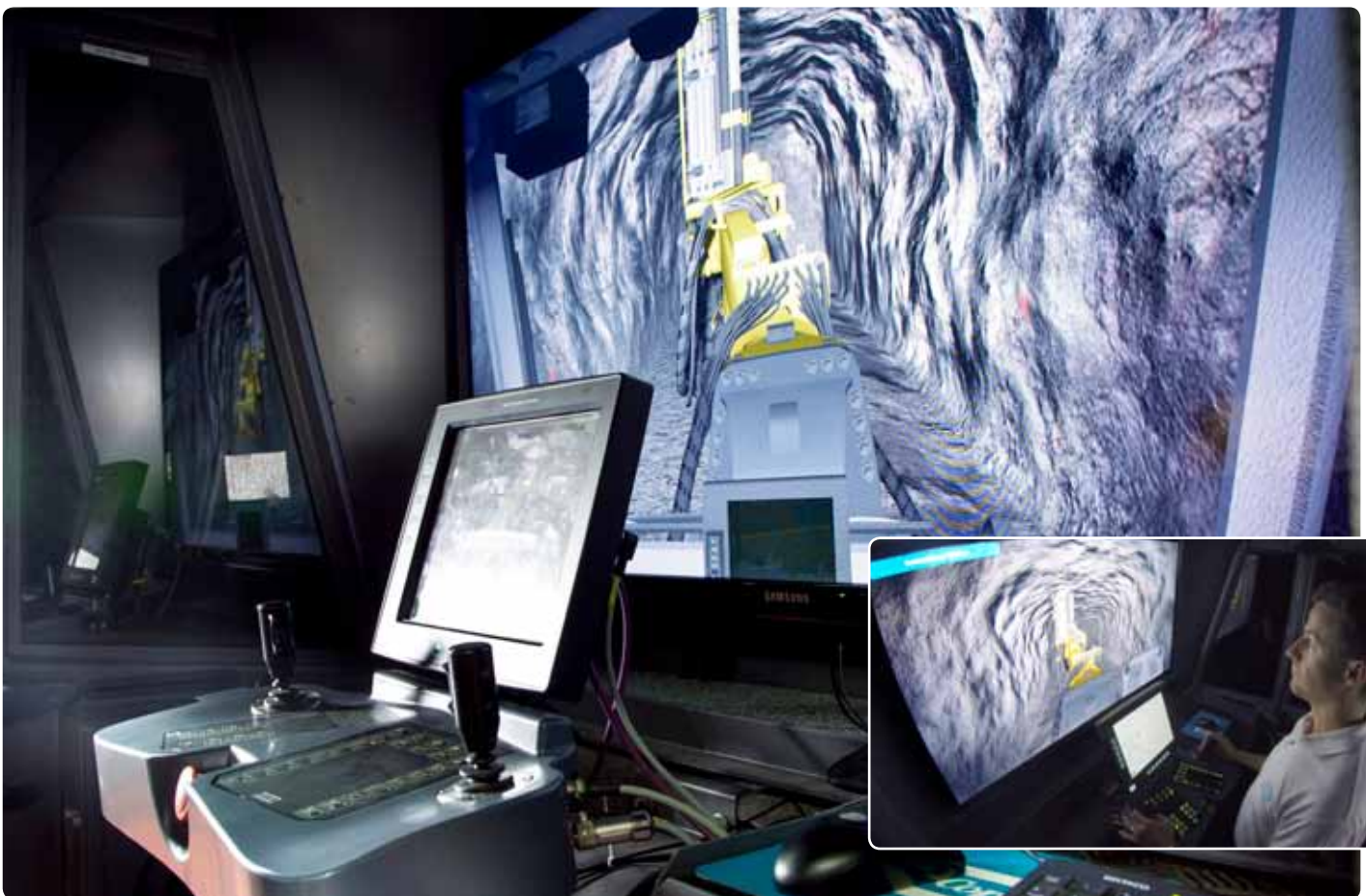
Dentro del simulador Simba: El panel de control del operador da exactamente la misma sensación que el del equipo, mientras que la posición de las ventanas delantera y trasera de “la cabina” como son presentadas en las pantallas, dan al aprendiz una experiencia extremadamente realista del ambiente de la mina.
