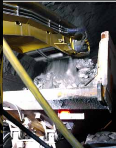
La retroexcavadora del Häggloader carga escombros en la cinta transportadora. Abajo, la cinta transportadora vuelca los escombros directamente en el camión que está esperando.
