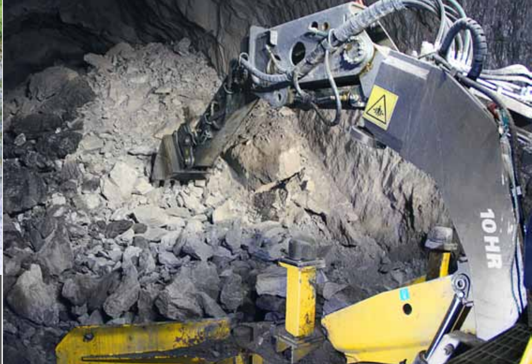
La retroexcavadora del Häggloader carga escombros en la cinta transportadora. Abajo, la cinta transportadora vuelca los escombros directamente en el camión que está esperando.
