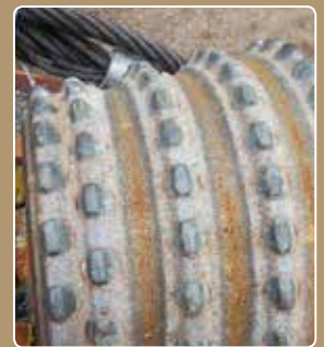
高い品質と長い寿命:307m立坑のリーミング作業を終えた Magnum cutter G(左)とMagnum cutter N(右)
