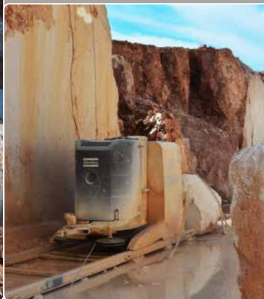
下:設置は簡単で、本体と一緒にレールも持ち上げられる
