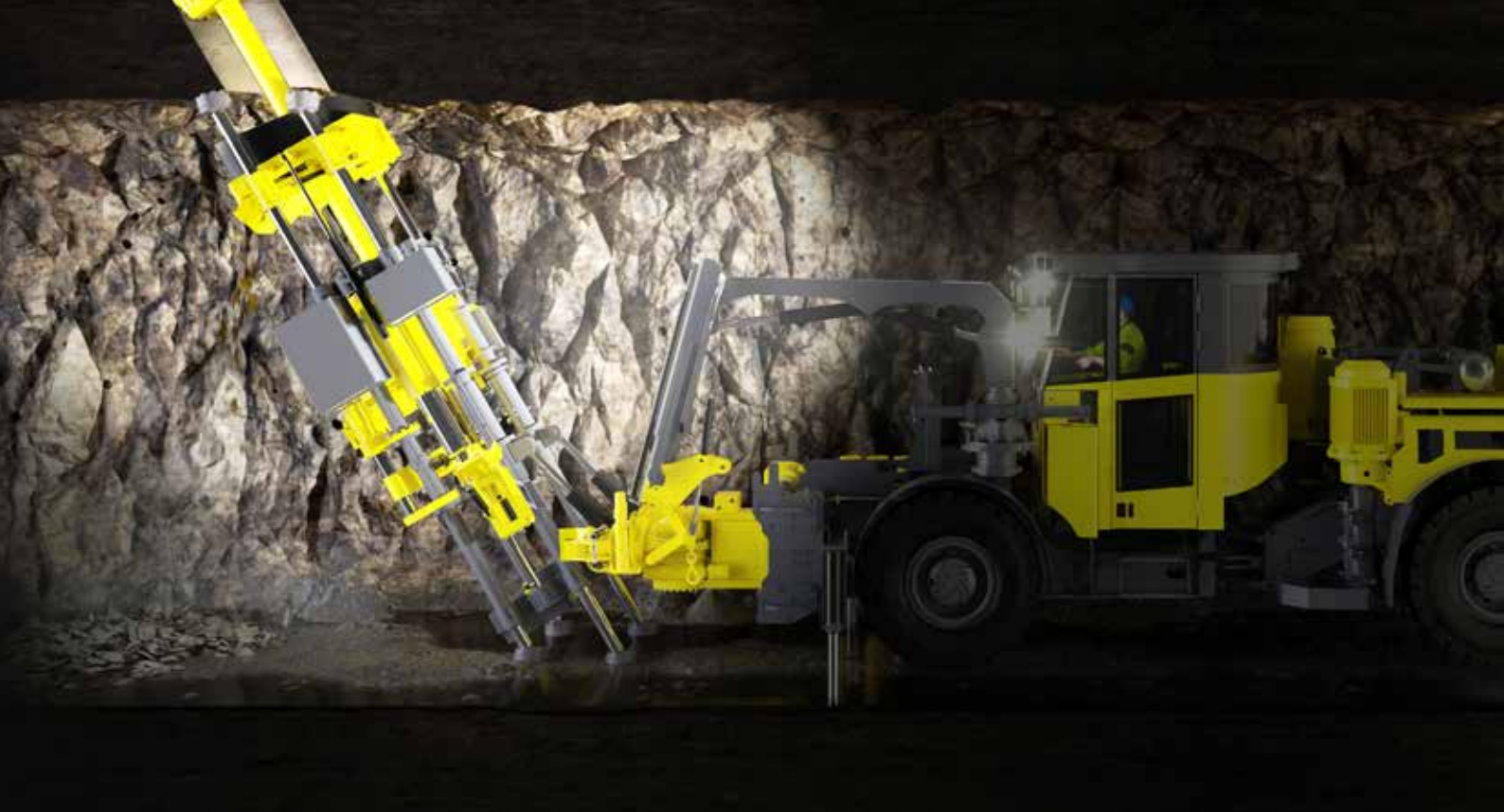
稼働中のイーザー：新型の自走式レイズボーラーが小口径の導入孔掘削用に開発されました。上部に4か所、下部に4か所あるシリンダースティンガーがリグを安定させます。
