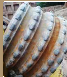
高い品質と長い寿命:307m立坑のリーミング作業を終えた Magnum cutter G(左)とMagnum cutter N(右)
