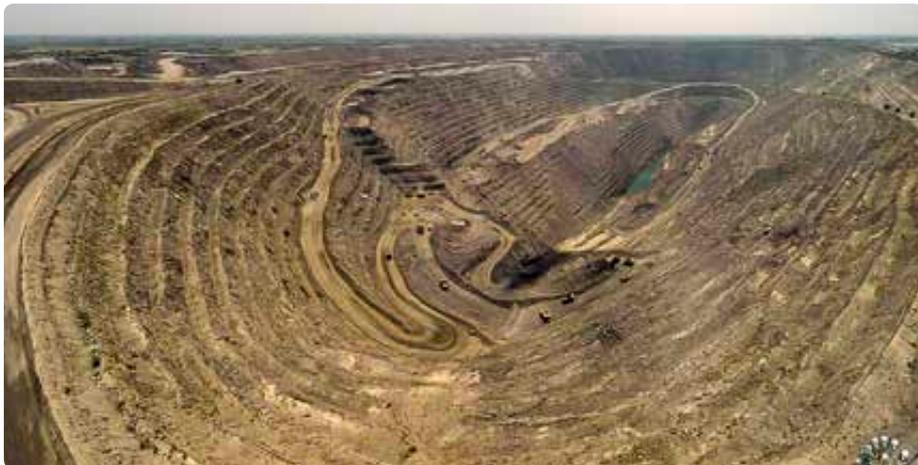
转入地下开采：在372米标高以下，采用地下采矿法继续开采Rampura Agucha矿床。该矿床拥有储量1亿吨，矿山服务年限为25年。
