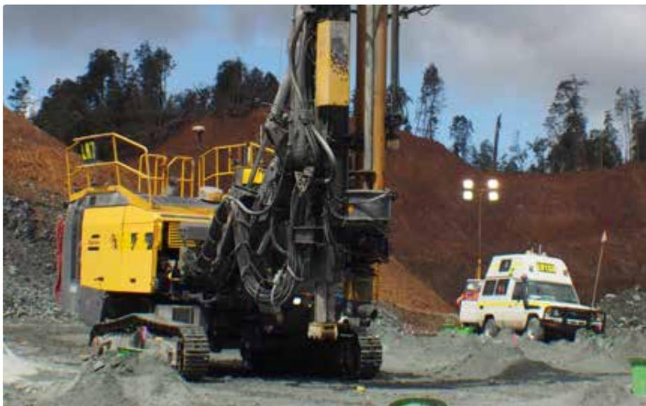
在塔斯马尼亚的萨维奇河矿，将安装在一辆汽车（右）内的BenchREMOTE工作站与阿特拉斯·科普柯SmartROC D65钻机配合使用可以测定台阶的稳定性。
