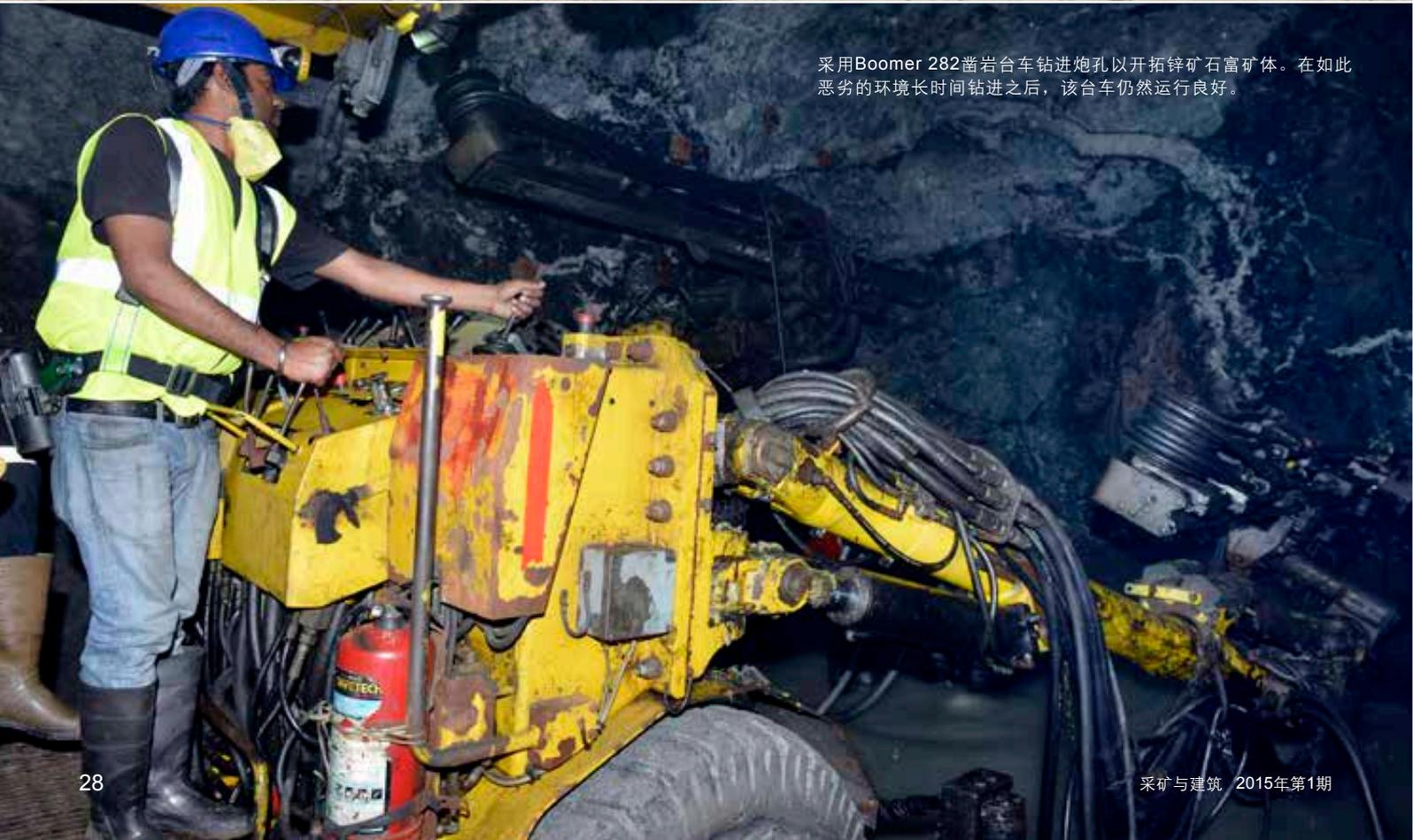
采用Boomer 282凿岩台车钻进炮孔以开拓锌矿石富矿体。在如此恶劣的环境长时间钻进之后，该台车仍然运行良好。
