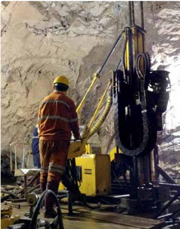
第一台破纪录的钻机：在5米×6米巷道内使用的Diamec U4钻机
