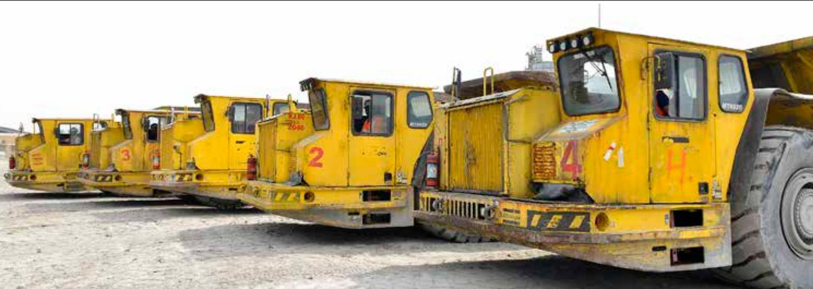
壮观的车队：印度斯坦锌业有限公司拥有一支庞大的阿特拉斯·科普柯矿用卡车车队。图中为在Rampura Agucha矿使用的部分车辆，主要为60吨级的Minetruck MT6020卡车。
