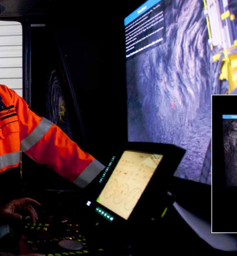
模拟器培训：在每一个阶段，学员在模拟器上学习各种凿岩程序。在模拟器上培训不会影响矿山的生产作业。
