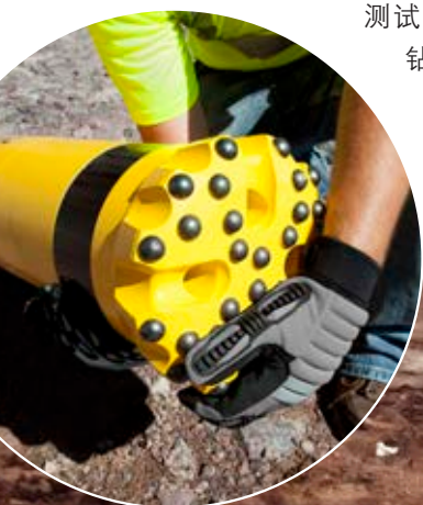
Secoroc COP 86重201千克，比以前的型号更轻，操作更容易和更安全。
