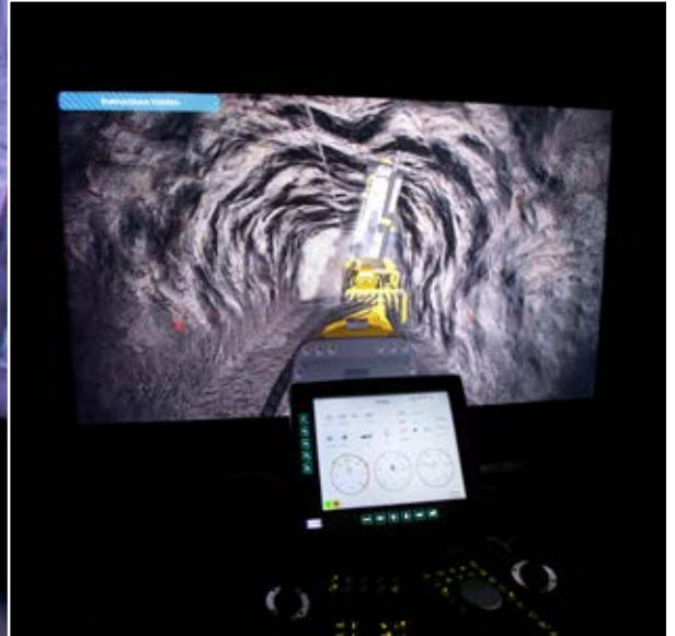
室内模拟画面：模拟Simba凿岩台车的采矿凿岩情景。
