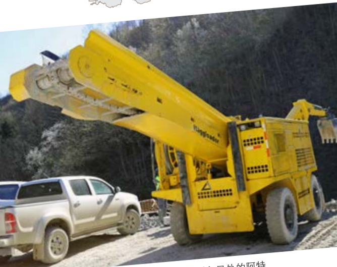
连续装载的关键设备：位于导流隧洞入口处的阿特拉斯·科普柯Haggloader扒装机。
