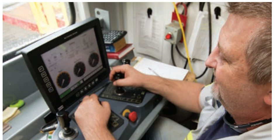
Raisebor公司操作员James Bass正在安静舒适环境中通过远程操作站控制Robbins123RH C天井钻机。
