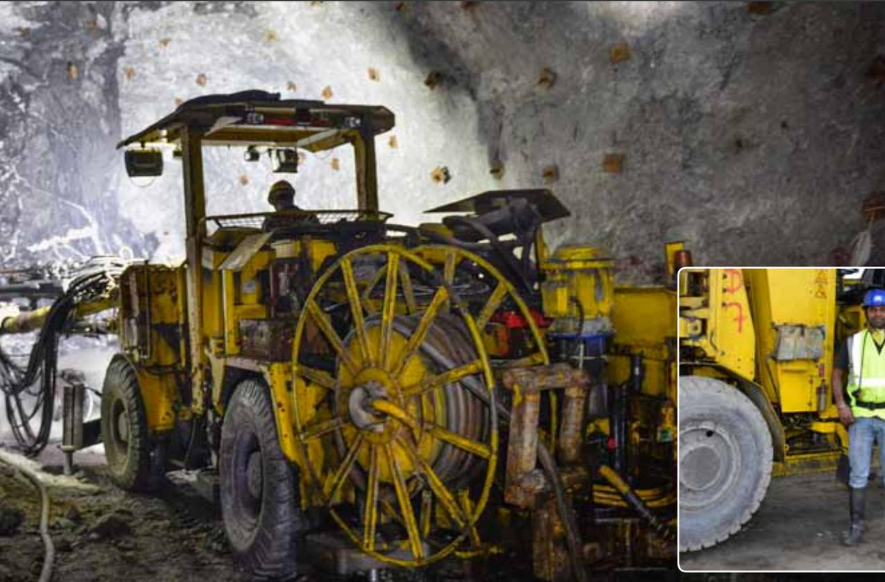
El Boomer 282 trabajando en el frente de la Mina Kayad. Todos los equipos están cubiertos por amplios contratos de servicio.
