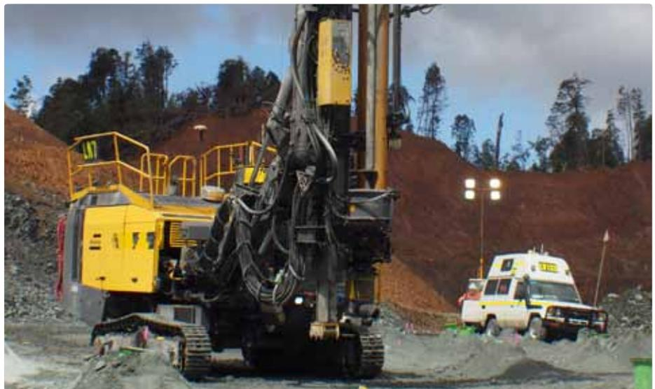
Quando la estabilidad del banco es dudosa: El Atlas Copco SmartROC D65, visto aquí junto a la unidad BenchREMOTE montada dentro de un vehículo (derecha) en la Mina Savage River en Tasmania.
